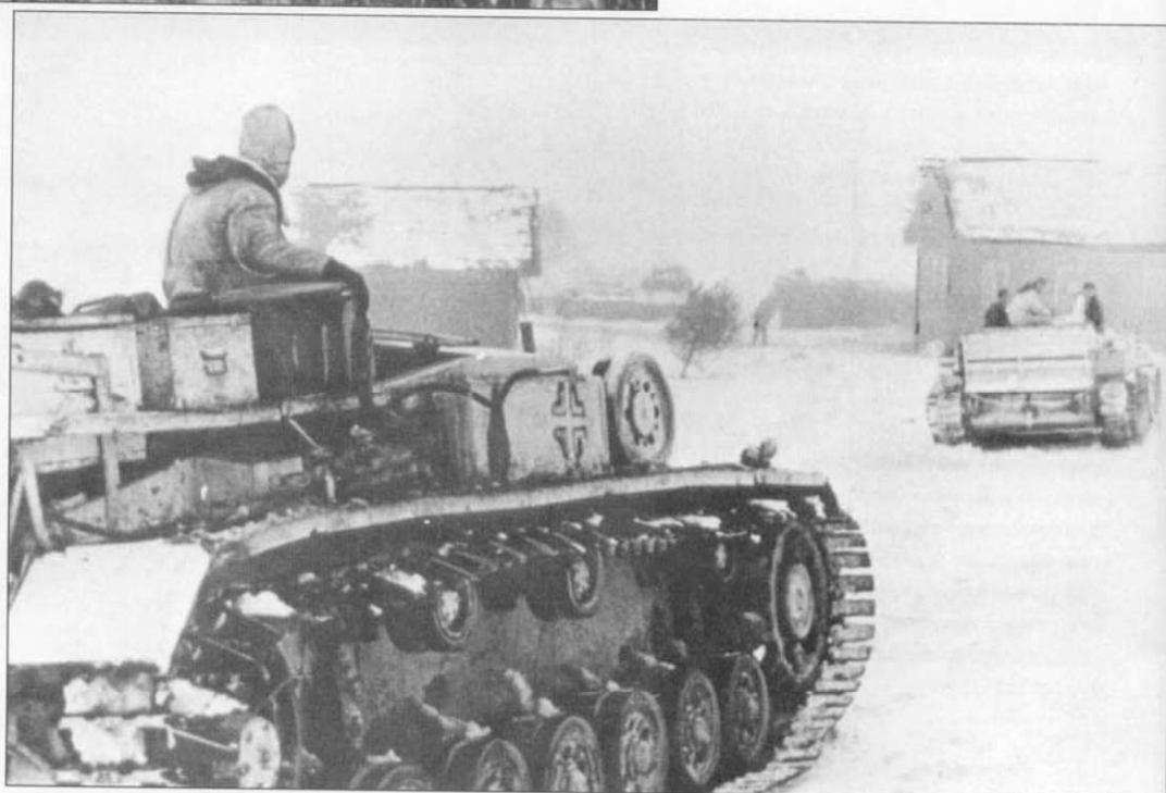
Штурмовые орудия StuG III, гусеницы самоходок оснащены расширителями "Ostketten" (восточные траки), снижающими удельное давление на грунт. Теоретически, Ostketten представляли собой удачное устройство, которое, однако, не пользовалось популярностью у танкистов. На твердых грунтах «расширители» гнулись и ломались.
