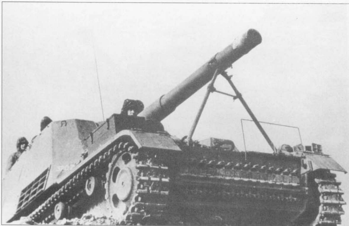
Самоходно-артиллерийская установка «Хуммель». На снимке — новая самоходка, так как отсутствует камуфляжная окраска, характерная для фронтовых машин, а на стенке рубки виден написанный белой краской заводской номер шасси. Самоходка имеет однотонную темно-зеленую окраску. САУ «Хуммель» представляла собой сочетание танкового шасси от Pz.Kpfw. III/IV и пушки 15 cm s.FH-18/1.
