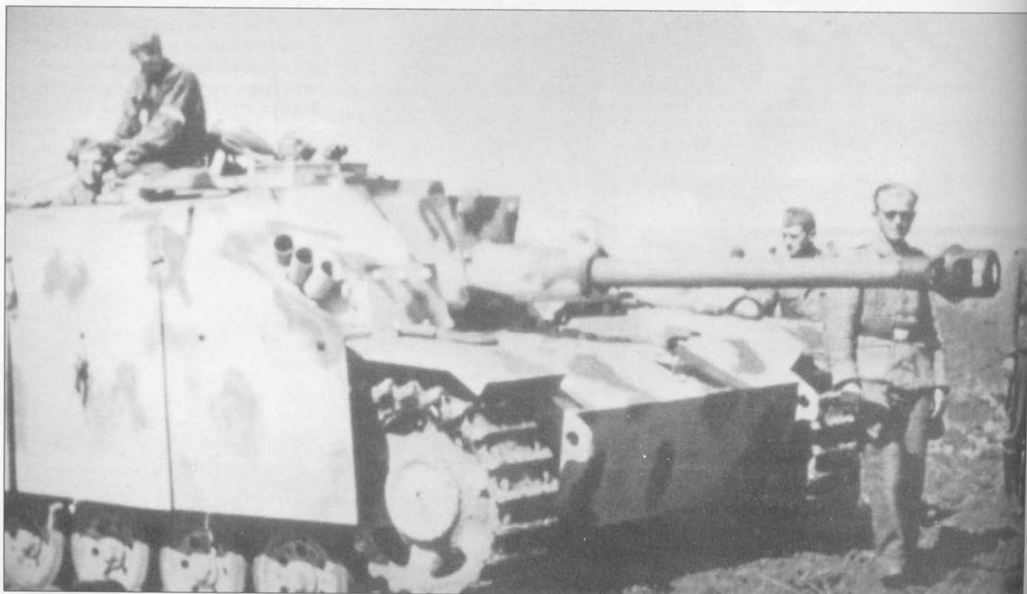
Штурмовое орудие StuG III Ausf. G, снимок сделан в тыловой обстановке – экипаж расслабился. С декабря 1942 г. и до окончания войны было построено 7720 StuG III Ausf. G, еще 173 машины переделали в Ausf.G в 1944 г. из танков Pz.Kpfw. III.
