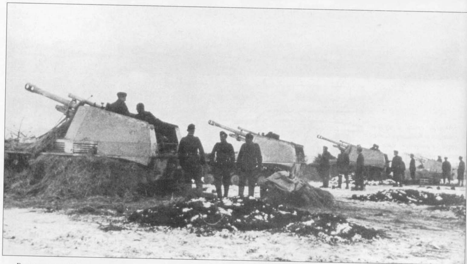
Батарея легких 105-мм самоходно-артиллерийских установок «Веспе» на огневой позиции. САУ «Веспе» также имела слишком тесное боевое отделение. На снимке хорошо видно, что трое из пяти человек расчета при ведении стрельбы находятся вне машины. Возимый боекомплект САУ «Веспе» был вдвое больше по сравнению с «Хуммелем».
