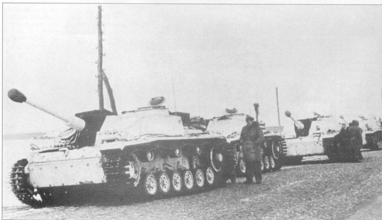
Батарея штурмовых орудий StuG III Ausf. G. Самоходки окрашены в белый цвет и оснащены траками Ostketten. Отсутствие какой бы то ни было маркировки позволяет предположить, что машины недавно покинули заводской цех.
