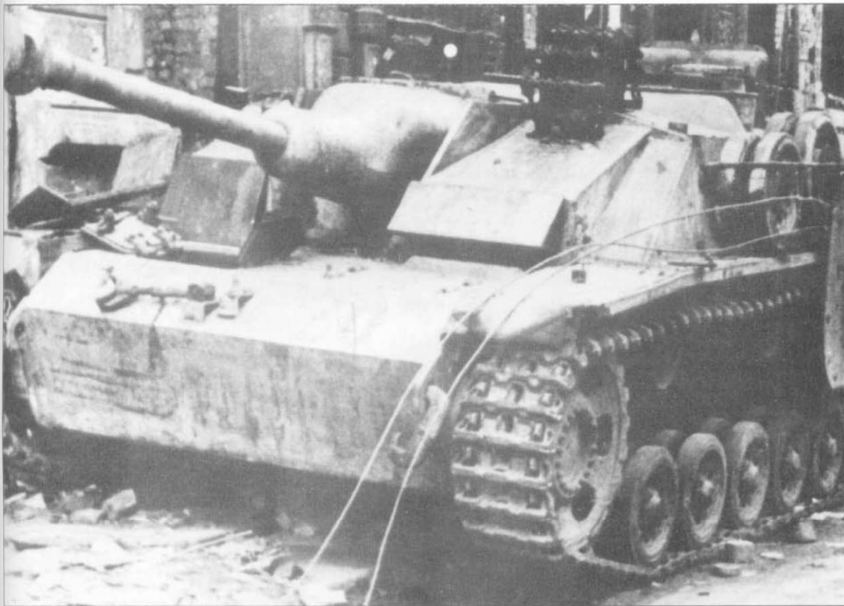
Брошенное штурмовое орудие StuG III Ausf. G, Познань. Ролики не имеют резиновых бандажей, на орудии установлена макса типа «свиное рыло». Необычен тактический номер «20», написанный на лобовом бронелисте корпуса.
