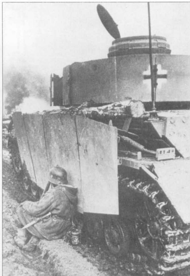
В ожидании приказа: усталый пехотинец привалился к бортовому экрану танка Pz.Kpfw. IV. Обратите внимание – на танке нет тактических номеров, машина окрашена в темно-желтый цвет, камуфляж не нанесен.
