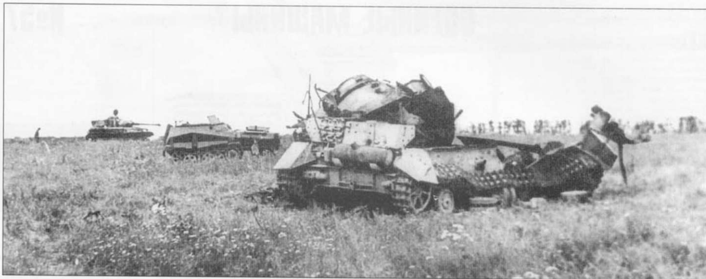
Развороченный прямым попаданием танк Pz.Kpfw. IV и подбитый полугусеничный бронетранспортер Sd.Kfz. 250, на заднем плане – еще один подбитый Pz.Kpfw. IV, район Орла, август 1943 г. Танк на переднем плане сильно пострадал от внутреннего взрыва – сдетонировал боекомплект. С машины сорвана вся верхняя часть корпуса вместе с башней.
