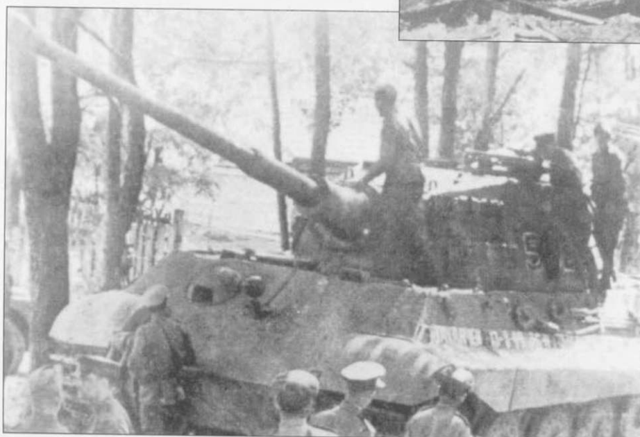
Конец карьеры «Королевского тигра». Снимок танка «Тигр II» Ausf. В с башней фирмы Хеншель сделан в апреле 1945 г. на Фришской косе. Орудие 8.8 ст KwK-43 L/71 вероятно было лучшей танковой пушкой периода Второй мировой войны. «Тигр II» появился слишком поздно, чтобы повлиять на исход войны.
