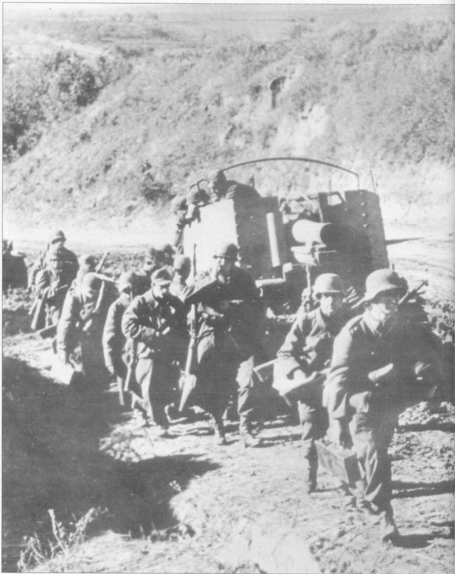
На снимке тяжелая самоходно-артиллерийская установка Sd.Kfz. 138/1 «Грилле», на Восточном фронте эти самоходки встречались крайне редко. Машина представляла собой шасси танка Pz.Kpfw. 38(t) с установленной на нем пушкой 15 см sIG-33. С первых месяцев по осень 1943 г. было изготовлено около 100 САУ Sd.Kfz. 138/1 «Грилле». Самоходки «Грилле» состояли на вооружении артиллерийских подразделений пехотных полков панцердивизий.
