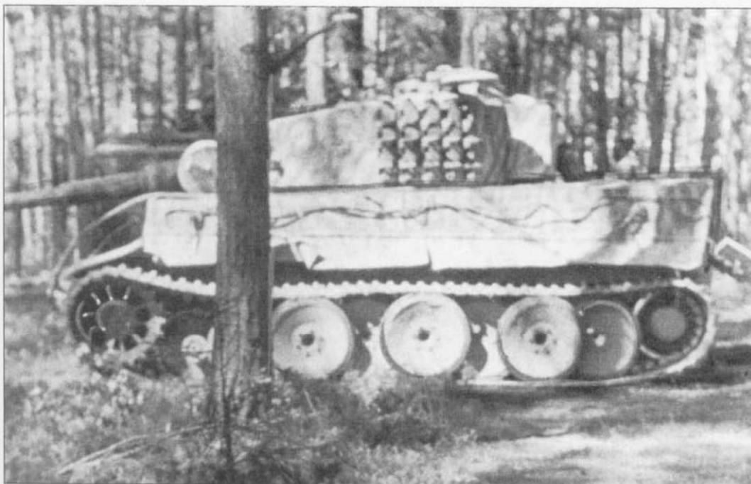
Танк «Тигр» в лесу в ожидании приказа вступить в бой. С трудом можно различить своеобразный камуфляжный рисунок: почти вертикальные узкие полосы зеленого и красно-коричневого цветов по базовой темно-желтой окраске. Еще одна особенность машины – полное отсутствие маркировки, нет ни опознавательного знака, ни бортового номера.
