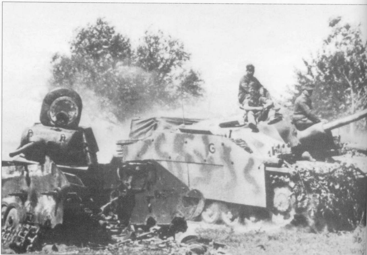
Штурмовое орудие StuG III Ausf. G, на переднем плане – разбитый советский легкий танк Т-70. Немецкая самоходка оборудована бортовыми экранами, в лобовой части корпуса установлена накладная броня. Обратите внимание на рисунок камуфляжа штурмового орудия.
