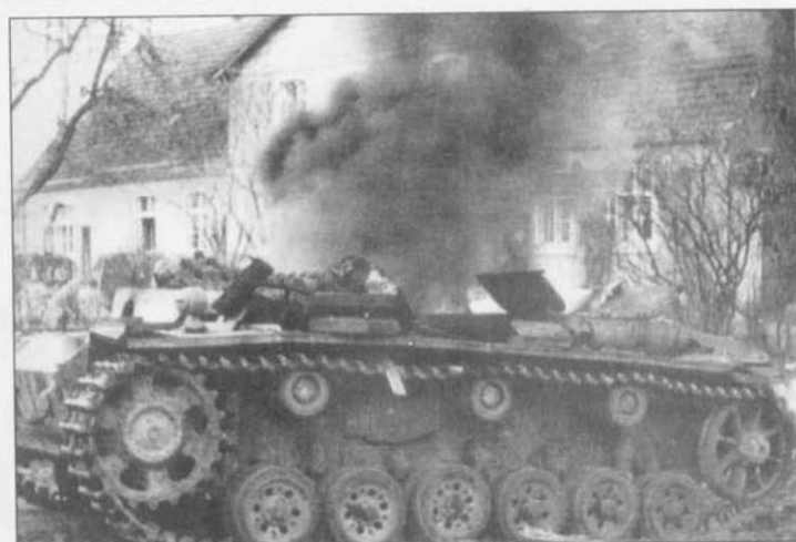
Эвакуационный танк Bergepanzer III догорает на улице германской деревни, Померания, март 1945 г. В эвакуационные танки переделывали с 1944 г. линейные Pz.Kpfw. III. Машины Bergepanzer III состояли на вооружении ремонтных рот частей, оснащенных штурмовыми орудиями StuG III и StuG IV. В лобовой части корпуса этой машины установлена накладная броня, а курсовой пулемет демонтирован.
