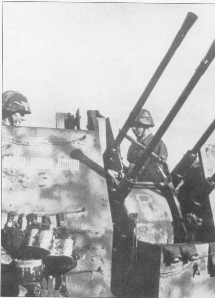
Еще один удачливый расчет зенитного орудия. Счетверенные зенитки 2 см Flakvierling-38 обычно устанавливались на полугусеничных бронетранспортерах. На щите этой пушки 30 победных отметок, выше изображен силуэт танка. Похоже, расчет успешно боролся как советскими самолетами, так и с советскими танками. В боекомплект к 20-мм зенитной пушке входили бронебойные снаряды. Между стволами видна написанная на щите литера «Р».
