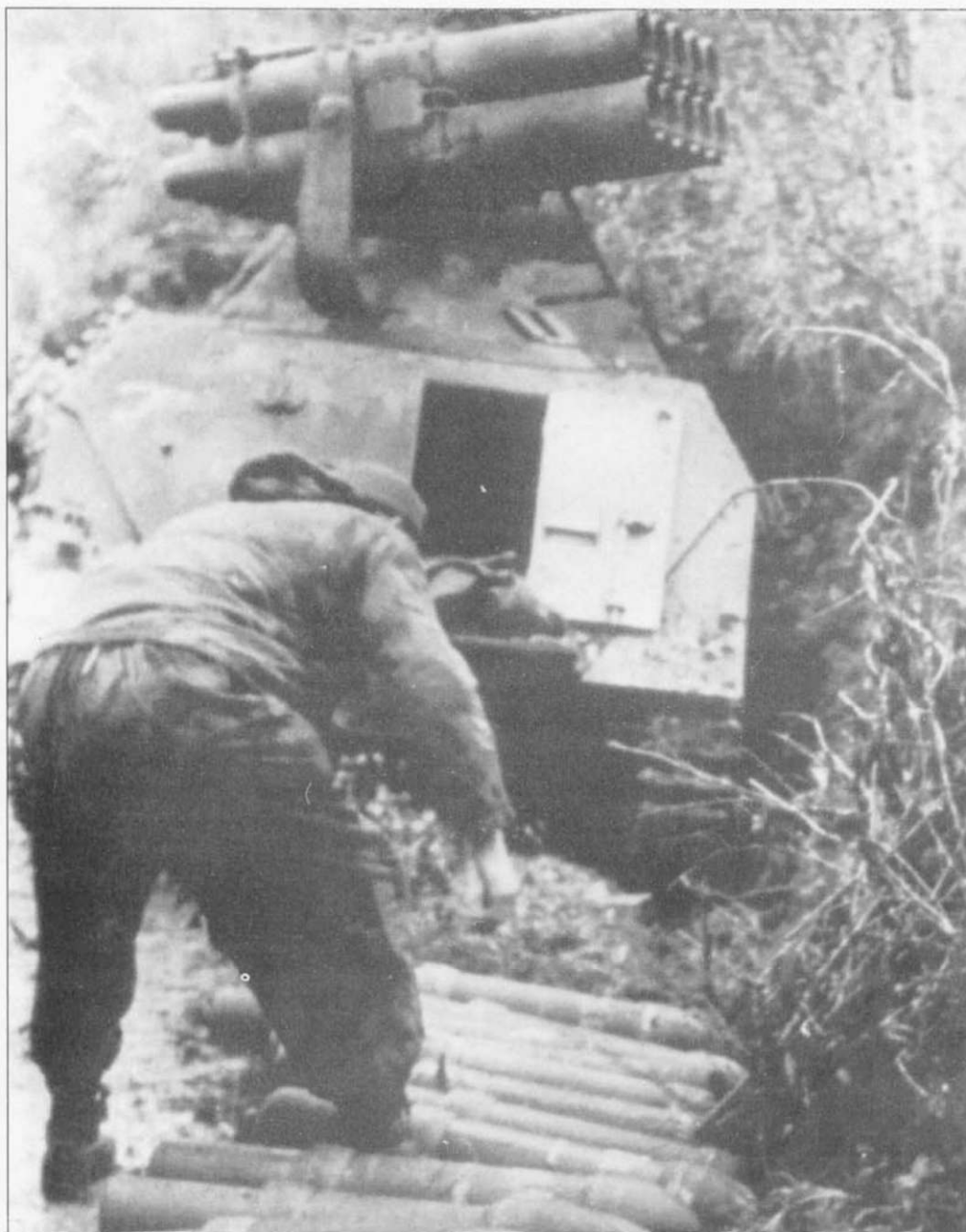
Погрузка боекомплекта в боевую машину Sd.Kfz. 4/I. Боевая часть ракеты имела массу 10 кг и накрывала осколком пространство площадью 13х40 м.
