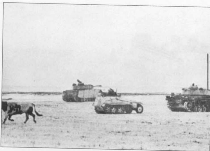
На снимок попали три различные боевые машины из штаба танкового батальона. Крайний справа – командирский танк Pz.Bef.Wg. III Ausf. K, в середине – штабная модификация полугусеничного бронетранспортера Sd.Kfz. 250 и крайний слева – танк Pz.Kpfw. IV. Слева на фотографии – бычок, так вот – он не окрашен, это его природный черно-белый камуфляж.
