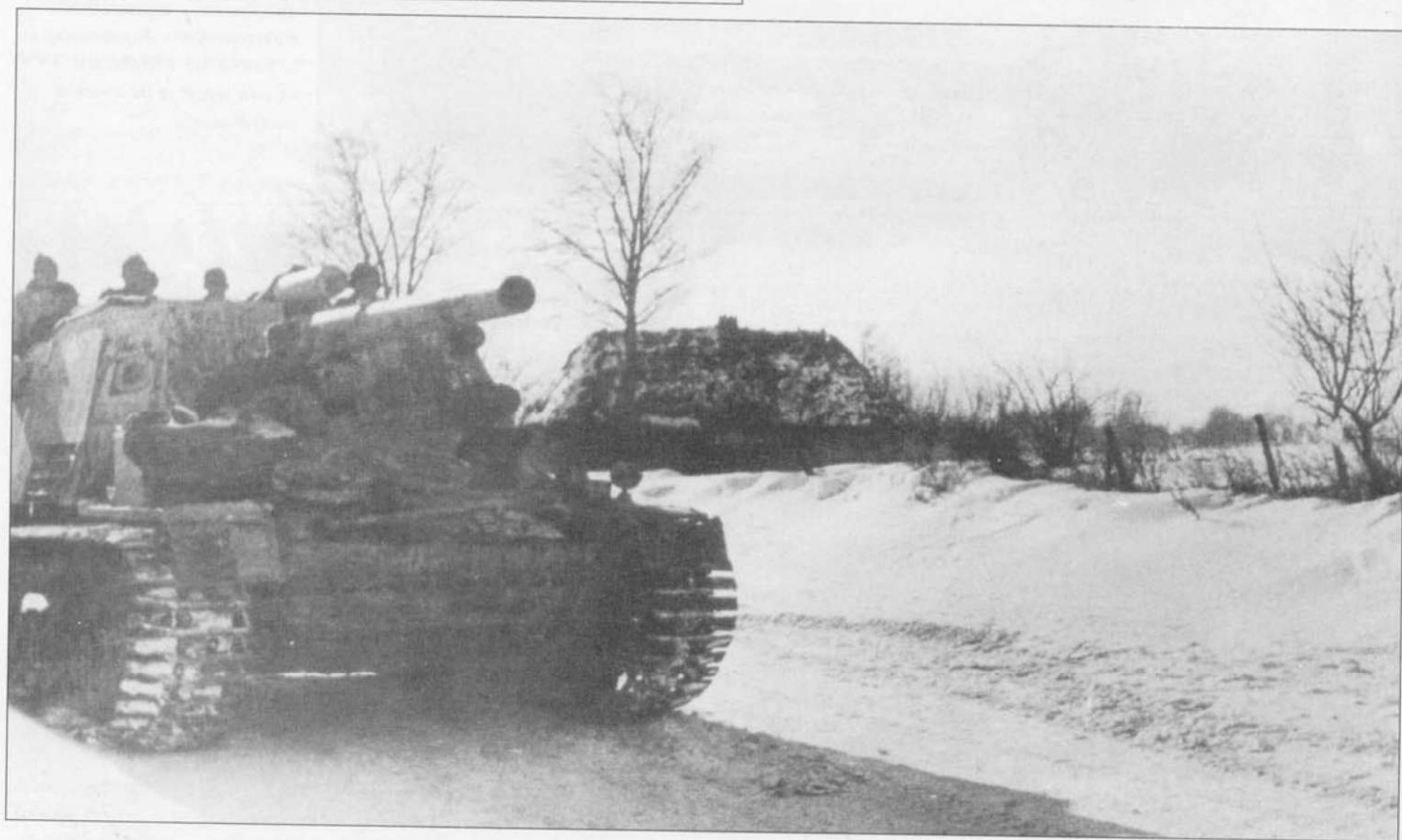
Серия из трех фотографий. На снимках машины батареи 150-мм самоходно-артиллерийских установок «Хуммель» из отдельного тяжелого артиллерийского батальона. Все три самоходки (пронумерованы литерами «А», «Г» и «О») оснащены расширителями Ostketten полностью или частично окрашены в белый цвет.
