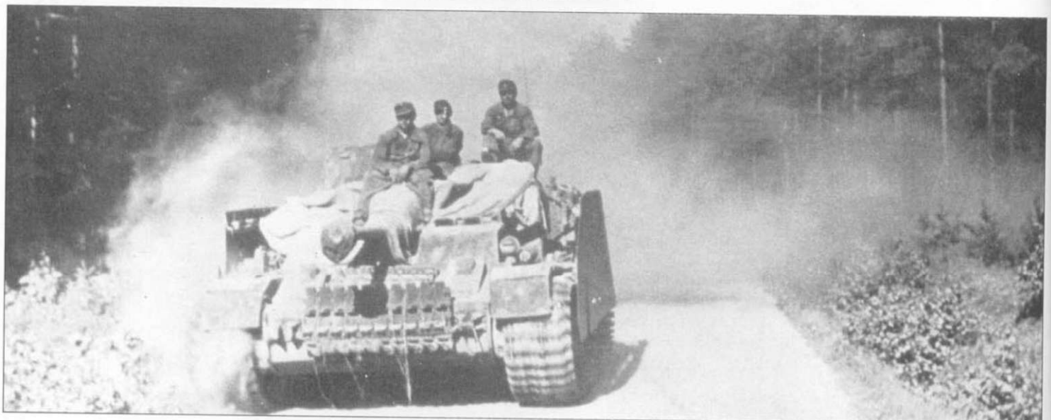
Штурмовое орудие StuG IV на лесной дороге. Обратите внимание на ширину траков гусениц. Эти траки были разработаны в 1944 г. с учетом опыта эксплуатации траков Ostketten. Сохранилось очень немного фотографий штурмовых орудий с широкими траками, все они сделаны на Восточном фронте.
