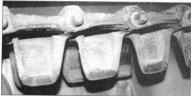
Крупный план траков, видны головки пальцев и зубья, Синсхейм.
