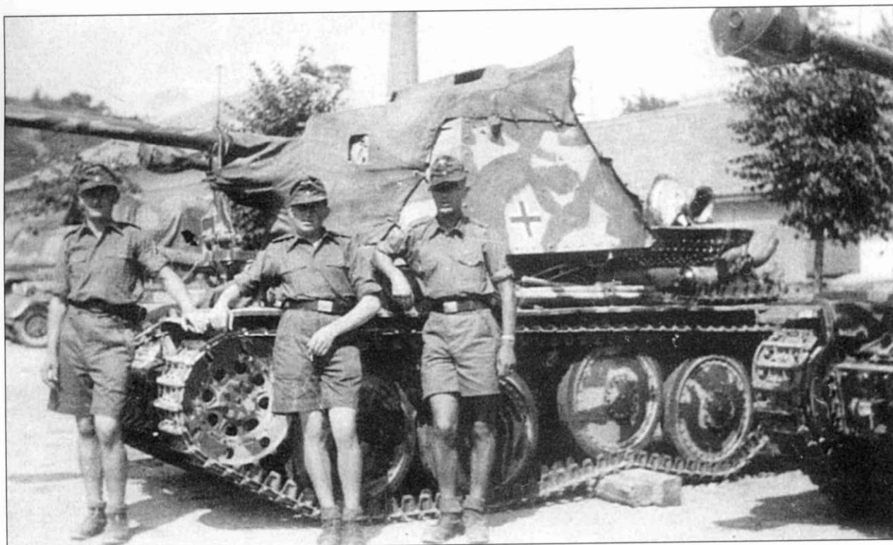
На этом снимке неплохо виден рисунок камуфляжа самоходки «Мардер III» Ausf. H из Panzerjäger-Abteilung 171. Обратите внимание на опорный каток, «наехавший» на деревянный брус. Оцените вертикальный ход подвески машины. Пятна камуфляжа нанесены кисточкой даже на опорные катки.
