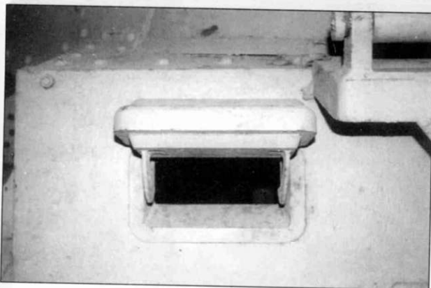
Смотровой лючок механика-водителя открыт. Обычно в поем устанавливалось бронестекло, Синсхейм.
