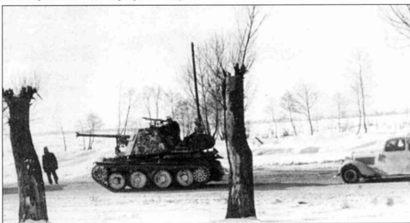
«Мардер III» Ausf. H, Россия. На борту рубки с трудом можно различить тактический номер «27», подразделение установить не удалось. Дульный тормоз пушки разорван, видимо самоходка направляется в тыл на ремонт.
