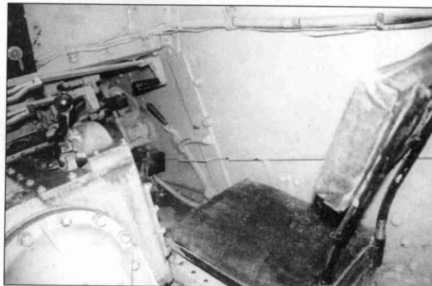
Вид на трансмиссию. Правее трансмиссии расположено рабочее место механика-водителя. Видны рычаги управления и педали. Левее трансмиссии находится место радиста. Шаровая установка курсового пулемета снята, Триест.
