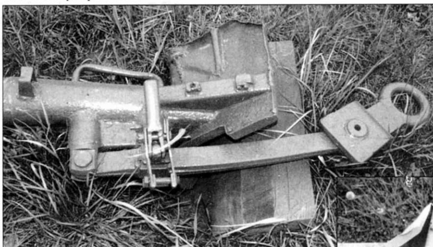
Станина с упором в грунте, другой вариант буксирной тяги.
