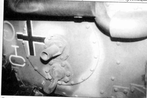
Люк доступа к двигателю в кормовом бронелисте корпуса, Синсхейм. Люк крепится болтами с шестигранными головками. Обратите внимание на отличие шестигранных головок болтов от круглых головок заклепок.
