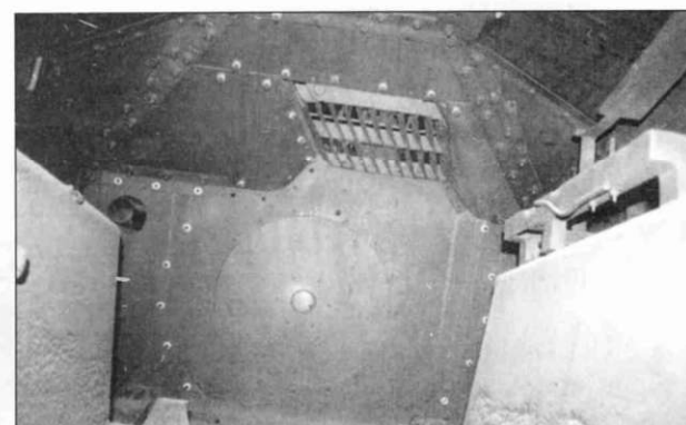
Задняя стенка пустого моторного отделения, в середине расположен круглый смотровой люк, который крепится на болтах, Синсхейм.
