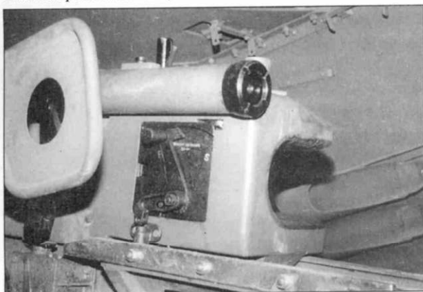
Левая сторона казенника, виден спусковой рычаг, Синсхейм.
