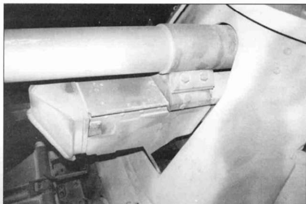
Крупный план корневой части ствола орудия и вреза в орудийном щите, Синсхейм.
