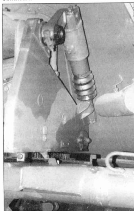
Крупный план цапфы орудия и пневматического экватора, Синсхейм.
