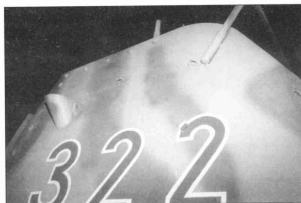
Крупный план антенного ввода и скобы. Обратите внимание на небольшие скобы, которые служат для фиксации тента на бортах рубки.
