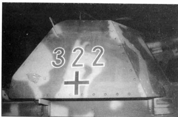
Правый борт рубки, хорошо видны головки болтов, Синсхейм.
