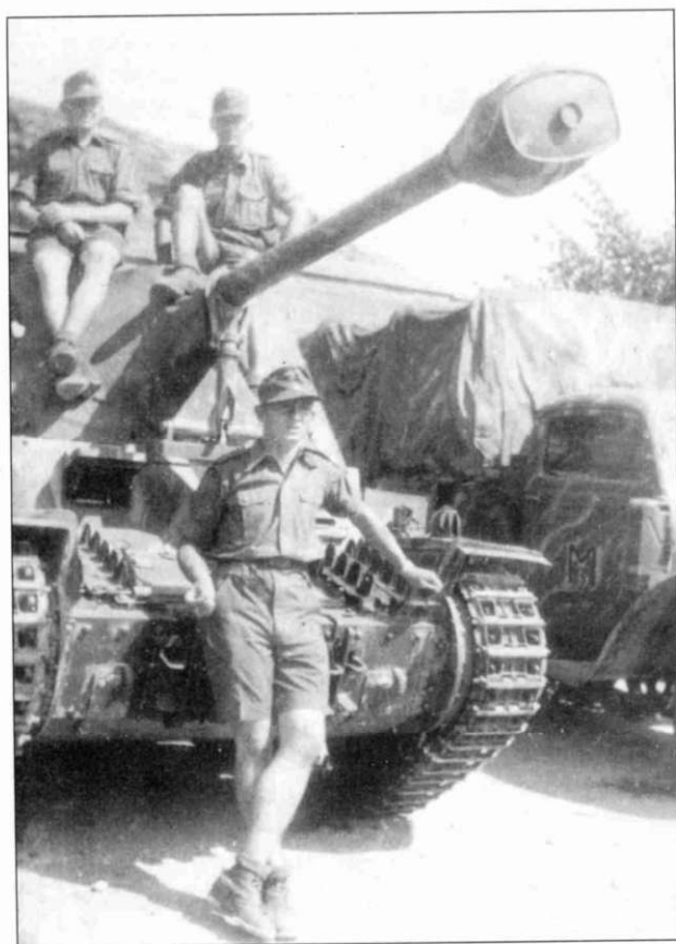
На снимке очень хорошо видны детали чехла, которым закрыт дульный тормоз.
