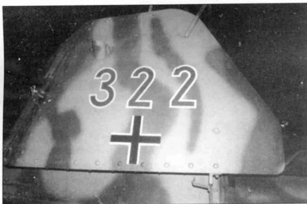
Левый борт рубки, Синсхейм. Над цифрой «3» виден антенный ввод, над крайней цифрой «2» приварена скоба тента.
