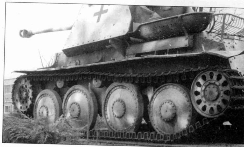
Ходовая часть крупным планом. Видны также откидной перфорированный металлический лист и корзина для стреляных гильз, Синсхейм. Все самоходки «Мардер III» имели по два поддерживающих ролика с каждого борта.
