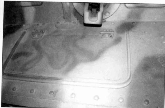
Люк доступа к трансмиссии. Хорошо видны головки заклепок на верхнем лобовом бронелисте корпуса, Синсхейм.
