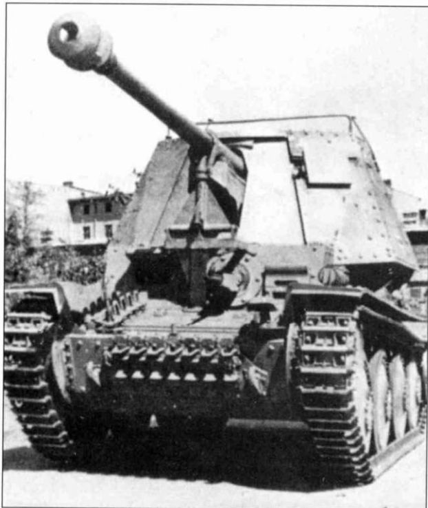
Вид спереди новенькой, только с завода, самоходки «Мардер III» Ausf. H. Видны запасные траки в лобовой части корпуса и курсовой пулемет.
