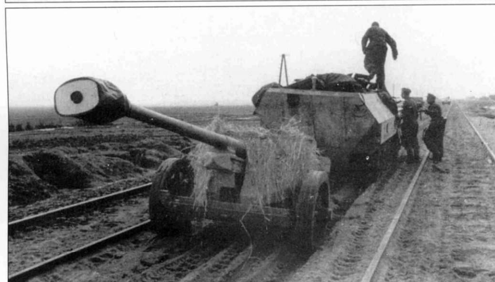
Редчайший снимок – обу- тая в импровизированные лыжи противотанковая пушка Pak 40 на прицепе у тягача RSO. Такая комбина- ция «тягач-пушка» приме- нялась в противотанковых частях пехотных дивизий.
