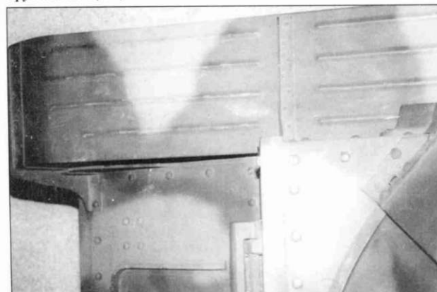
Вид сверху на переднюю часть правого подкрылка, Синсхейм. Хорошо видны штампованные ребра жесткости.
