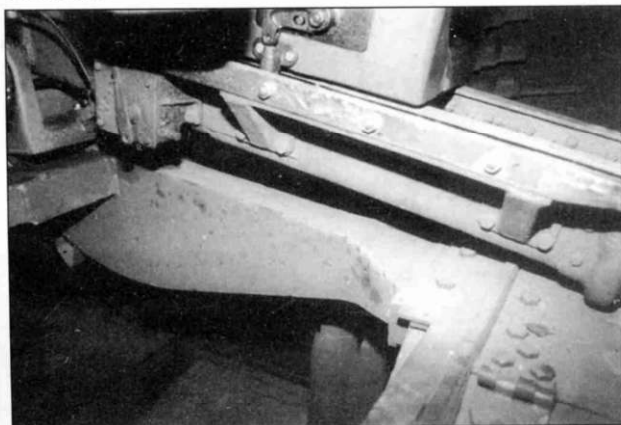
Направляющие, по которым откатывается ствол после выстрела, Синхейм.
