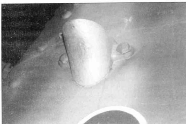
Антенный ввод крепится к борту рубки болтами.
