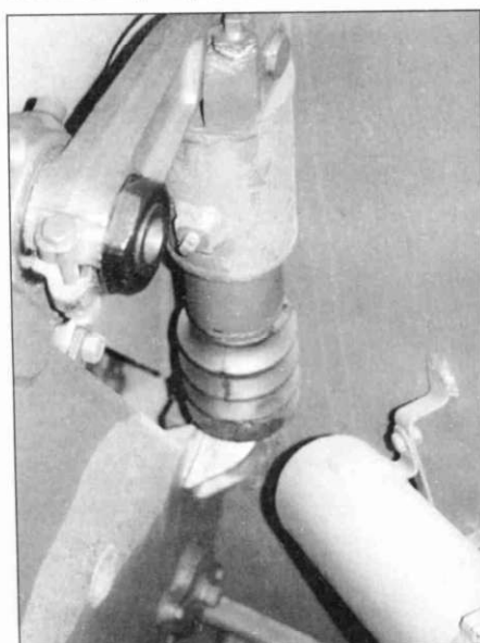
Вид сверху правой цапфы и пневматического экватора, Синсхейм.
