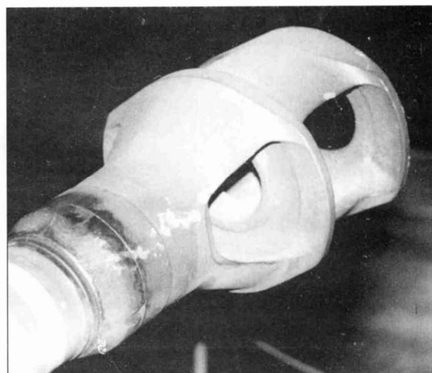
Дульный тормоз пушки 7,65 см Pak 40/3, Триест.
