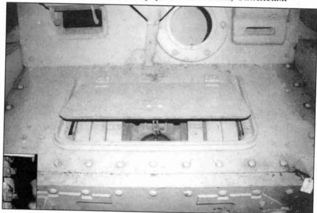
Приоткрытый люк доступа к трансмиссии. Шаровая установка курсового пулемета отсутствует, частная коллекция, Триест.
