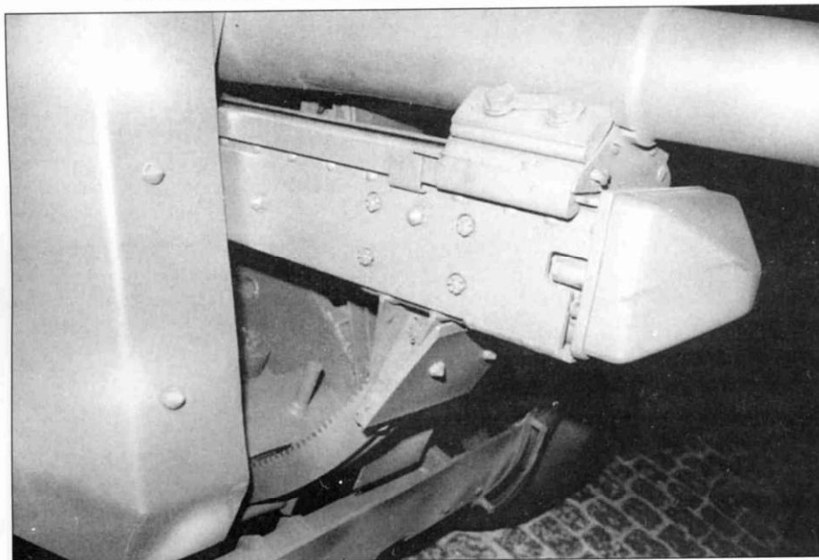
Нижняя секция щита в сложенном положении, вид сверху.
