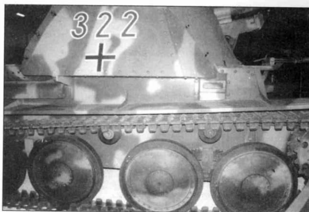
Правый борт самоходки в целом. Видны поддерживающие верхнюю ветвь гусеницы ролики, Синсхейм.
