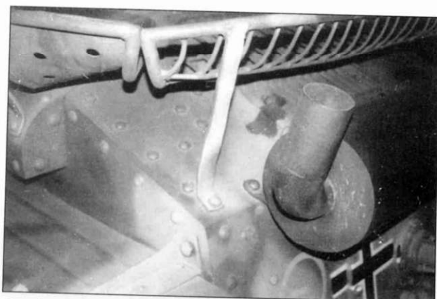
Левый угол кормы корпуса, Синсхейм. На переднем плане – глушитель с выхлопом. Хорошо виден крепеж корзины для стреляных гильз.
