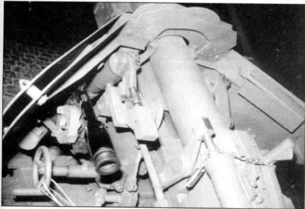
База под установку телескопического прицела.
