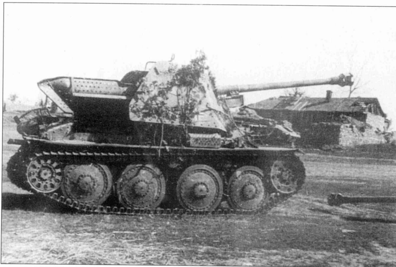
Все откидные щиты пола рубки подняты. Вероятно, это самоходка «Мардер III» Ausf. H ожидает или ремонта, или осмотра двигателя.
