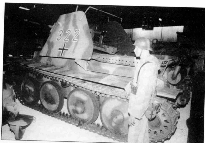
Левая задняя часть самоходки из коллекции Автотехнического музея в Синсхейме. Заглушка с втулки ленивца снята. Восковая фигура солдата дает представление о размерах самоходки.
