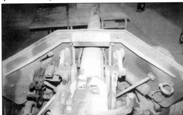
Верхняя часть орудийного щита, вид изнутри. По центру закреплен контейнер для фонарика, запасной спусковой пружины и масленки.
