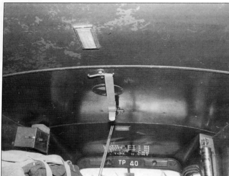
Потолочные петли, крючки и ремни для крепления носилок в фургоне Dodge WC54.
