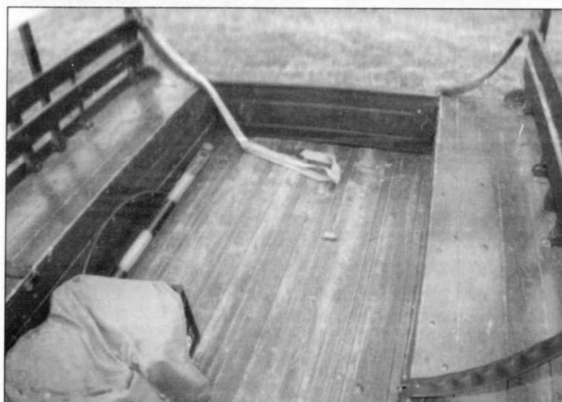
Детали кузова Model 44/45. Обратите внимание на два металлических кожуха (задних оси-то две!) на боковых коробах кузова. Лопата закреплена вертикально рядом с водителем.
