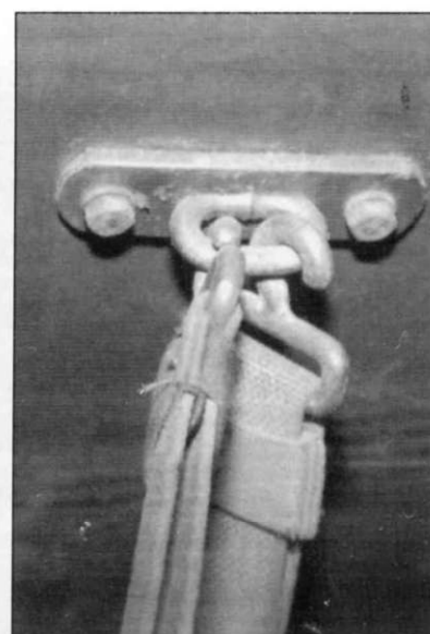
Потолочные петли, крючки и ремни для крепления носилок в фургоне Dodge WC54.
