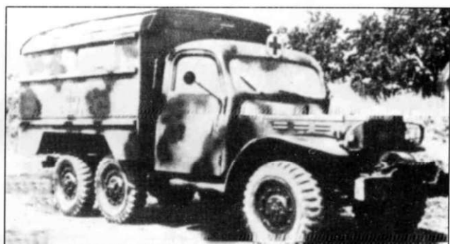
Внедорожная полноприводная санитарная машина (Sjukiransponierrangbil 961) шведских вооруженных сил на основе Dodge 6x6.
