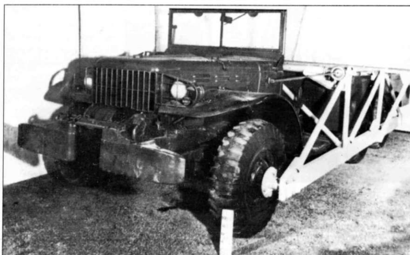
Один из проектов переброски Dodge 6x6 по воздуху. Предлагаемая рамная конструкция позволяла подвешивать машину под фюзеляжем грузового самолета C54A.
