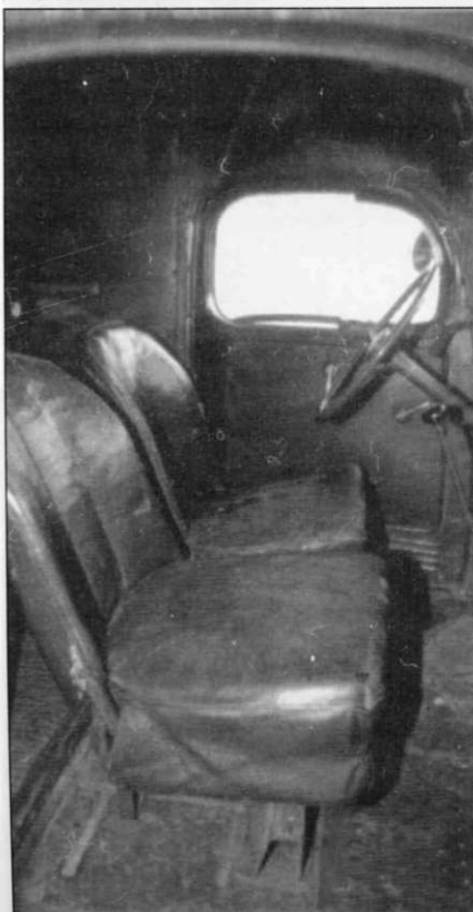
Детали внутреннего интерьера машины окрашивались в зеленый глянцевый цвет. Напольные резиновые коврики – современное дополнение. А вот кожаная обивка сидений является оригинальной. Вид рулевого колеса и расположение табличек с инструкциями позволяют идентифицировать машину, представленную на фотографиях как Model 44/45. Зеркало заднего обзора также оригинальное, выполненное на затемненном стекле.
