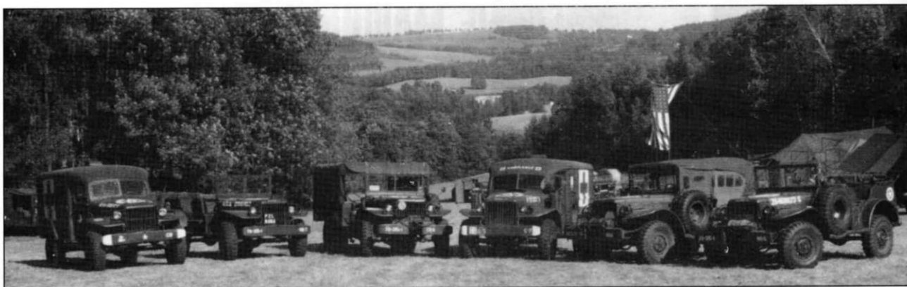
Современная коллекция армейских автомобилей Dodge. Слева направо: санитарный WC54 Ambulance, транспортер оружия WC51, трехосный WC63 Big Shot, еще один санитарный WC54 Ambulance, два командирских WC63 (левый с брезентовым тентом французского производства).
