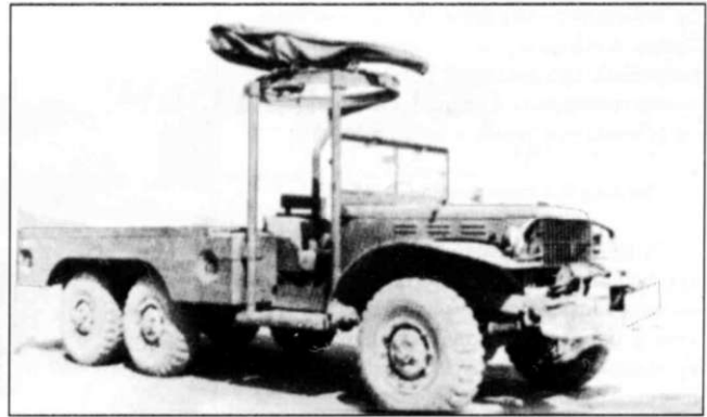
Кольцевой станок пулемета М50 на WC63. Этот грузовик с регистрационным №6082586 был направлен в Артиллерийский департамент (Ordnance Department) для испытаний бортового оружия в Абердине (Aberdeen Proving Ground).
