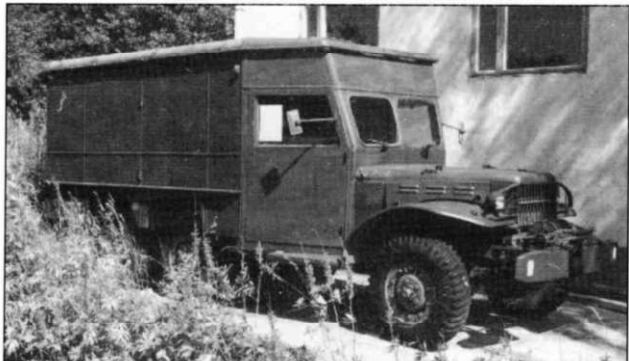
Типичная шведская машина радиосвязи из состава военно-воздушных сил (Mottagarterrangbil 941). На машинах без лебедки запасное колесо размещалось на переднем бампере.
