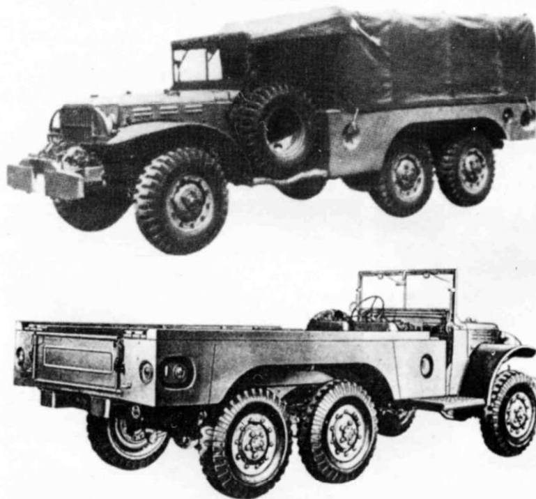
Вид сзади сбоку WC62 без тентовых дуг над кузовом и кабиной.
