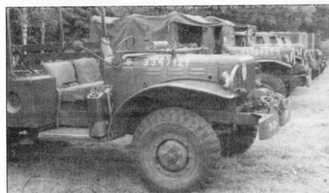
Капот трехосного Dodge T223 WC63. У левой машины ветровое стекло опущено и закреплено зажимами на капоте.
