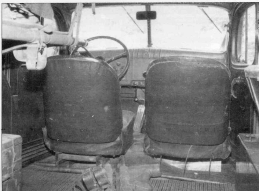
Детали внутреннего интерьера машины окрашивались в зеленый глянцевый цвет. Напольные резиновые коврики – современное дополнение. А вот кожаная обивка сидений является оригинальной. Вид рулевого колеса и расположение табличек с инструкциями позволяют идентифицировать машину, представленную на фотографиях как Model 44/45. Зеркало заднего обзора также оригинальное, выполненное на затемненном стекле.
