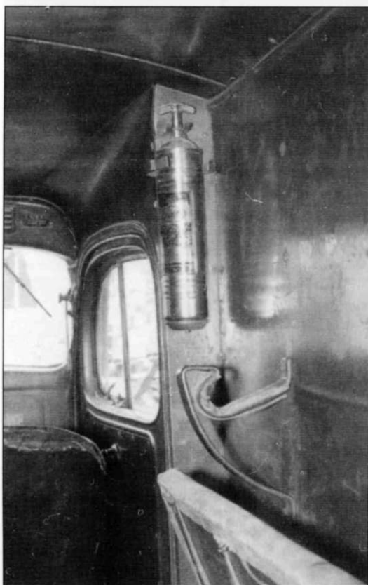
Слева сверху – скоба-кронштейн для поднятия и фиксации ветрового стекла.
