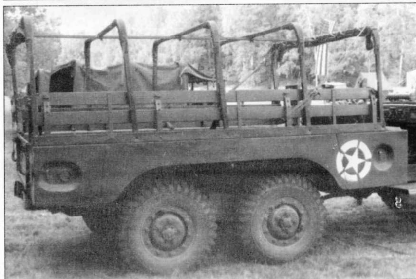
Кузов трехосного Dodge T223 WC62/63. Скамейки для пассажиров подняты и закреплены как дополнительные бортовые решетки. Обратите внимание на продольную жердь, скрепляющую дуги тента. Она предохраняет их от раскачивания и повреждение во время тряски в пути.
