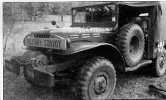
Капот трехосного Dodge T223 WC63. У левой машины ветровое стекло опущено и закреплено зажимами на капоте.
