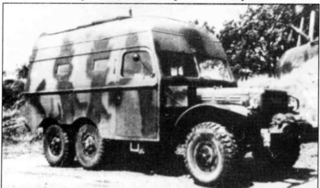
Командирская машина и центр радиосвязи (Stabsterrangbil 930C) шведской береговой артиллерии. Один из приблизительно десяти существовавших вариантов кузовов командирских фургонов шведских вооруженных сил
