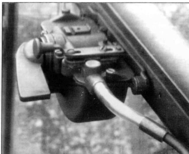
Детали внутреннего интерьера Dodge WC57. Стеклоочистители с пневмоприводом - послевоенное дополнение, полученное машиной во время службы во французской армии. Обратите внимание на цельное двойное переднее сиденье.
