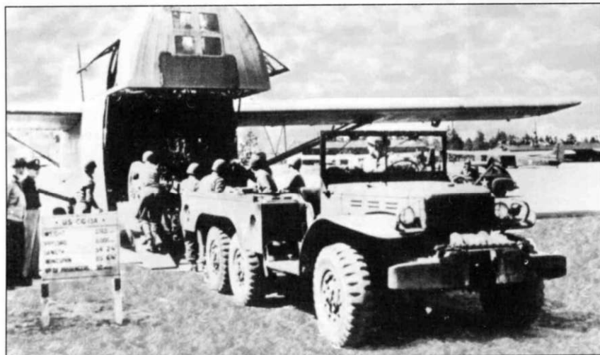
WC63 из группы поддержки полевой артиллерией загружается в десантный планер CG13A (планер этого типа мог вместить до 30 человек или два Dodge, или грузы подобной массы и габаритов). Фотография была сделана во время учебной демонстрации в Северной Каролине.
