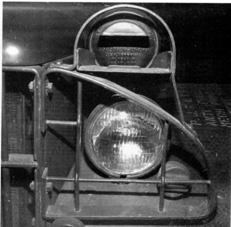
На левом крыле на моделях 1942/43 гг. выше стандартной фары размещалась затемненная светомаскировочная фара. При таком варианте левая решетка была симметрична правой, но имела сверху «надстройку».
