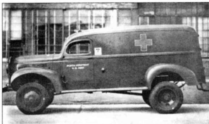
Слева - санитарная машина Dodge 1/2-ton 4x4, разработанная на основе коммерческого фургона. Справа - армейская версия пикапа 4x4 1940 года, созданная на основе коммерческого Dodge 4x2.
