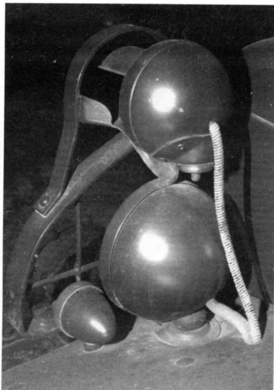
На левом крыле на моделях 1942/43 гг. выше стандартной фары размещалась затемненная светомаскировочная фара. При таком варианте левая решетка была симметрична правой, но имела сверху «надстройку».
