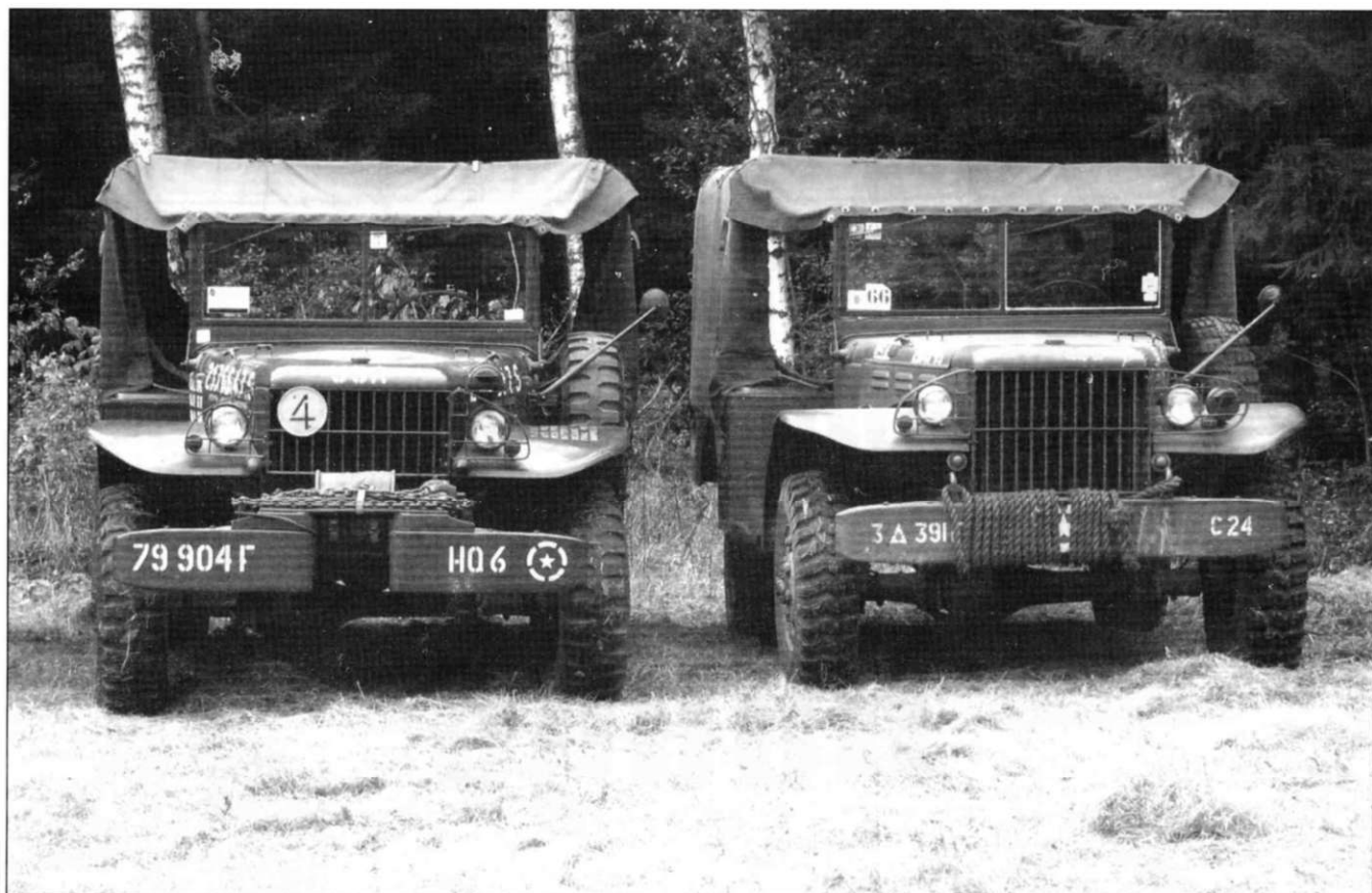
Два Dodge 3/4-ton 4x4 WC-51. Машина слева, с лебедкой (Weapon Carrier with Winch), более раннего выпуска - 1942 г., машина справа - Weapon Carrier less Winch, выпуска 1944/45 гг. Это можно заметить по расположению светомаскировочной фары на левом крыле.
