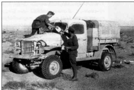
Два Dodge T212 канадского производства стали трофеями немцев. Северная Африка, 1942 г. Характерная «канадская» черта, отличающая машины от аналогичных грузовиков американского производства - двойной ящик позади кабины. На левом снимке машина без люка на крыше кабины, справа - с люком. Эта деталь добавлена уже в Африке в местных полевых мастерских.
