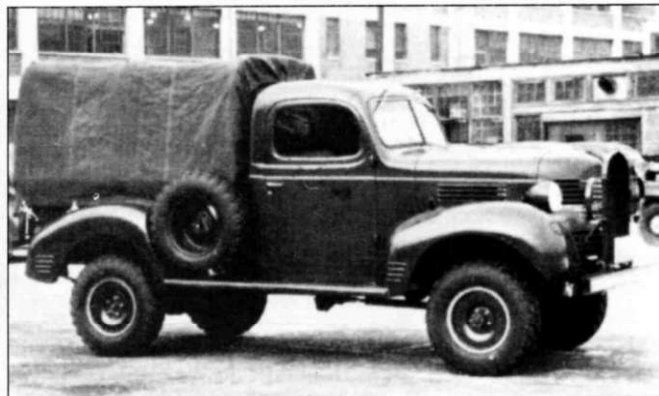
Слева - санитарная машина Dodge 1/2-ton 4x4, разработанная на основе коммерческого фургона. Справа - армейская версия пикапа 4x4 1940 года, созданная на основе коммерческого Dodge 4x2.
