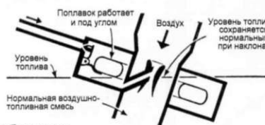
Карбюратор с концентрическим поплавком. Наклонное положение
