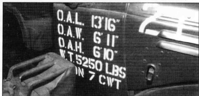
Капот и радиаторная решетка Dodge WC-52 Model 1942. На машине восстановлены все технические надписи - на торпедо справа габаритные размеры машины, на левом крыле желтыми буквами нанесены данные об антифризе и аккумуляторной батарее. На капоте синими буквами нанесен номер машин, полученный при выпуске с завода.
