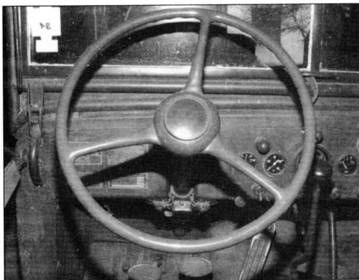
Сверху - цельнопластмассовое рулевое колесо Dodge 3/4 Model 1942/43 гг.
