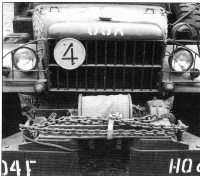
Капот и радиаторная решетка Dodge WC-52 Model 1942. На машине восстановлены все технические надписи - на торпедо справа габаритные размеры машины, на левом крыле желтыми буквами нанесены данные об антифризе и аккумуляторной батарее. На капоте синими буквами нанесен номер машин, полученный при выпуске с завода.
