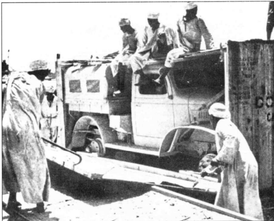
Контейнер с полусобраным Dodge T212 прибыл в Египет, 1942 г. Масса контейнера 3141 кг, масса тары 743 кг, сухой вес машины 2398 кг.
