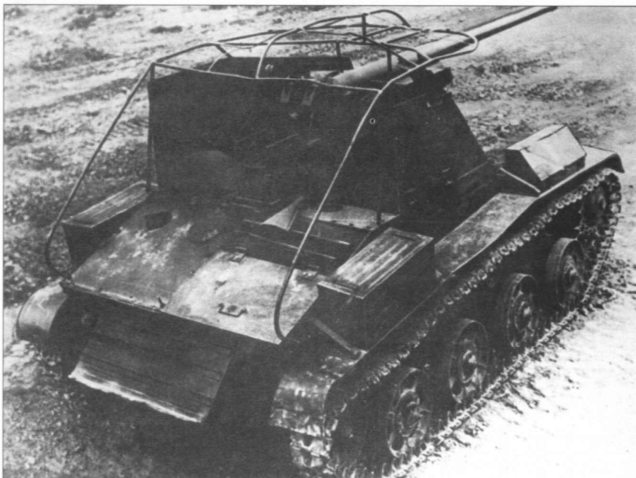
Самоходно-артиллерийская установка тип autopropulsat cu afet mobil 76,2mm - румынская конверсия трофейного танка Т-60, на который установлена трофейная же пушка Ф-22. Самоходка целиком окрашена в темно-зеленый цвет, маркировка отсутствует. Крест Михая часто изображали на крышке ящика для боекомплекта, но на этой самоходки ящика нет.
