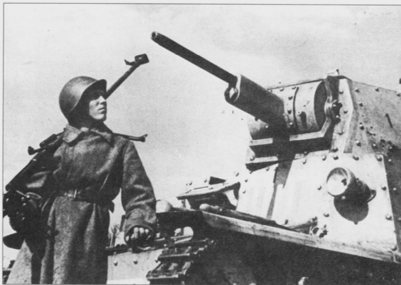
Советский солдат с противотанковым ружьем ПТРД осматривает легкий итальянский танк L6/40 из LXVII батальона Bersaglieri Corazzato. Четыре вертикальных белых полосы на лобовом бронелисте корпуса обозначают 4-ю роту, цвет полос идентифицирует роту. На борту башни виден тактический номер «1» (первая машина взвода) черного цвета.
