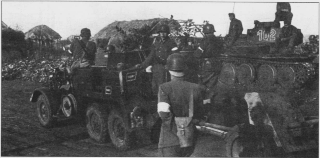
Выпущенный по лицензии в Венгрии броневедомитель Крупп Protze Kfz. 70 с 40-мм противотанковой пушкой 40М на буксире. Техника принадлежит 1-й бронетанковой дивизии. Орудие 40М получено наложением 40-мм пушки Бюффе на лафет германского противотанкового орудия PaK-36. На борках броневика хорошо видны тактические символы противотанковой роты. На заднем плане - танк Pz.Kpfw. 38(t). После Сталинграда 1-я венгерская бронетанковая дивизия из реальной стала виртуальной.
