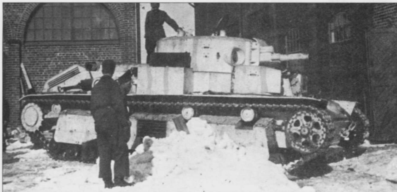
Танк Т-28, снимок сделан Кескускоряамо, Хаминлинна, весной 1940 г. Машина целиком перекрашена в белый цвет. Обратите внимание на чуть более темные вертикальные полосы, имитирующие тени от деревьев; полосы - светло-голубого цвета. Такой зимний камуфляж был принят в финской артиллерии.
