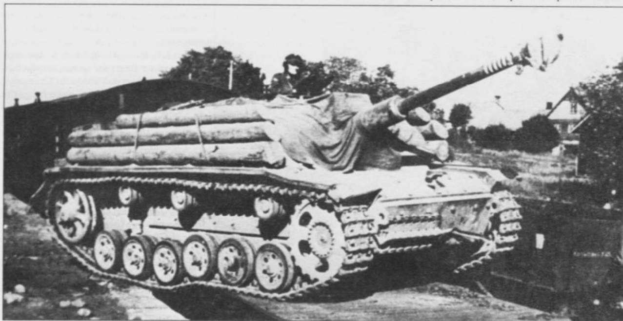
Штурмовое орудие StuG III (регистрационный номер танка Ps 531-14), снимок сделан в конце лета 1944 г. Машина сильно доработана с целью улучшения защищенности, дополнительная «броня» сделана из бревен, бетона и накладных бронелистов. Штурмовое орудие принадлежит 2-й роте батальона штурмовых орудий, на стволе пушки отметки о шести победах. Позже машина использовалась в 1-й танковой бригаде в качестве учебной.
