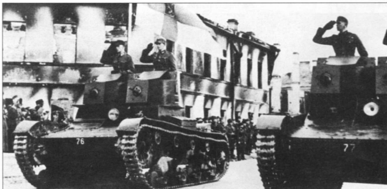
На параде танки Т-26 образца 1931 г. из 2-й танковой роты финского танкового батальона. На борту левой башни одного из танков видна часть свастики с полноценными, длинными, «руками». Снимок сделан в 1941 г. Хорошо видны тактические номера «76» и «77» на нижних лобовых бронелистах корпусов танков. На левом танке рядом с фарой можно разглядеть изображение дракона - эмблемы батальона.
