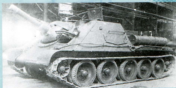
★ Справа и внизу: опытная САУ СУ-122М со 122-мм гаубицей Д-11 в заводском цеху. Апрель 1943 г.
