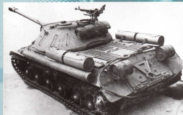
★ Серийный танк ИС-3, вид сзади сверху. Машина полностью укомплектована: на корме башни уложен укрывочный брезент, на левом борту — бревно самовытаскивания, на корме корпуса — дымовые шашки МДШ и буксирный трос.
