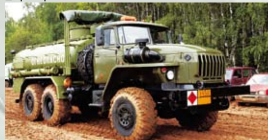
□ Новая идея маскировки: тент превращает топливозаправщик в обычный бортовой автомобиль
