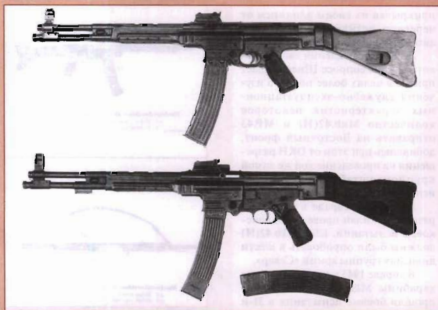
■ Сверху – 7,92-мм автоматический карабин Mkb.42(H) (1-й вариант); снизу – 7,92-мм автоматический карабин Mkb.42(H) aufschiefend (2-й улучшенный вариант)
