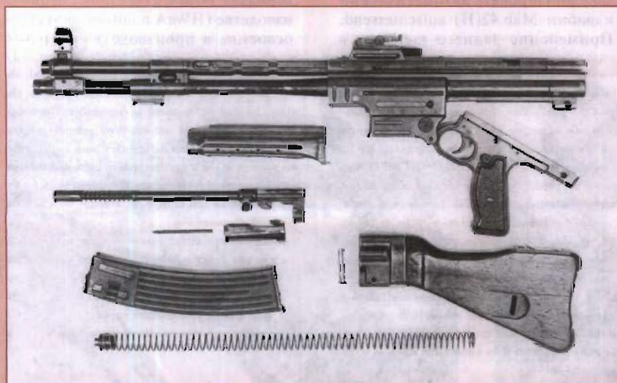
■ Неполная разборка 7,92-мм автоматического карабина Mkb.42(H) aufschiefend (2-й улучшенный вариант)
