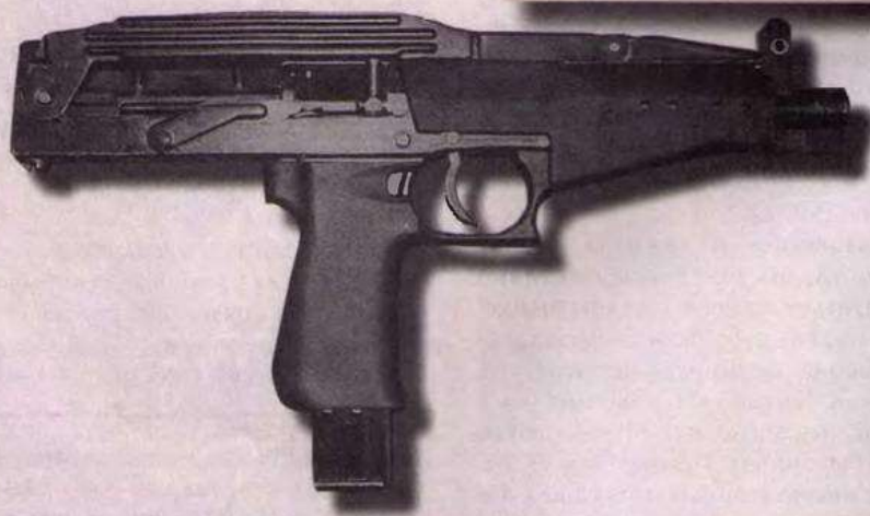
СР-2 «Вереск» (Россия) Производитель: ЦНИИТОЧМАШ, Климовск; пистолет-пулемет Боеприпасы – 9х21 мм (СП10, СП11, СП12, СП13) Длина со сложенным прикладом – 367 мм Длина с прикладом в боевом положении – 603 мм Емкость магазина – 20 или 30 патронов
