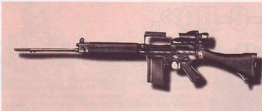
■ 7,62-мм самозарядная винтовка L1A1 – британский вариант бельгийской винтовки FN FAL
