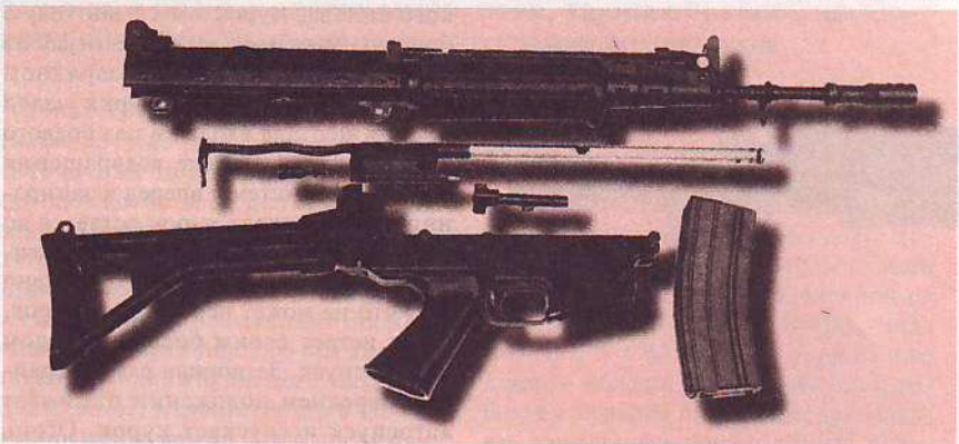
■ Неполная разборка штурмовой винтовки FNC
