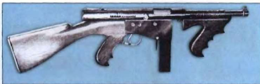
Пистолет-пулемет M6 – первая серийно выпускавшаяся модель Г. Ингрэма. Видны черты подражания «Томпсону»
