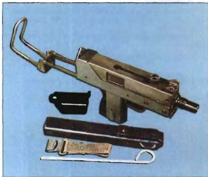
■ Пистолет-пулемет М10 «Ингрэм» с выдвинутым прикладом (вид сверху) и магазин на 30 патронов
