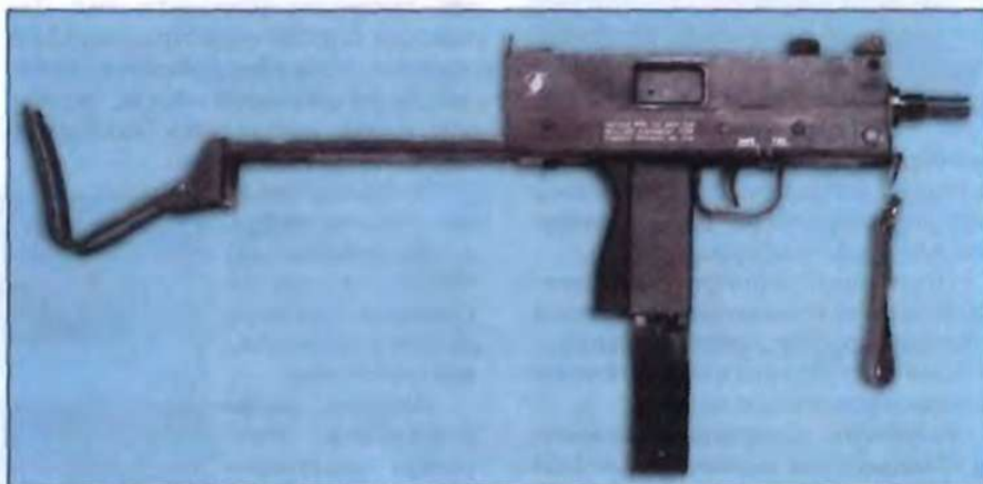
Пистолет-пулемет M10 «Ингрэм» под патрон 9x19 «парабеллум» с выдвинутым прикладом, передней петлей, магазином на 25 патронов
