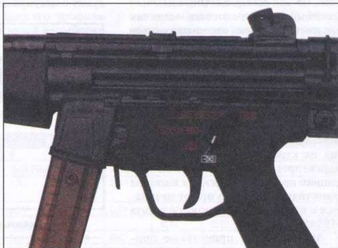
Стальная коробка пистолета-пулемета MP5/40. Видны обозначения четырех позиций флажка переводчика-предохранителя и магазин из прозрачной пластмассы
