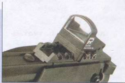
Монтаж коллиматорного прицела типа «Холосайт» на MP7 PDW
