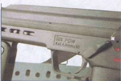
Флажок переводчика-предохранителя на прототипе MP7 PDW
