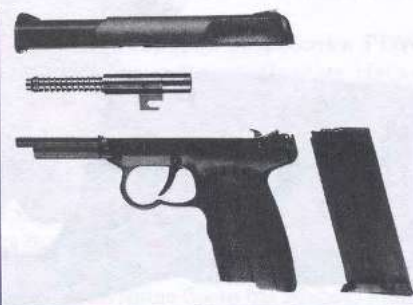
Неполная разборка пистолета «5-7» FN
