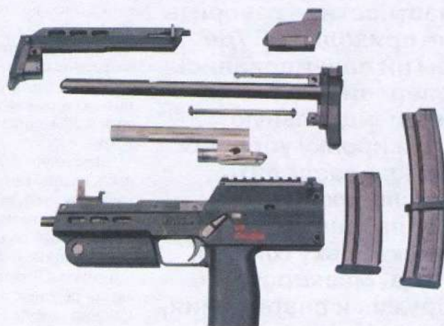
Неполная разборка MP7 PDW, показаны магазины на 20 и на 40 патронов
