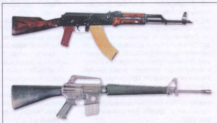
Автомат АКМ. На дульной части ствола виден компенсатор Якушева. Для сравнения рядом показана американская 5,56-мм автоматическая винтовка M16A1
