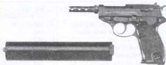
Американский комплект «Саунд Модератор Пистол» со сменным стволом и глушителем для пистолета Р.38 или Р-1 «Вальтер»
