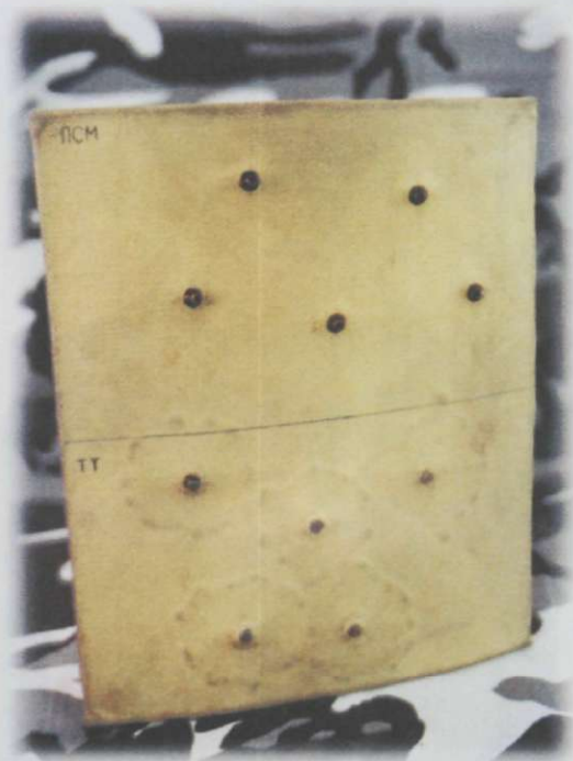
Бронепанель с антирикошетным покрытием. Хорошо видны застрявшие в нем пули от пистолетов ПСМ (сверху) и ТТ (снизу)
