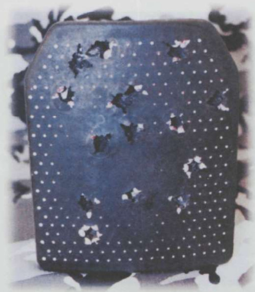
Композитно-керамический блок, сделанный по принципу шариковой брони, после испытаний на полигоне. Пробоития композитного слоя нет
