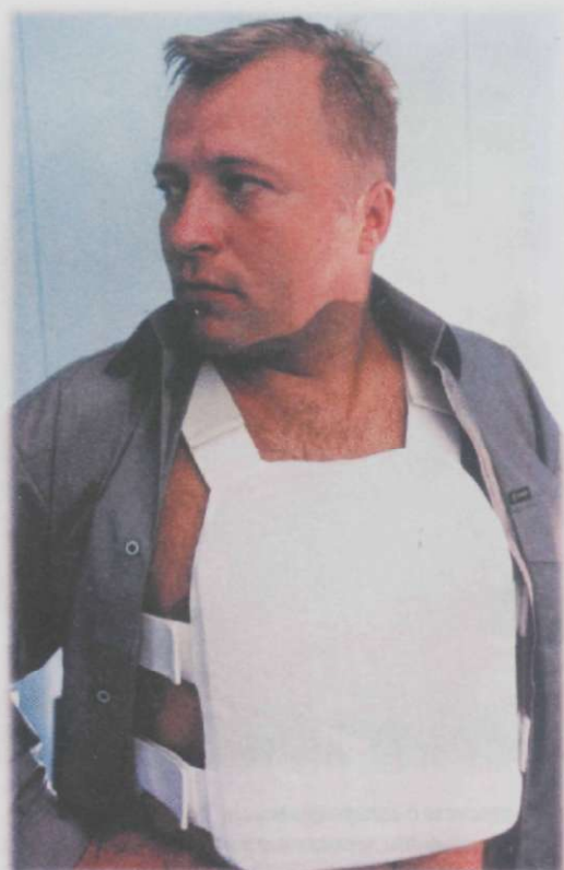
Новая разработка - бронежилет «Казак-5Ф», содержащий бронезлементы из полистиленовых волокон. Весит всего 1,25 кг и защищает от пуль пистолета ТТ (по 2-му классу)
