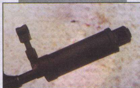
Дульное устройство СВУ-А неплохо убирает вспышку выстрела
