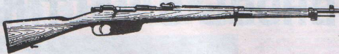
Оружие Освальда: 6,5-мм магазинная винтовка "Маулихер-Каркано" M91/24 (показана без оптического прицела). Длина оружия 1170 мм, длина ствола 680 мм, емкость магазина 6 патронов, вес - 3300 г
