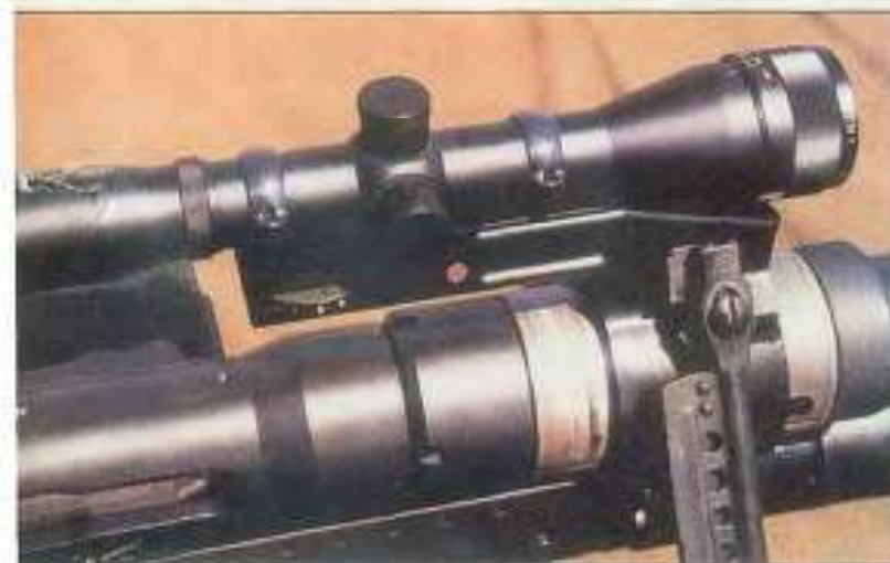
Оптический прицел 8x42 мм фирмы Lupo имеет стандартное перекрестие НАТО и, что более важно, увеличенное расстояние между окуляром и глазом стрелка. Обратите внимание на колесико регулировки угла возвышения на колодке, которое позволяет изменять установку дальности стрельбы в пределах 150 — 1500 м.
