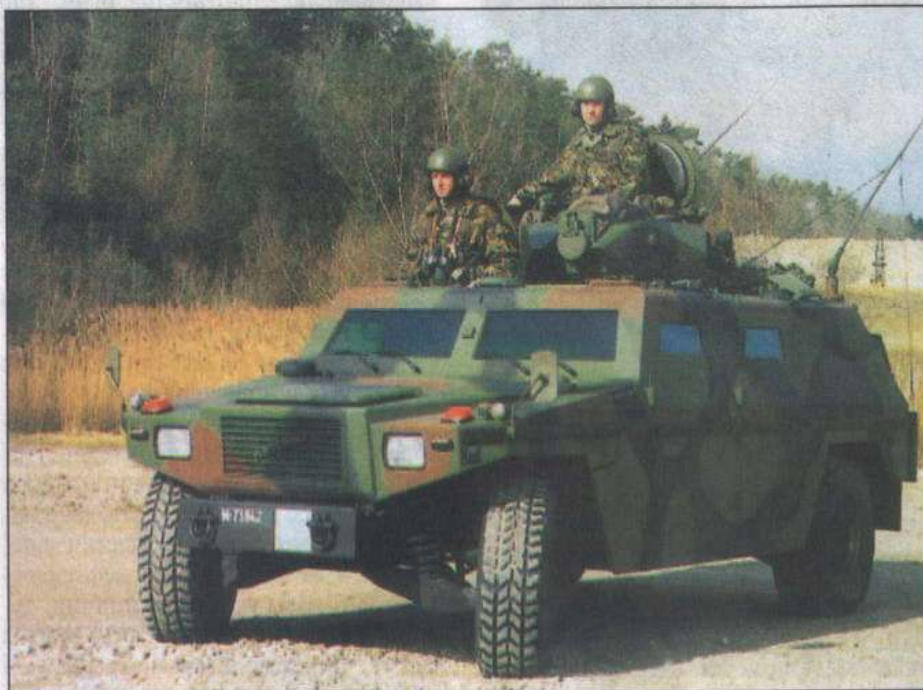
Швейцарская бронированная разведывательная машина Eagle фирмы Mowag на шасси тяжелого автомобиля «Хаммер»
