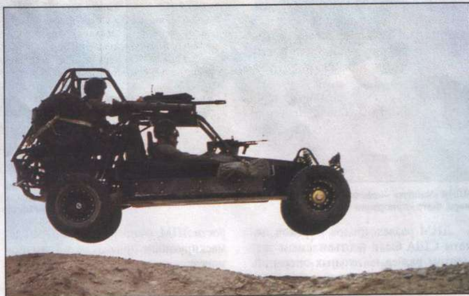
Летающий багги — патрульная машина для условий пустыни «Chenoweth». Вооружение: 40-мм станковый автоматический гранатомет Mk.19, 7,62-мм единый пулемет M60E и 84-мм противотанковый гранатомет AT-4. Фото Управления специальных операций ВМС США
