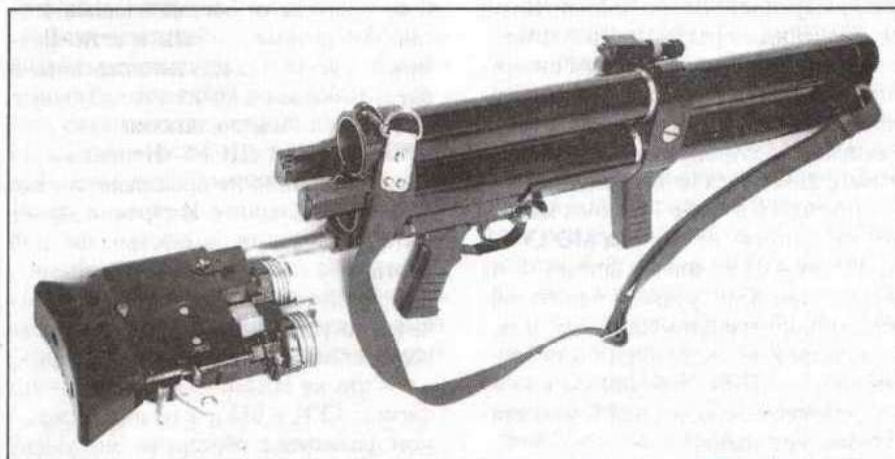
Нажатием на рычаг запираания происходит отпирание стволов, затвор получает возможность перемещаться назад с извлекаемыми из стволов стреляными стаканами или выстрелами
