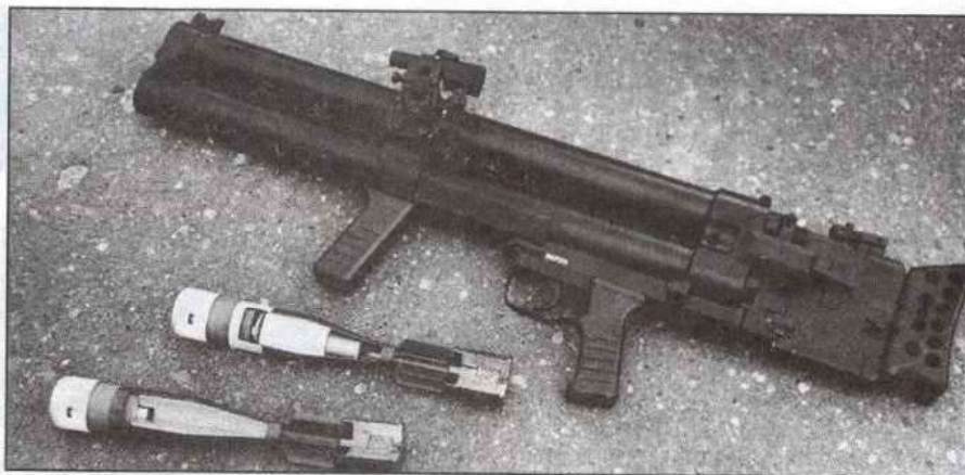
Вертикальное размещение стволов позволило сделать «Непрядву» довольно плоской и удобной для ношения за спиной при марш-бросках, которые предполагались в процессе патрулирования по берегам бухт и водоемов пешим порядком. Фото Ю. Пирогова
