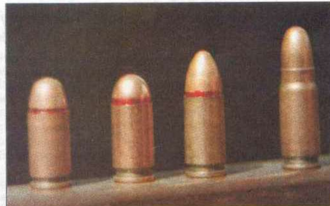
Среди наиболее распространенных в мире патронов для боевых pistols по крайней мере три правых внешне очень схожи. Однако, кроме разницы в длине гильз (9x19, 9x18, 9x17) они отличаются реальным диаметром пули более чем на 0,3 мм. При реальной глубине нарезов ствола оружия менее 0,1 мм путаница в патронах может иметь фатальные последствия
