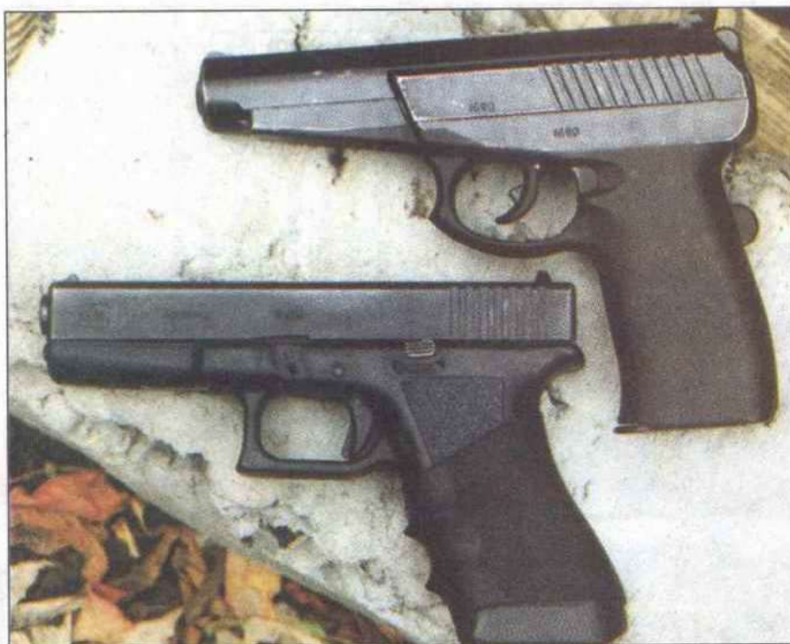
Весьма распространенное на новых моделях автоматическое предохранительное устройство, запирающее ударник до момента нажатия на спусковой крючок, усложняет конструкцию и снижает надежность оружия. Австрийский Glock 17 и отечественная «Гюрза»
