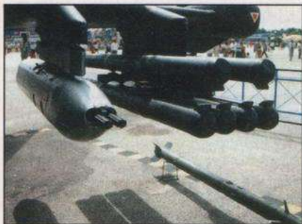
Боевой корабельный Ка-29 с основным вариантом вооружения: ПТУР «Штурм», пушкой 2А42 калибра 30 мм и блоками реактивных орудий Б8В20 с НАР калибра 80 мм
