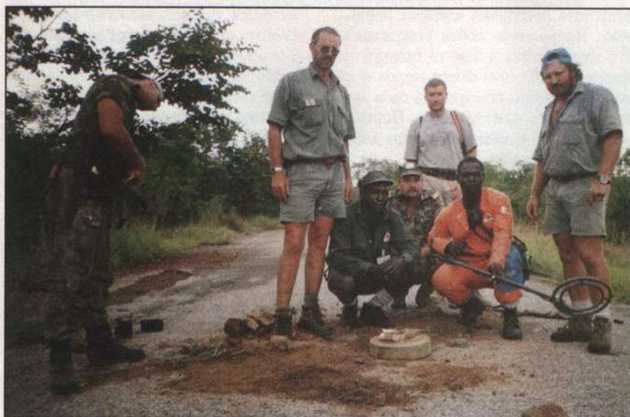
Русская противотанковая мина AT-57, усиленная 200-граммовой тротиловой шашкой. Эта многонациональная команда использует австрийский миноискатель AN19/2 «Schiebel»
