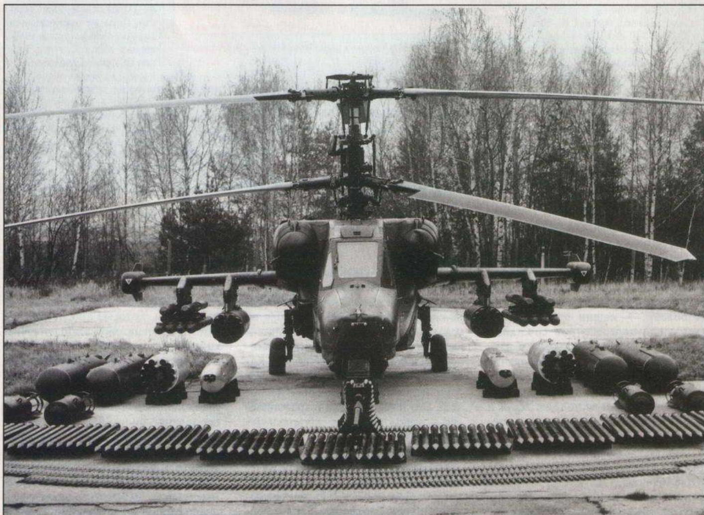
«Черная акула» с одним из вариантов вооружения: 12 ПТУР «Вихрь», 2 блока реактивных орудий Б8В20 с 40 НАР калибра 80 мм, пушка 2А42 калибра 30 мм. Перед вертолетом наземная выкладка арсенала средств поражения
