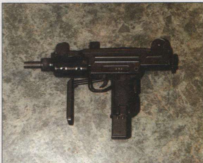
ПП «Мини-Узи» занимает промежуточное положение: одиночная стрельба из него ведется с переднего шептала, а при автоматическом огне ударник фиксируется в затворе, и стрельба происходит с заднего шептала
