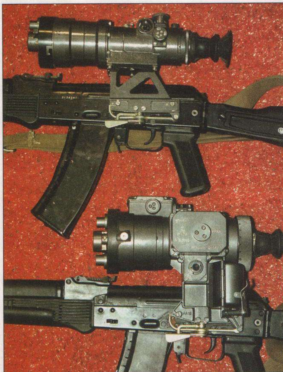
Ночные прицелы «Вепрь» (вверху) и 1PN51 на автоматах АК-74М. Хорошо заметна разница в их габаритах. На фото «Вепрь» с более ранним вариантом фильтра с регулируемой диафрагмой. При всей привлекательности возможности плавной регулировки освещенности фильтр такой конструкции в значительной степени искажает видимую картинку, особенно на периферии
