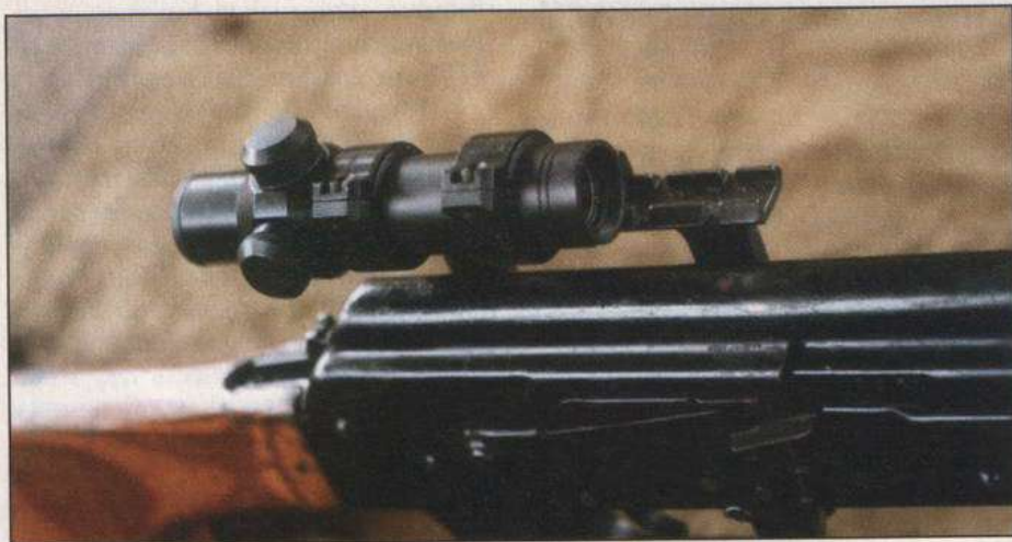
Оптический прицел ПО 3,5х17,5 может использоваться на любом оружии, имеющем планку крепления ночного прицела. Положение прицела в кронштейне регулируется
