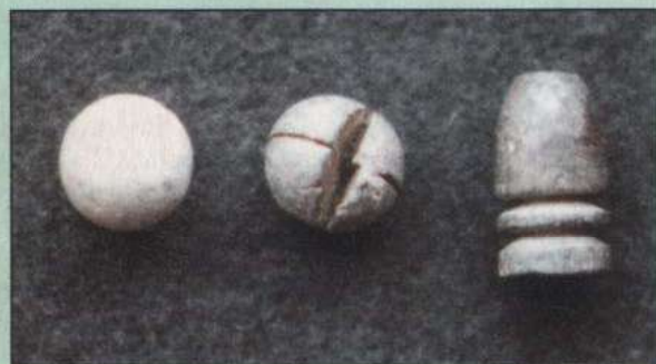
6-линейные пули к отечественным дульно-зарядным ружьям: сферическая свинцовая; сферическая свинцовая с крестообразным надрезом; конструкции Панкратова образца 1854 г.
