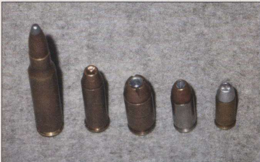
Патроны с экспансивными пулями из арсеналов киллеров: охотничий 7,62x51; полицейские .38 Спешиал, .45 АСР, 9x19 Люгер, .32 АСР
