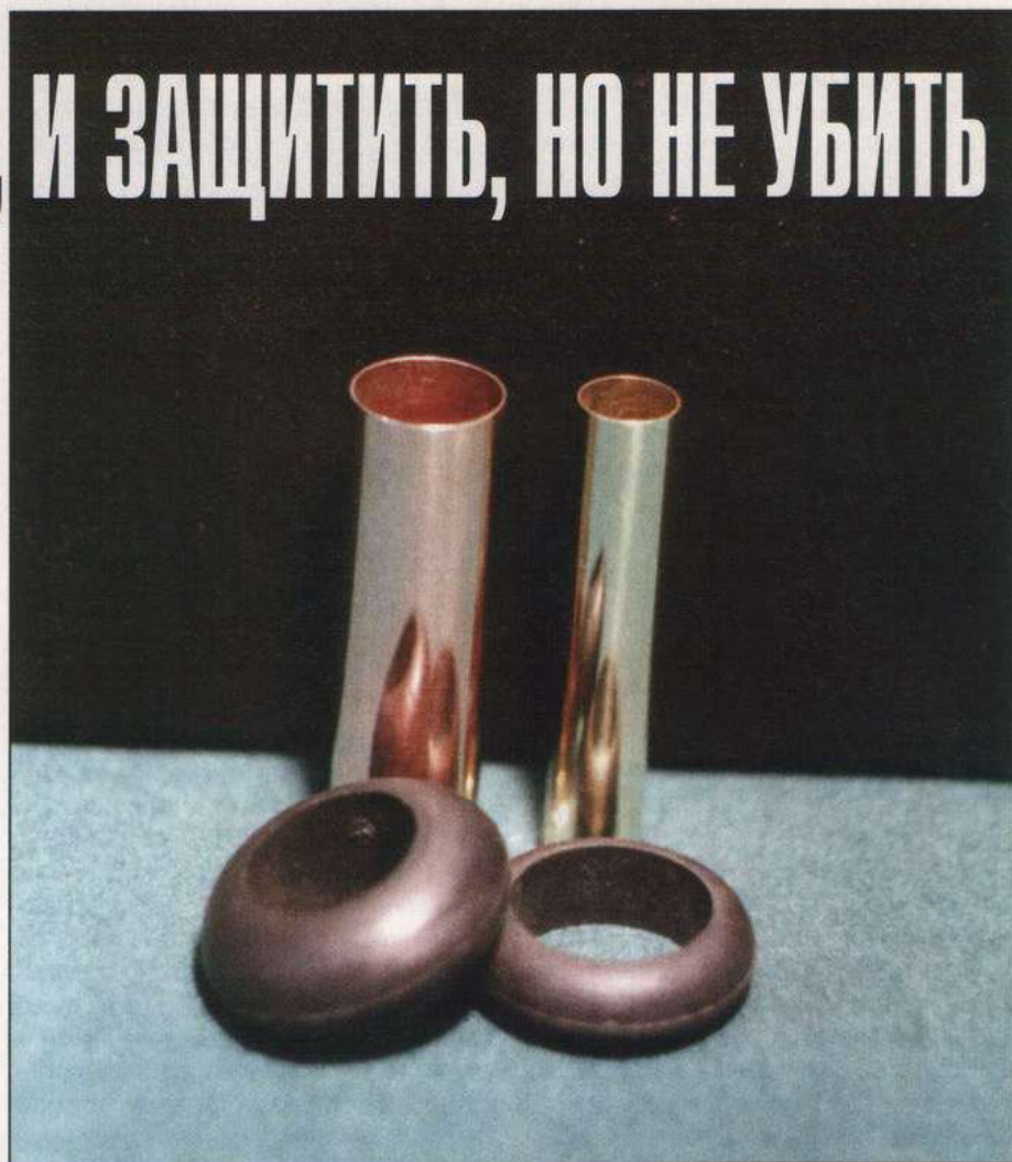
Пуля из упругого материала в недеформированном состоянии представляет собой кольцо
