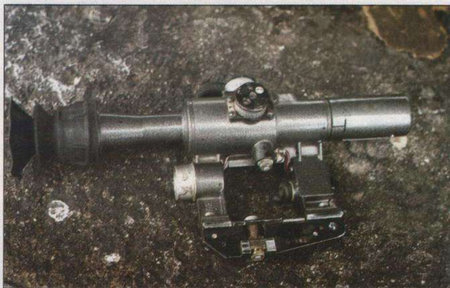
Прицел оптический снайперский ПСО-1, кроме штатного использования во многих «горячих» точках применяется и на автоматах и пулеметах, имеющих планку крепления ночного прицела
