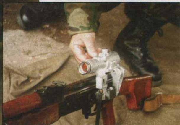
Прицел ПК-А — первый коллиматорный прицел, разработанный для войск. Время непрерывной работы — 1000 ч.
