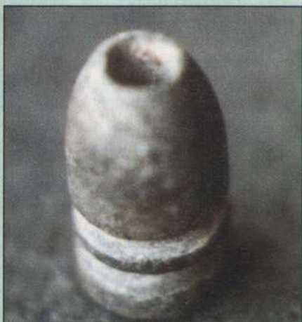
Прародительница экспансивных «дум-дум» разрывная пуля Панкротова обр. 1854 г. Видна полость, в которую помещался заряд пороха и капсюль
