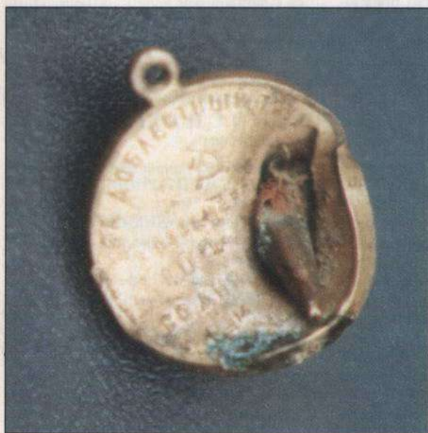
Автоматная пуля калибра 5,45 мм повела себя, как и всегда, встретив более-менее плотную преграду. Она развернулась и «разделась», то есть стальной сердечник пробил преграду и нанес смертельное ранение, а оболочка осталась вмятой в погнутую медаль. Фото В. Ольшанского
