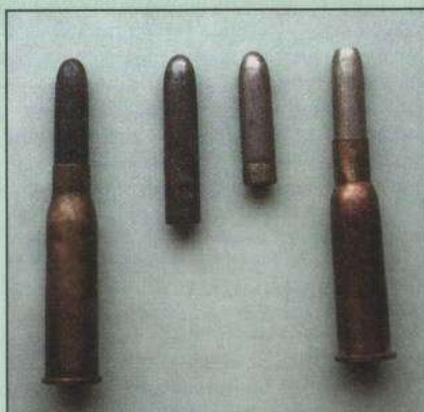
Австрийский патрон 8x50R и разрывная пуля ударного действия. Для сравнения (справа) обыкновенная пуля этого патрона. Справа — русский трехлинейный винтовочный патрон с разрывной пулей образца 1916 года
