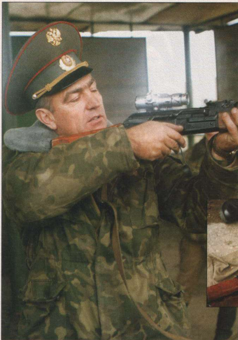
Прицел ПК-А — первый коллиматорный прицел, разработанный для войск. Время непрерывной работы — 1000 ч.
