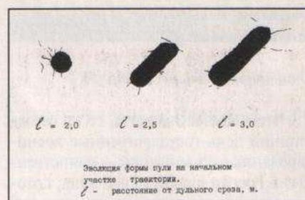
Ксерокопии следов, оставленных пулей на бумажных мишенях в последовательные моменты ее раскрытия
