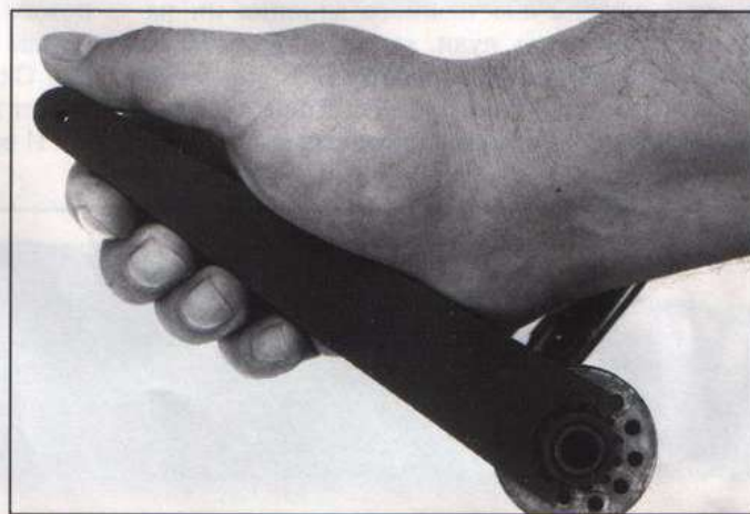
Для отделения гайки крепления ствола «Стерлинга» Mk.5 используется специальный ключ из заводского комплекта ЗИП
