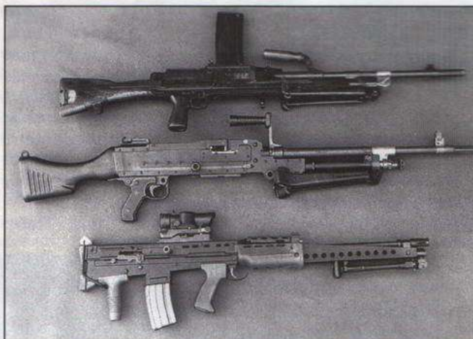
Легкое оружие поддержки калибра 5,56 мм (внизу) заменило пулемет «Брэн» Л4, переделанный под патрон НАТО 7,62x51 мм (вверху), и единый пулемет Л7А1 (выпускаемый по лицензии фирмы ФН пулемет МАГ), последний все же только в роли ручного пулемета отделения
