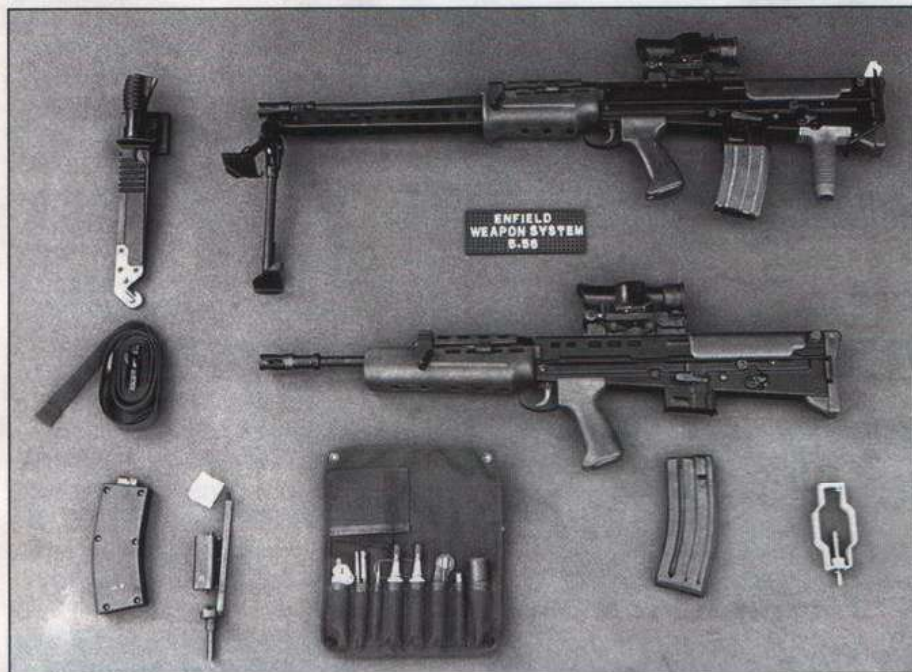
Система оружия SA80 в том виде, как она была представлена первоначально. Обратите внимание на втулку для холостой стрельбы (внизу справа), комплект для стрельбы патронами .22LR (внизу слева) и комплект для чистки (внизу в центре). Последний подвергся резкой критике
