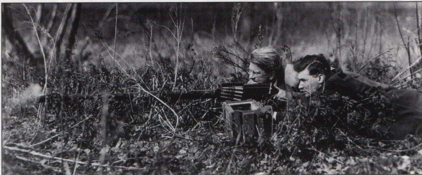
Модель 14, установленная на станке, предназначенном для пулемета калибра 7,62 мм, во время полевых испытаний. Эта модель имела два быстросменных ствола: массой 13,6 кг для стрельбы с темпом 350 выстрелов в минуту и массой 10,4 кг для стрельбы с темпом 450 выстрелов в минуту
