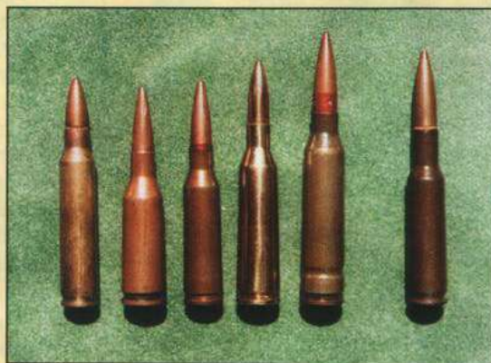
5,56-мм автоматный патрон M193 (5,56x45), США; 5,6-мм опытный автоматный патрон (5,6x39), СССР 60-е годы; 5,45-мм автоматный патрон образца 1974 года (5,45x39); 5,6-мм опытный автоматный патрон (5,6x45), СССР 60-е годы; 6-мм опытный патрон (6x49) СССР 80-е годы; 6-мм опытный патрон (6x45) США 70-е годы
