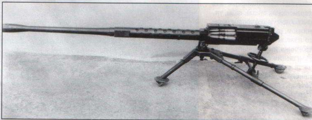
Модель 14, установленная на американском станке, предназначенном для пулемета калибра 7,62 мм. Было разработано два варианта этого оружия: авиационный пулемет и «наземный» вариант для австралийской армии
