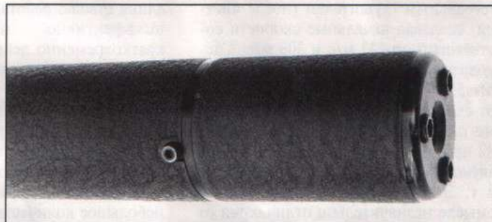
На внешнем виде глушителя Mk.5 с нижней стороны видна головка винта под торцевой шестигранный ключ, который фиксирует удлинитель глушителя. Обратите также внимание на три гайки на крышке, которые служат для крепления передней крышки к тягам внутри глушителя
