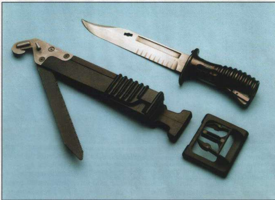
Штык пехотинца к SA80. Пластмассовые ножны имеет устройство для резки проволоки, ключ для откупоривания бутылок и универсальную пилу, но стальная рукоятка штыка не имеет изоляции
