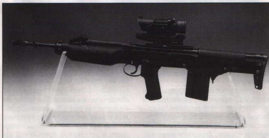
Индивидуальное оружие калибра 4,85 мм. Цевье из губчатого деформируемого материала, в отличие от принятой впоследствии конструкции из твердой пластмассы. Расположенный под большим пальцем предохранитель и защелка магазина в стиле АК — два хороших элемента, которые были утрачены при переделке
