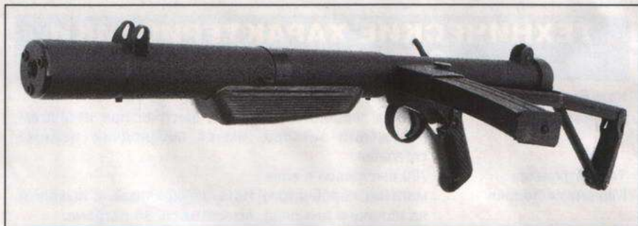
«Стерлинг» с глушителем и откинутым прикладом на 167 мм длиннее и весит на 0,8 кг больше, чем его аналог без глушителя Mk.4
