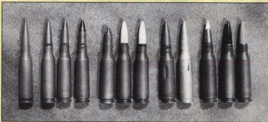
5,45-мм автоматные патроны образца 1974 года (5,45x39) 1 — опытный образец с биметаллической гильзой; 2 — с пулей со стальным сердечником; 3 — с трассирующей пулей; 4 — с уменьшенной скоростью пули; 5-7 — холостые патроны (5 — опытный); 8 — учебный патрон; 9 — макетный патрон; 10 — эталонный патрон; 11 — патрон с усиленным зарядом; 12 — патрон высокого давления
