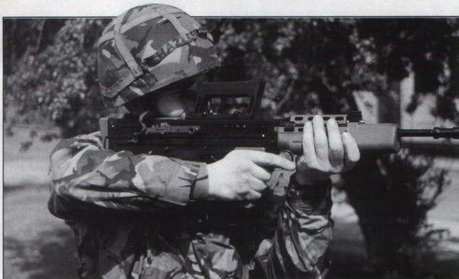
СА80 с 3-кратным оптическим прицелом, разработанным фирмой «Хеклер-Кох». Он был задуман как замена открытому прицелу, но нужно ли в этом случае увеличение?
