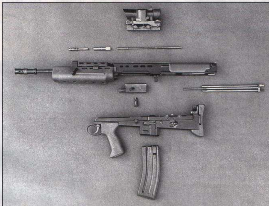
Индивидуальное оружие, вариант 1985 г., неполная разборка. Узнаете ли вы детали? Посмотрите на затвор и раму. Закон Мэрфи уже сработал, потребовав новый спусковой механизм и кожух защелки магазина. Обратите внимание на поперечно перемещающийся предохранитель
