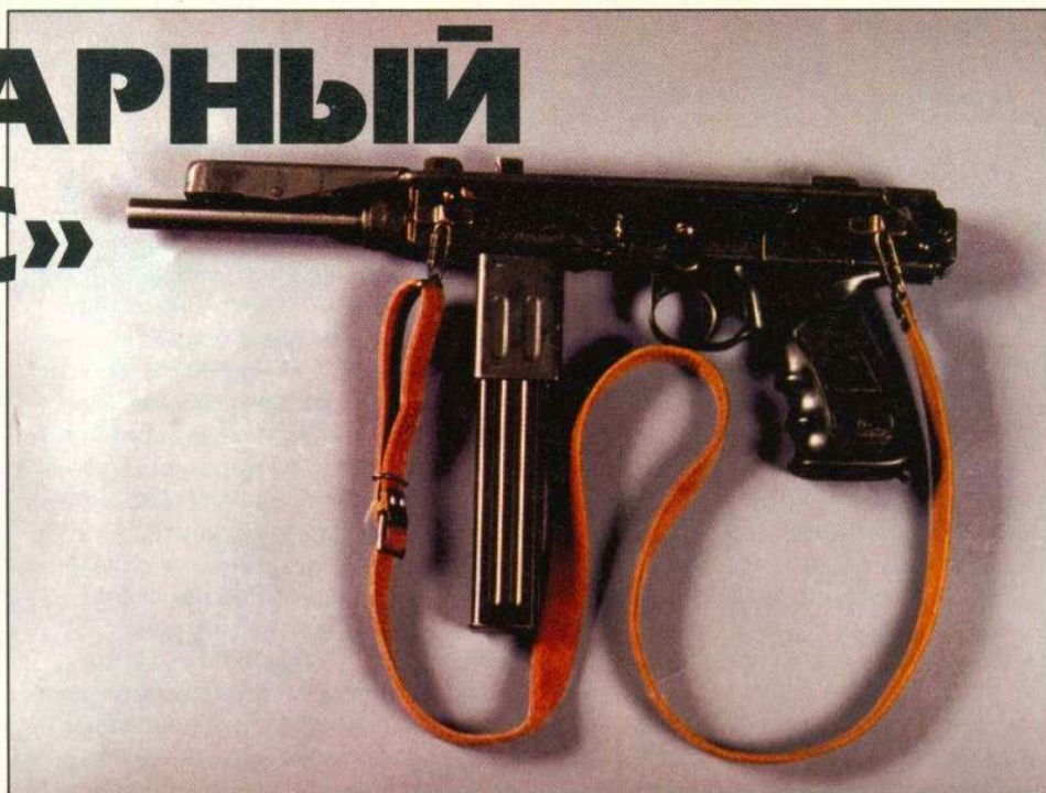
Последняя модификация с маркировкой К6-92. Детали пистолета-пулемета изготовлены из листовой стали и соединены точечной сваркой или винтами. Коробчатые магазины рассчитаны на 15 и 25 — 30 патронов
