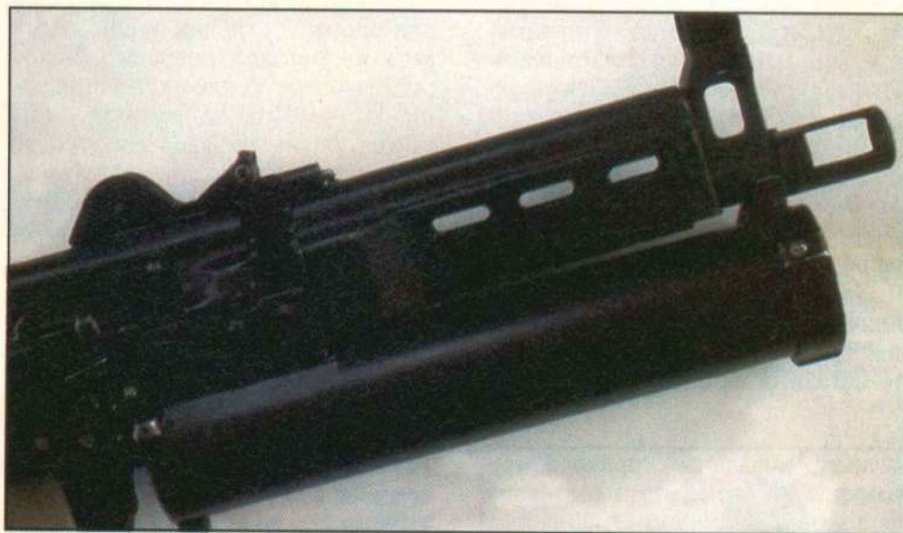
«Бизон» имеет взаимозаменяемость с АКС-74 60 процентов, он разработан под стандартный патрон к пистолету Макарова калибра 9х18 мм, а также под новый высокоимпульсный патрон того же калибра
