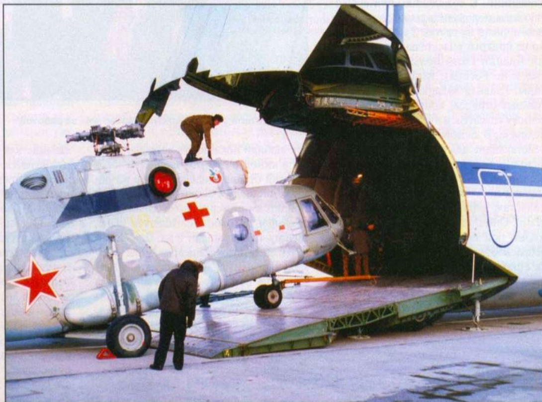
Российский самолет АН-124 «Руслан» может загрузить в свой фюзеляж два спасательных вертолета Ми-8
