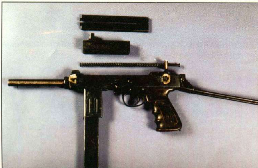
Затвор с фиксированным бойком подпирается простой спиральной пружиной на штоке
