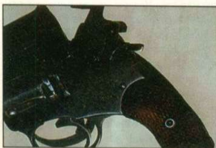
Смотреть в первую очередь следует на шлицы винтов. Если они повреждены, значит оружие разбирал непрофессионал
