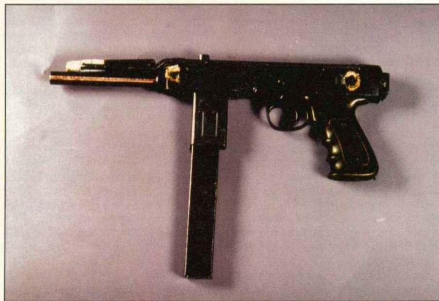
Ранний вариант с надписью «EAGLE» и пластмассовым затыльником приклада. Откидывающийся приклад эргономически не отработан, поэтому в открытом состоянии «у плеча» использовать его для прицельной стрельбы невозможно
