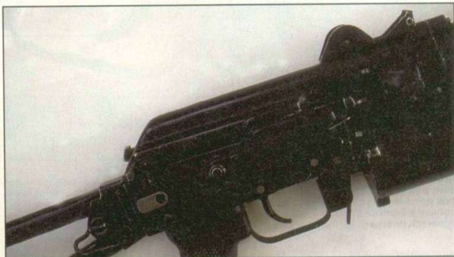
Ствольная коробка, сваренная и клепаная из листовой стали, точно такая же, как и в АКС-74, но передняя часть изменена, так как отсутствует газоотводная система. Над спусковым крючком расположен обычный переводчик АК из стального листа, создающий шум при переключении
