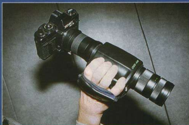
Прибор ночного видения МВ-ФС, совмещенный с фотоаппаратом. Объектив 2,8/135
