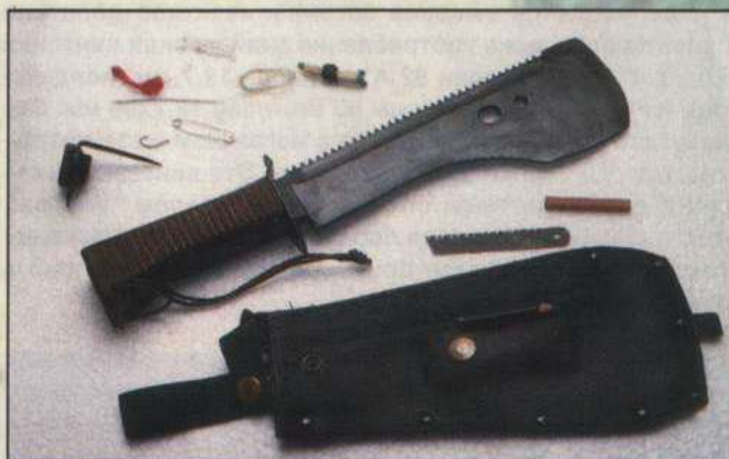
Нож-мачете "Тайга-2" используется как саперная лопатка, топор, пила, мачете, стропорез. Имеет приспособление для ломки и гибки проволоки. Может использоваться при мини-ровании, деблокировании помещений и транспортных средств, проделывании проходов, устройстве биваков и вре-менных укрытий. Фото В. Виноградова
