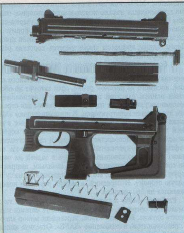
Разборка автомата «MP9» «Рюгер» в полевых условиях
