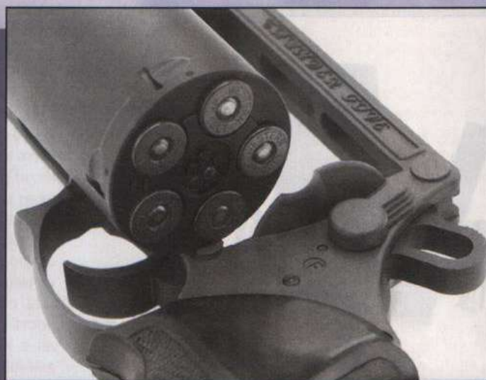
Массивный пятизарядный барабан «Грома-Пять» не имеет желобков, а патронники имеют бесплечиковую конструкцию. Обратите внимание на спусковой крючок шириной в полдюйма, на рычажок ручного предохранителя и на овальный вырез на боике
