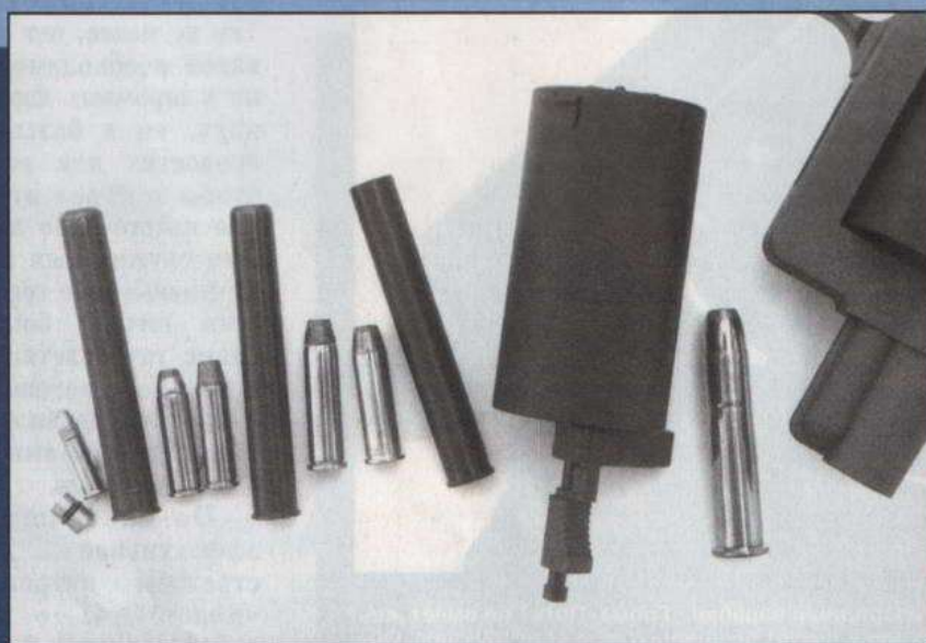
«Боеприпасы различного калибра могут быть приспособлены для стрельбы из «Грома-Пять». Слева направо: 22 «Эль Ар», 32 «Эйч энд Ар» «Магнум» и 357 «Магнум» (подкалиберный патронник 38 «Спешиал»), барабан под вставные патронники калибра 45-70
