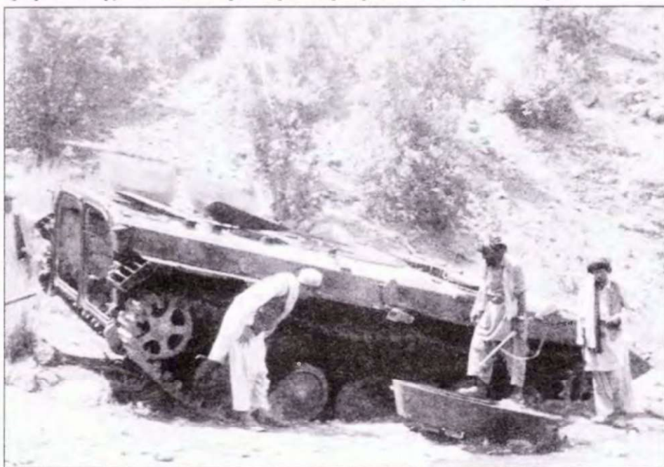
Эта БМП-1 получила прямое попадание гранатой РПГ-7 или подорвалась на mine, внутренним взрывом с машины сброшена башня. Машина камуфлирована краской каменно-серого цвета поверх штатной зеленой окраски.
