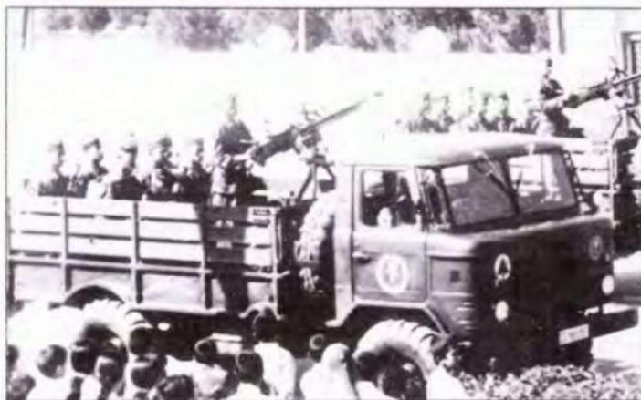
Грузовик ГАЗ-66 в СССР изобрели специально, чтобы не строить дороги. На фото - ГАЗ-66 афганской армии с опознавательным знаком конца 70-х годов на дверце кабины. В кузове установлен крупнокалиберный пулемет ДШКМ.
