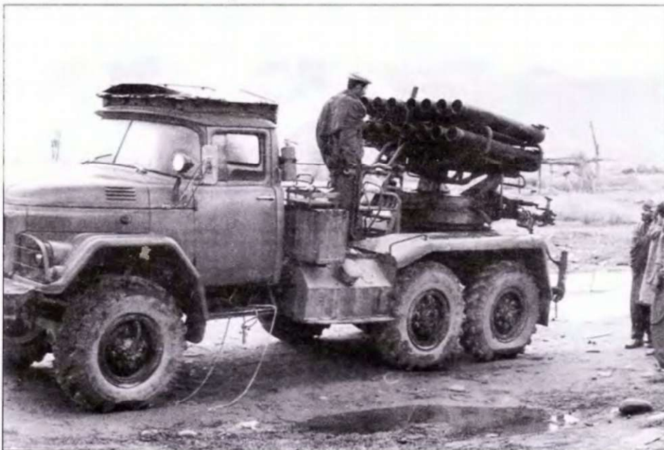
16-зарядная установка реактивной залповой системы калибра 140 мм БМ-14. Эту лишенную опознавательных знаков машину душманы захватили в Самаркеле в 1989 г. БМ-14 встречались в Афганистане нечасто.
