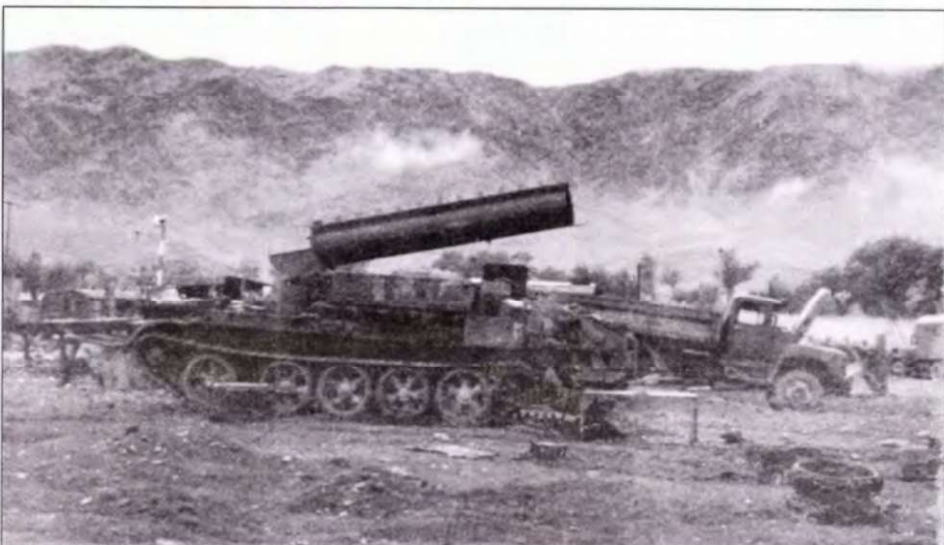
БРЭМ Т-54Т, захваченная душманами в Самаркеле в 1979 г. Труба аппаратуры подводного вождения частично поднята.
