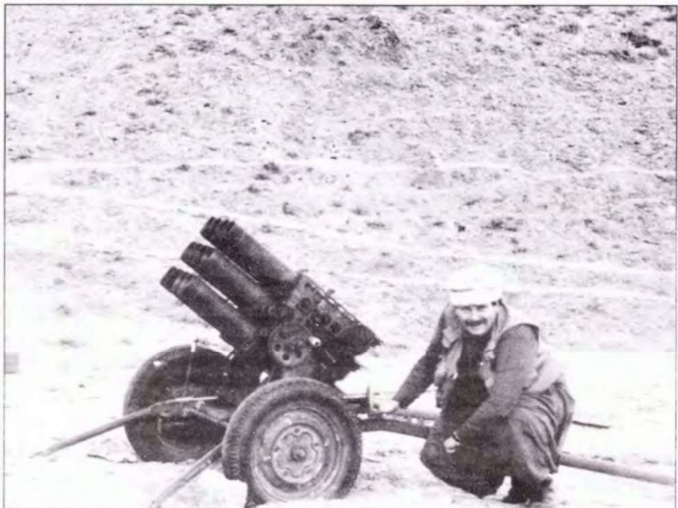
Британский щелкопер у многоствольной пусковой установки 107-мм неуправляемых ракет тип 63 китайского производства. Афганцы называли эту систему БМ-12 по количеству «стволов».
