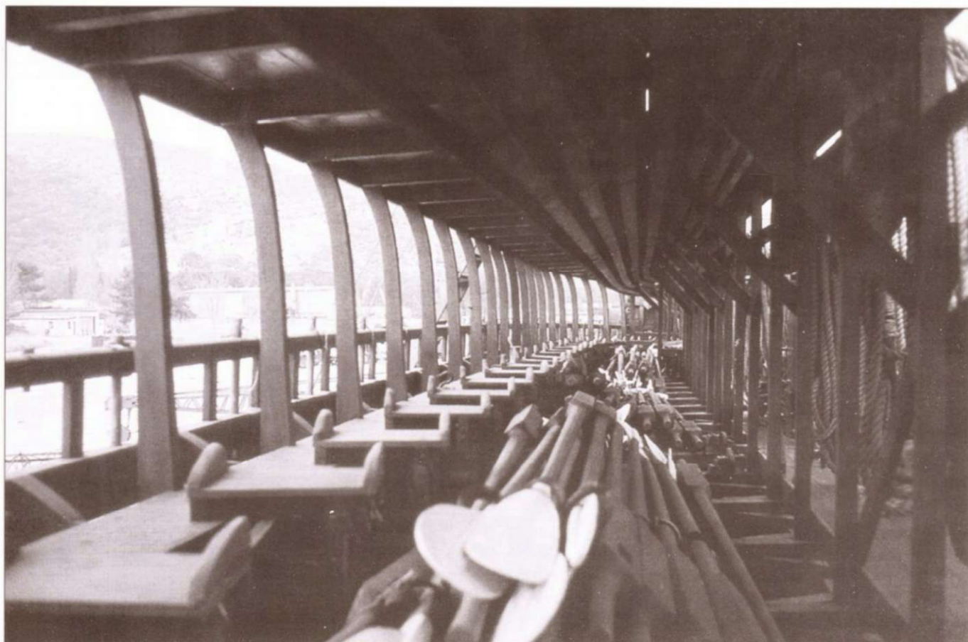
«Олимпиада», полномасштабная реконструкция афинской триремы, хорошо иллюстрирующая пространство нижней палубы и скамьи гребцов. Несмотря на то, что гребцы могли свободно дышать и имели вроде бы широкие просветы в бортах, чтобы покинуть судно, в случае аварии или атаки противника это было самым опасным местом на корабле.
