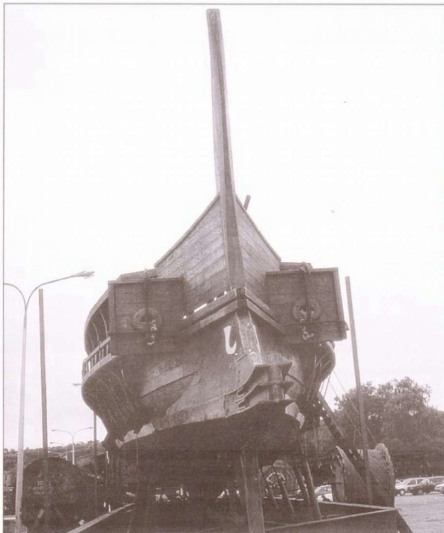
Нос «Олимпиады». Хорошо виден окованный бронзой таран - основное оружие атакующей триремы, с помощью которого утверждалось греческое господство на море. Перед самым ударом о вражеский корабль гребцам приказывали табанить весла, чтобы избежать слишком глубокого проникновения тарана в корпус вражеского судна.
