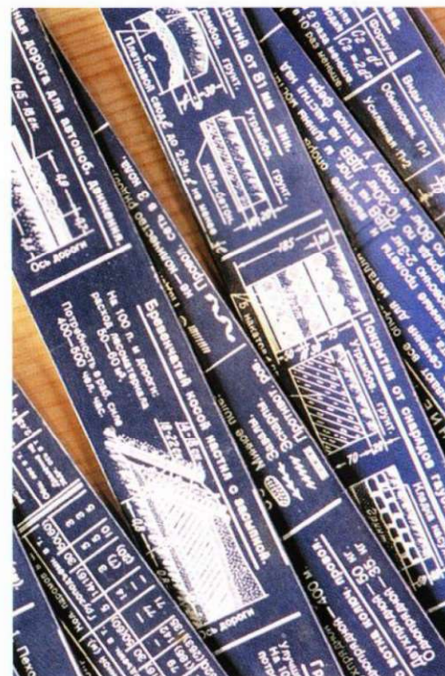
Складной офицерский метр образца 1941 г. Метр проградуирован в метрической и футовой системах, а на линейках нанесены ценные инструкции и полезные сведения вроде ширины железнодорожной колеи, толщины брони германских танков, калибры советских и германских пушек и минометов, сведения по устройству полевой фортификации и т.д.
