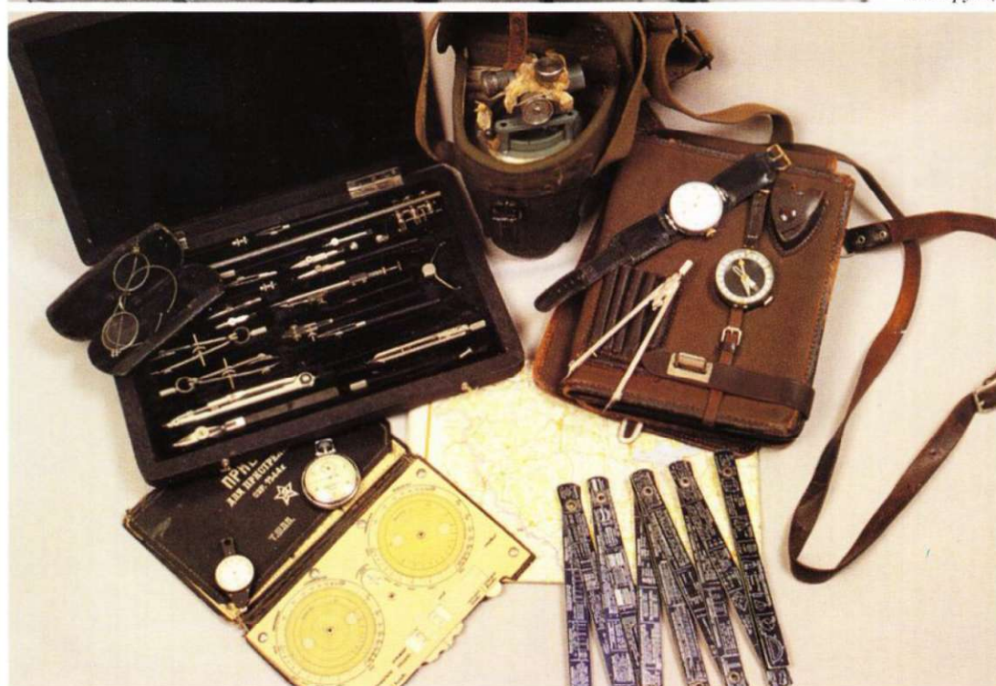
Инструменты артиллерийского или саперного офицера: готовальня, большой артиллерийский компас, планшетка с циркулем-измерителем, часами и наручным компасом, советская военная топографическая карта Венгрии, складной метр, секундомер, курвиметр, артиллерийский вычислитель.
