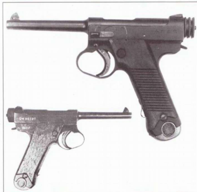
Пистолет Тайхо тип 4 был принят на вооружение в 1925 г. На двух фото приведены оба варианта - с оригинальным небольшим ограждением спускового крючка и увеличенным «маньчжурским» ограждением оного.
