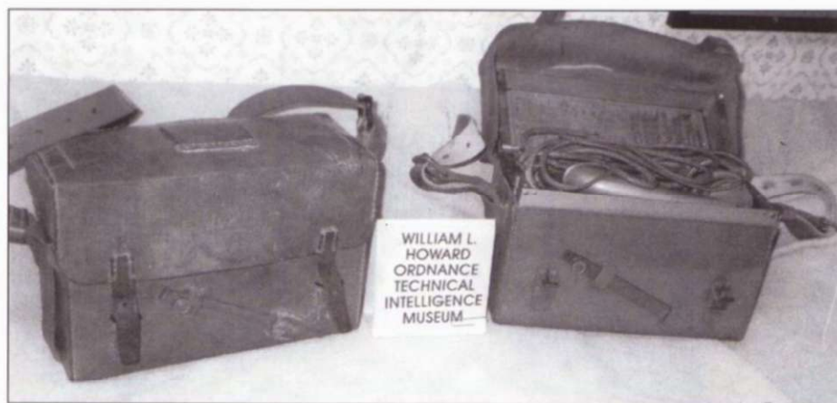
Полевой телефон тип 92 (образца 1932 г.). Телефоны интенсивно использовались на всех этапах японской армии. Японские радиостанции того времени были примитивны и ненадежны. Контейнер полевого телефона сделан из алюминия и кожи.
