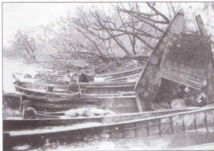
Поврежденные артобстрелом десантные баржи кохатцу длиной 9 м. Помимо военно-морского флота, десантные баржи состояли на вооружении некоторых саперных частей японской армии.
