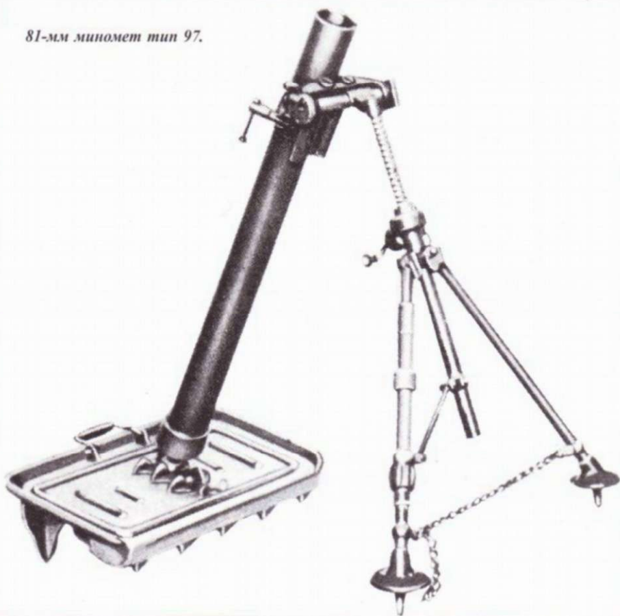
Миномет тип 97 (81 мм), «кунана шики хохейхо»
