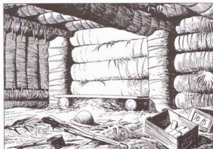
Интерьер блиндажа с огневой позицией пулемета. Стены и накат выложены из стволов палей. Такой блиндаж выдерживал прямые попадания снарядов полевой артиллерии. В подобных блиндажах было тесно, там почти всегда царила антисанитария.
