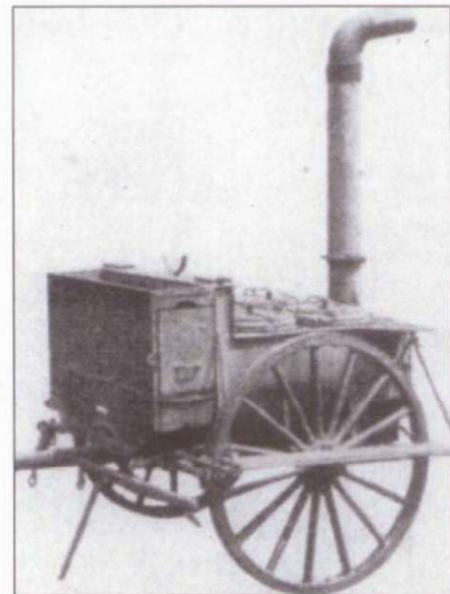
В полевых условиях японских воинов обеспечивали горячей пищей полевые кухни, состоявшие на вооружении полка. Горячее в нормальной ситуации подавалось на завтрак и обед. Такую кухню перевозили две лошади, кухня могла работать в движении.
