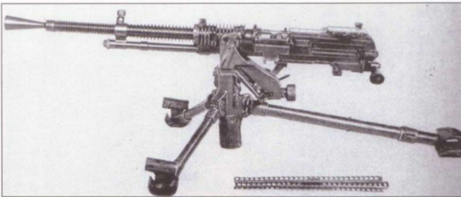
Станковый пулемет Намбу тип 1 (образца 1941 г.) калибра 7,7 мм - улучшенный вариант станкового пулемета тип 92 (образца 1932 г.). От предшественника тип 1 отличался более развитым обребрением ствола для улучшения его охлаждения. Тем не менее, пулемет часто перегревался, хотя комплектовался магазинами всего на 30 патронов (два таких магазина представлены на снимке). Скорострельность была невеликой - 400 - 500 выстрелов в минуту.
