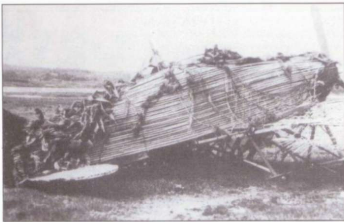
Японцы славились искусством маскировки. Этот макет самолета выстроен из бамбука, аэродром Ютан, Окинава.
