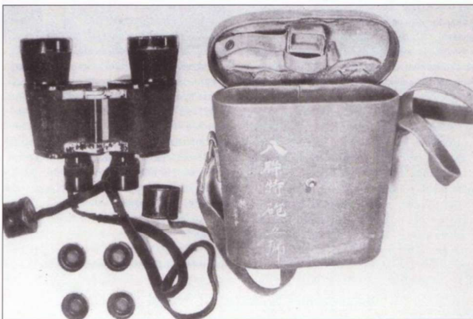
Японские оптические приборы были очень похожи на германские, как конструкцией, так и качеством изготовления. Однако, германская оптика не предназначалась для использования в тропиках, японцы же воевали, главным образом, как раз в тропиках на жаре при высокой влажности. На снимке - полевой бинокль 7x50. Бинокль снабжен цветными светофильтрами, улучшавшими видимость в лунные ночи и при туманах.
