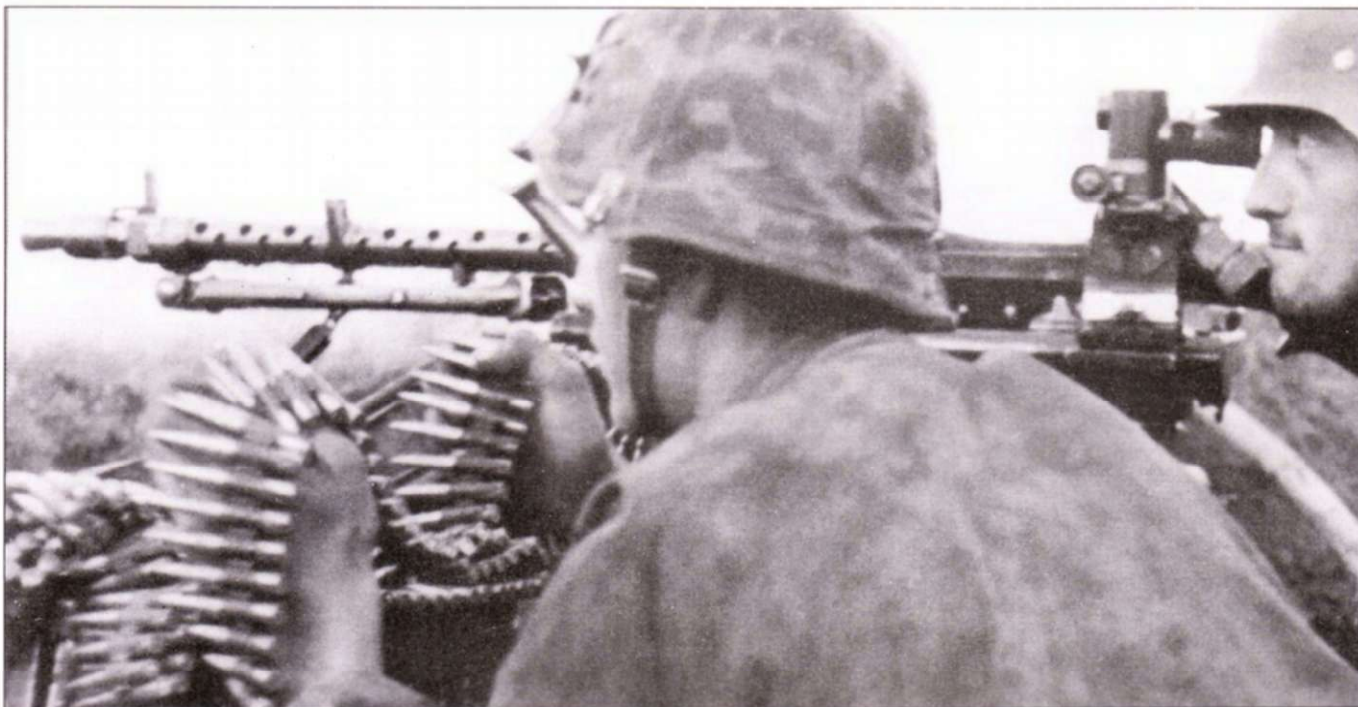
Расчет пулемета MG34, осень 1943 г. Пулемет установлен на станке образца 1934 г. и снабжен оптическим прицелом тоже образца 1934 г., к пулемету положен контейнер с запасными стволами.
