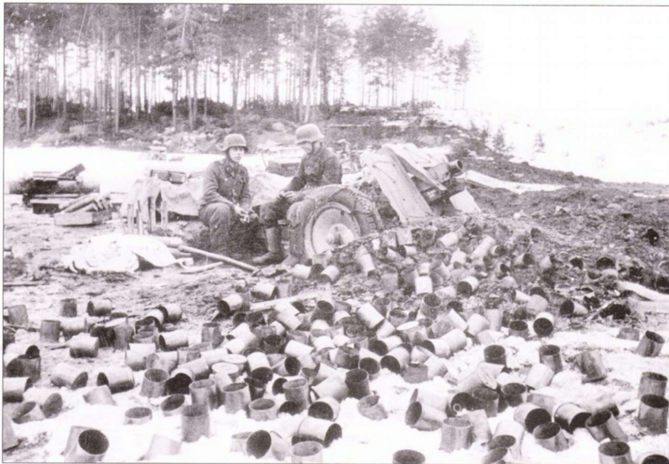
О как! Земля Нарвы загромождена тарой от снарядов, отстрелянных пушкой 7.5 см LIG18, апрель 1944 г. Обычно две таких гаубицы придавались каждому пехотному батальону. На колеса орудия приторочены цепи для лучшей проходимости. Проволока на орудийном щите предназначена для крепления маскировки.
