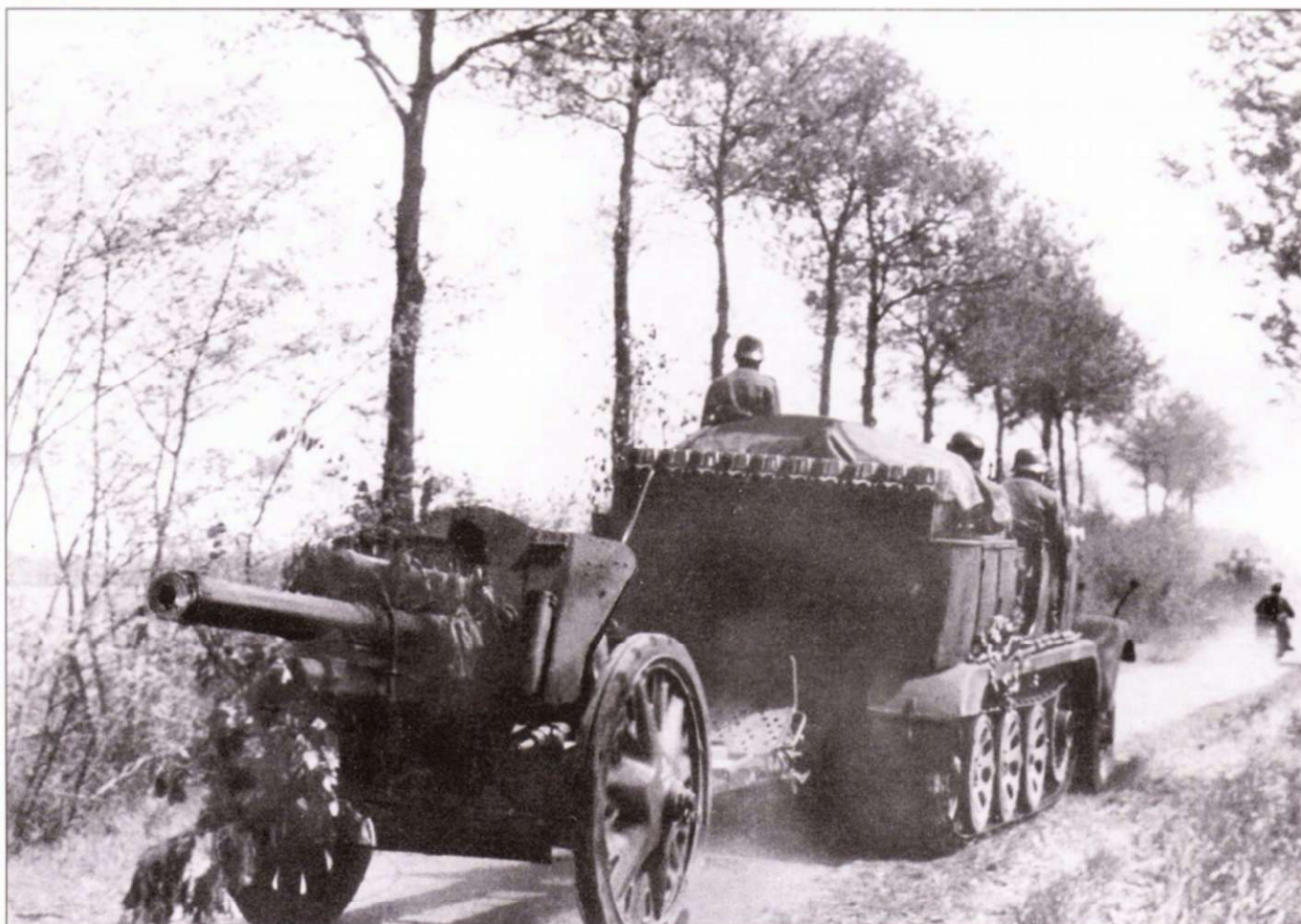
Полугусеничный тягач Sd.Kfz. 6 с орудием 10.5 см L.FH18 на прицепе. Данная гаубица являлась штатным орудием дивизионной артиллерии как в вермахте, так и войсках СС.
