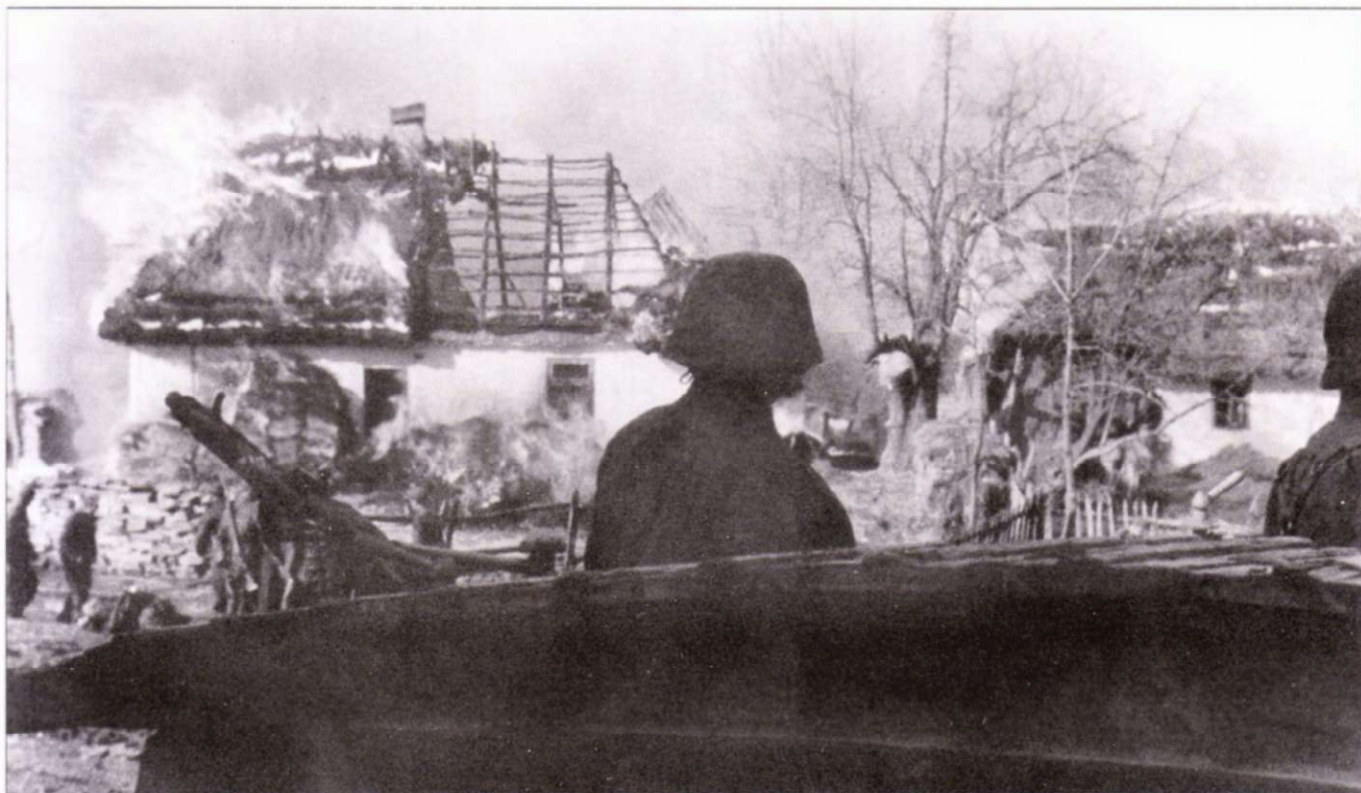
Весна 1944 г. - сожженные украинские хаты. Все как летом 1941 г., за одним исключением: германские войска движутся не на восток, а на запад. На переднем плане - саперный полугусеничный бронетранспортер Sd.Kfz. 251/7 Ausf. D, оснащенный парой 4-метровых штурмовых мостков. В задней части кузова машины установлен пулемет MG42 на зенитной турели.
