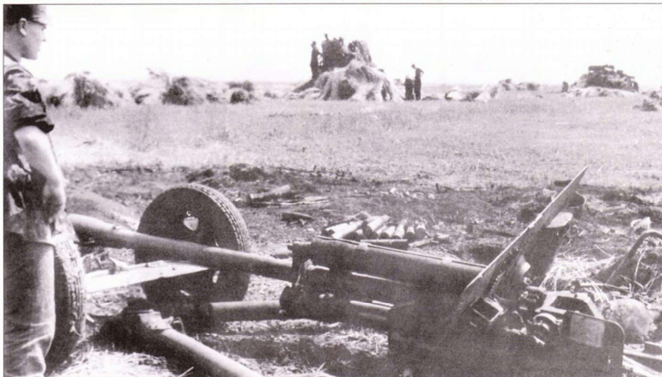
Солдат ваффен СС осматривает советскую 76,2-мм противотанковую пушку ЗиС-3, сокрушенную германским танком. ЗиС-3 являлась основным орудием советской дивизионной артиллерии и часто использовалась для борьбы с бронетехникой. На заднем плане - счетверенная зенитка 2 см Flakvierling-38 на огневой позиции. Счетверенные 20-мм пушки с большим эффектом использовались также для поражения наземных целей.
