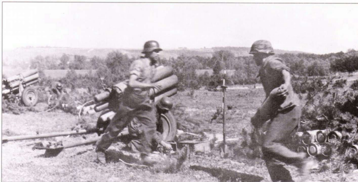
Ракетчик подразделения ваффен СС перезаряжают пусковую установку реактивного миномета 15 см Nebelwerfer 41. С одного места реактивные минометы успевали сделать не более одного - двух залпов, а потом позицию неминуемо накрывала советская артиллерия.
