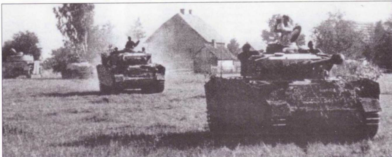
Два танка Pz.Kpfw. IV Ausf. H на марше по открытой местности, на заднем плане - полугусеничный бронетранспортер Sd.Kfz. 251 Ausf. C. Справа - командирский танк Pz.Bef.Wg. IV Ausf. H. Антенна радиостанции Fu-8 установлена в специальном гнезде по правому борту корпуса.
