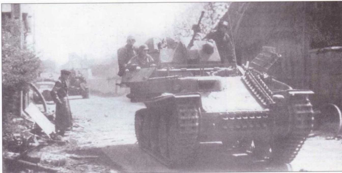
Колонна зенитных самоходно-артиллерийских установок Flakpanzer 38(t) Ausf. L (Sd.Kfz. 140) из 12-го зенитного батальона СС, район Кана, начало июня 1944 г. Всего на шасси устаревших легких танков Pz.Kpfw. 38(t) чешского производства с ноября 1943 по февраль 1944 г.г. было изготовлено 140 самоходок Flakpanzer 38(t). Зенитные самоходки состояли на вооружении частей ПВО танковых дивизий, в 12-м зенитном батальоне СС имелось восемь машин данного типа.
