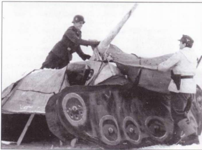
Два солдата войск СС устанавливают макет танка Pz.Kpfw. III, сделанный из дерева и ткани. Проблемой подобных макетов являлась сложность имитации следов от гусениц.
