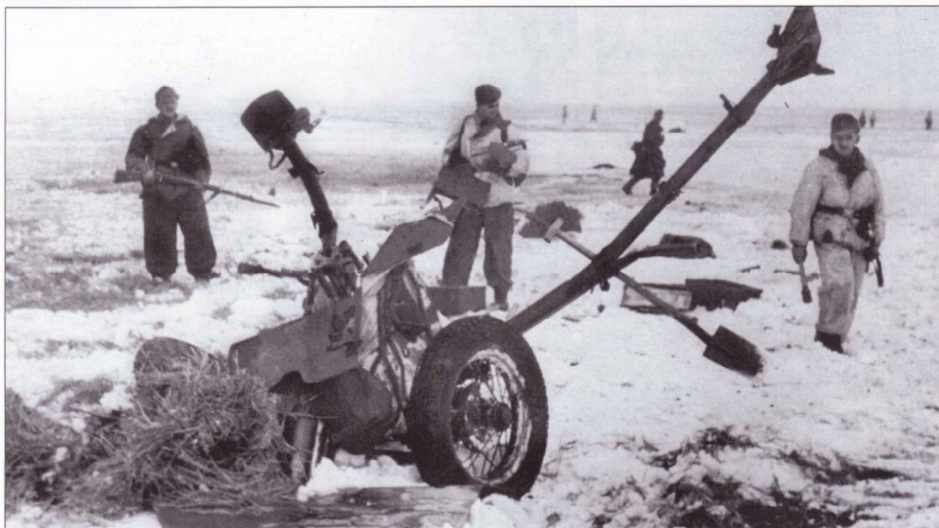
Немецкие солдаты осматривают подбитое советское противотанковое орудие калибра 45 мм. Образца 1937 или 1942 г. (с длинным стволом). Пушка представляла собой развитие лицензионного варианта германского 37-мм противотанкового орудия PaK-36/37. В СССР эти пушки известны как 37-мм противотанковые орудия образца 1930 и 1932 г.г. На лафет германского орудия советские конструкторы наложжили ствол калибра 45 мм, а боекомплект дополнили фугасным снарядам. В результате получилось довольно удачная многофункциональная пушка. В 1941-1942 г.г. германские войска захватили в исправном состоянии приличное количество советских «сорокопяток» и использовали их под обозначением 4.5 cm PaK-184(r) и 4.5 cm PaK-184/1(r).
