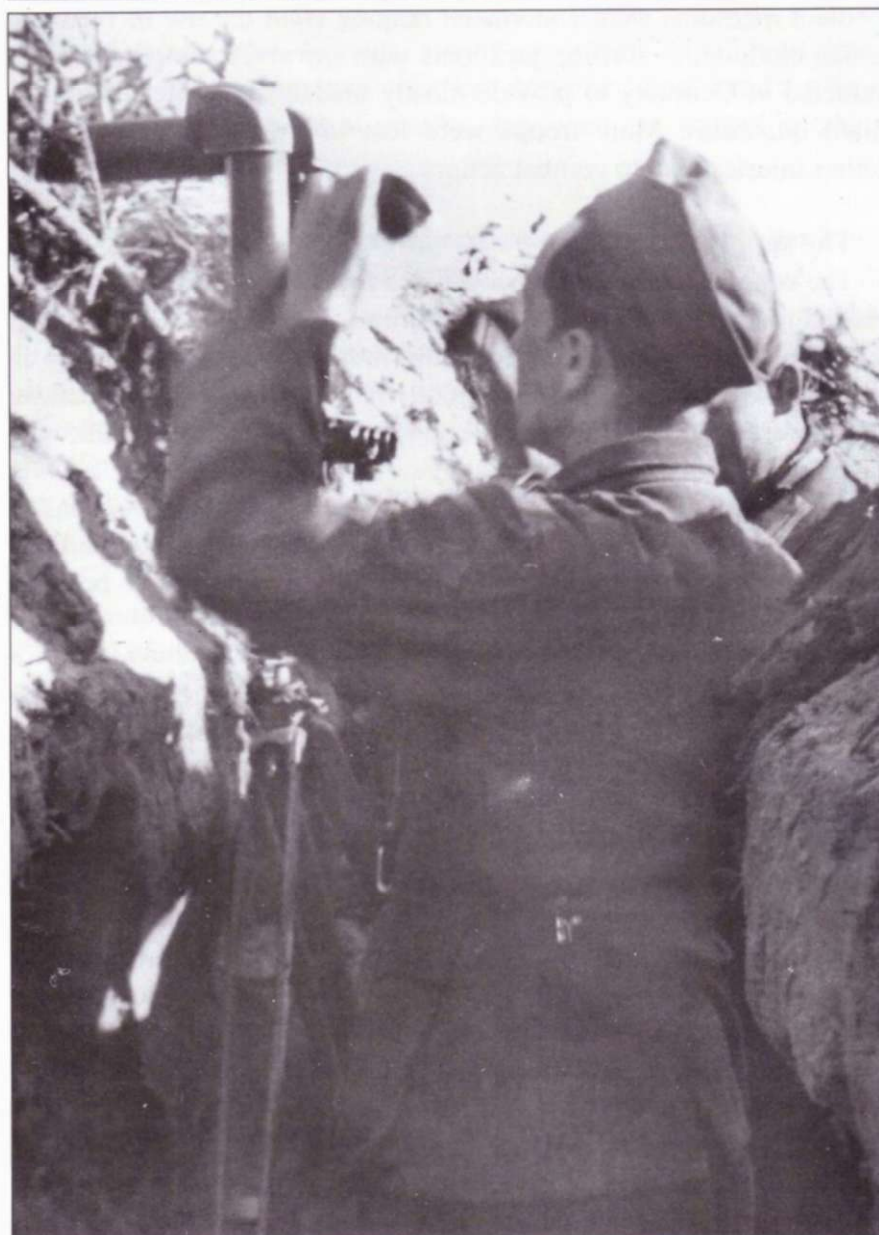
Передовой артиллерийский наблюдатель осматривает местность в стереотрубу 6х30 Sf.14Z Scherenferntrohr. В каждой артиллерийской батарее имелись такие корректировщики-наблюдатели. Корректировочные посты располагались в боевых порядках пехоты, связь поста с батареей обычно осуществлялась с помощью линии полевого телефона.
