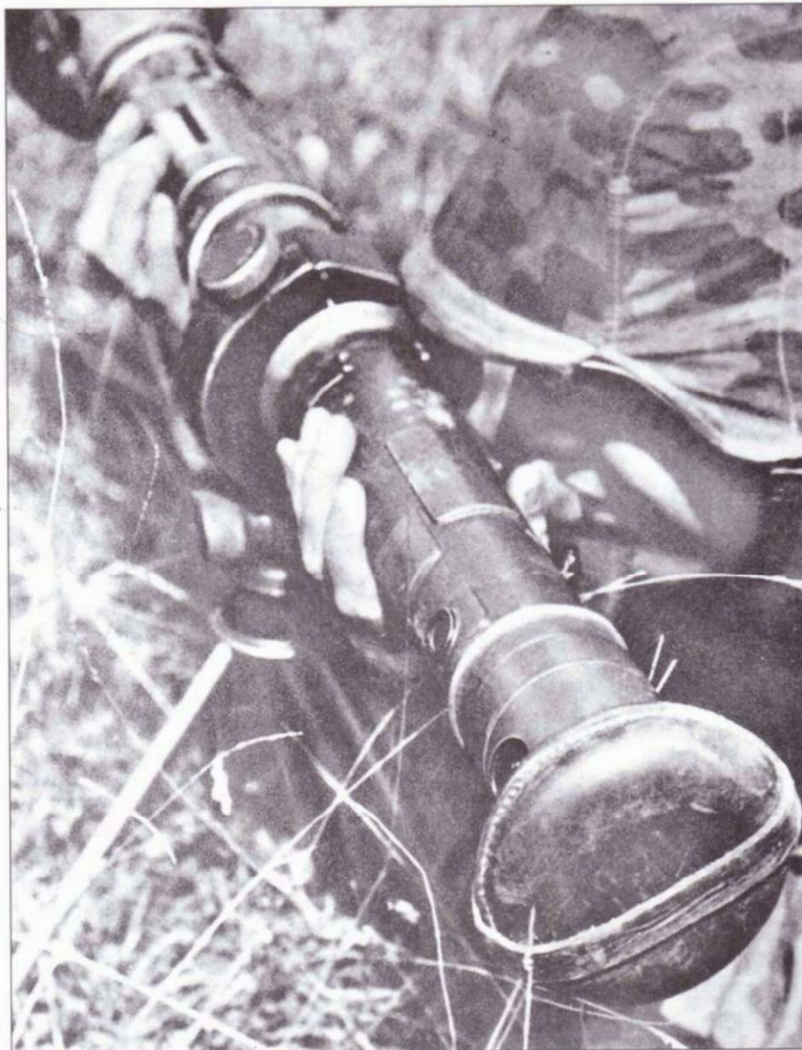
Артиллерист дивизии «Мертвая голова» корректирует огонь батареи посредством компактного оптического дальномера. Наблюдательно-корректировочные посты обязательно устраивались в прямой видимости цели. Этот наблюдатель замаскировался в высокой траве.
