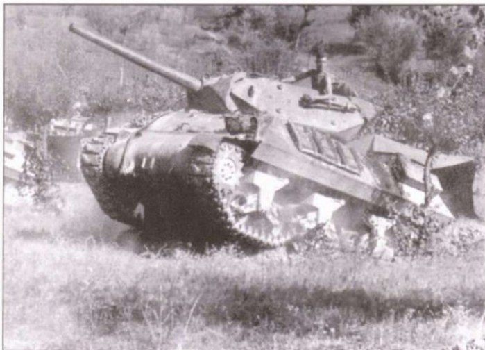
Истребитель танков M10 из взвода А III-й батареи 72-го противотанкового полка 6-й бронетанковой дивизии, долина Амо в районе Флоренции. По углам передней части корпуса наварены трубы, предназначенные для крепления маскировочной сети. 11 - 14 августа 1944 г.
