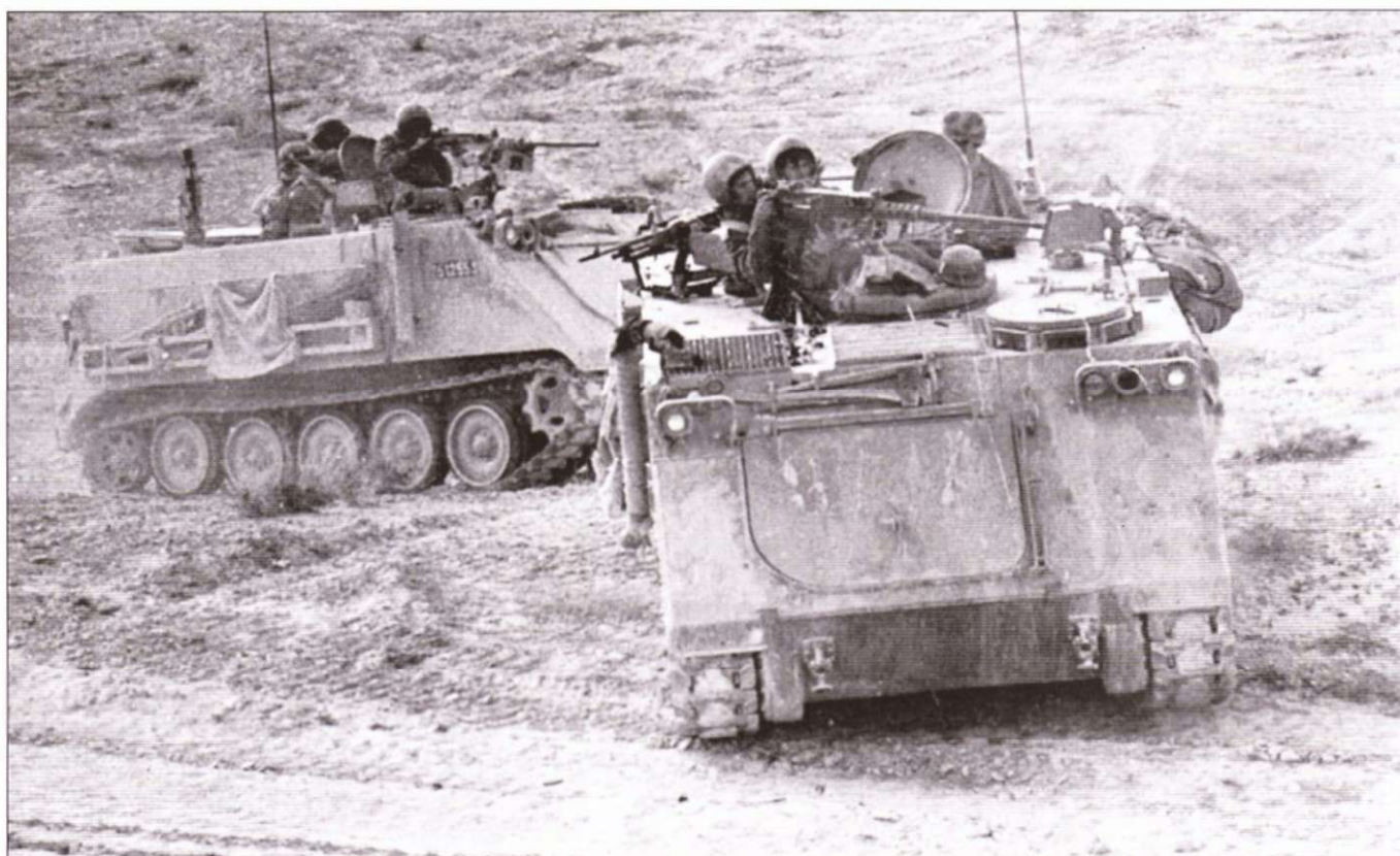
Израильские бронетранспортеры М113J в бою. Бронетранспортеры вооружены американскими 12,7-мм пулеметами и бельгийскими пулеметами FN калибра 7,62 мм. На обеих машинах отсутствуют водоотбойные щитки, но на лобовой части корпуса машины, что на переднем плане, виден привод водоотбойного щитка.
