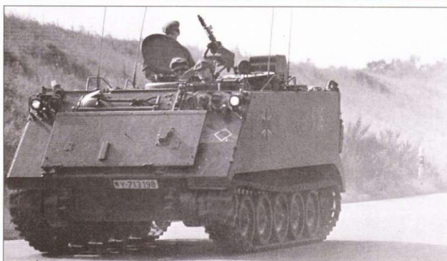
Западногерманская радиомашинка (FuF) на базе бронетранспортера М113G. Хорошо видны дополнительные радиоантенны. Дымовые гранатометы отсутствуют. Взамен американского 12,7-мм пулемета бронетранспортер вооружен германским пулеметом MG3 калибра 7,62 мм.
