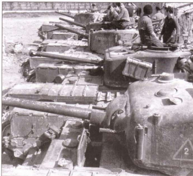
Танки «Черчилль» Северо-ирландского конного полка на огневой позиции - их иногда использовали в качестве обычной артиллерии, сектор Альфонсини-Меццано. Второй от камеры танк - «Черчилль» МК VII с башней раннего типа, но с командирской башенкой позднего выпуска. Обратите внимание на трубы, приваренные к башне танка NA-75, 21 марта 1945 г.
