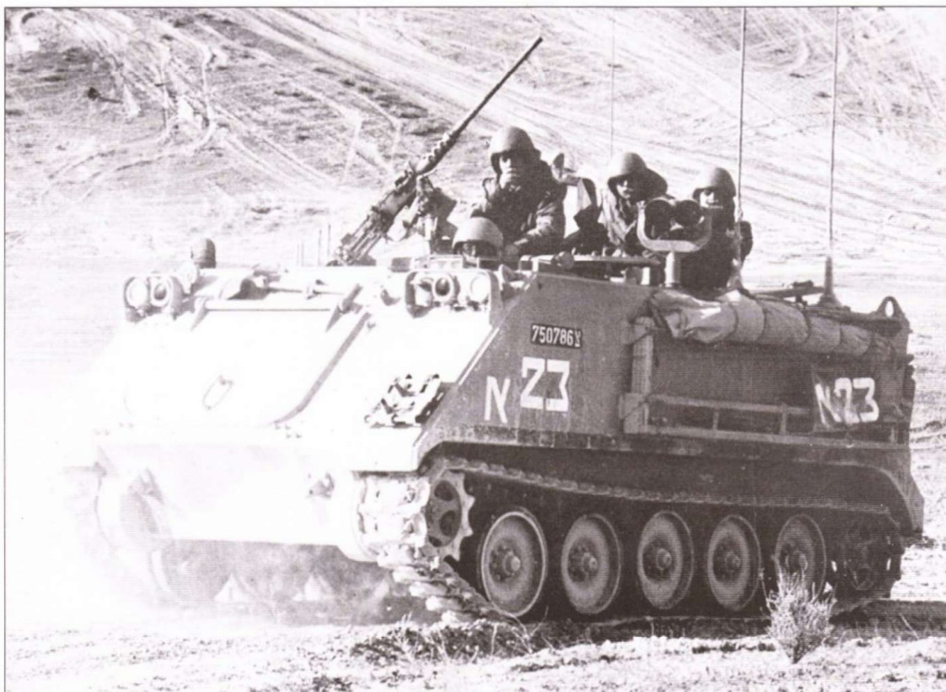
Израильский бронетранспортер М113J возвращается из боя. Маркировка на борту машины нанесена заводским способом. На машине установлен ночной бинокль.
