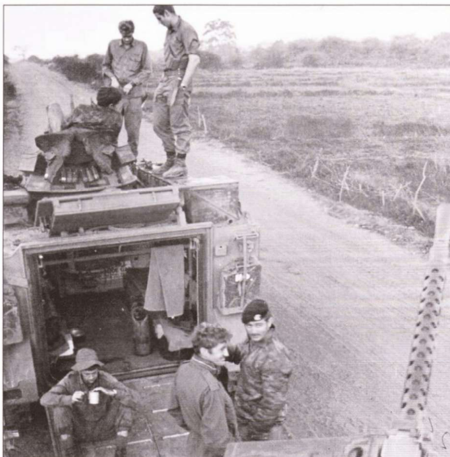
Время попить кофе или чай - австралийский бронетранспортер М113 с башенкой Кадиллак-Гэйдж, ночная засада в провинции Фоук Тай, Южный Вьетнам. На корме башенки смонтированы дымовые гранатометы, в открытом люке башенки - командир машины. На переднем плане - 7,62-мм пулемет другого бронетранспортера. Обычная практика - третий 7,62 мм в дополнение к двум башенным пулеметам того же калибра.
