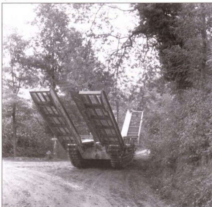
Мостоукладчик на базе танка «Черчилль» Mk II, Готская линия, 3 сентября 1944 г. Такие танки обеспечивали линейным машинам форсирование противотанковых рвов, оврагов, иных искусственных и естественных препятствий.
