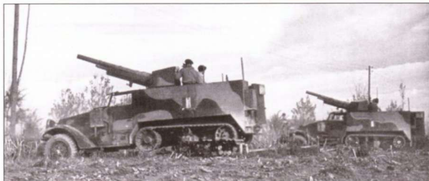
75-мм самоходные артиллерийские установки на базе полугусеничных бронетранспортеров М3 из 27-го уланского полка, район северо-западнее Меццано, 18 февраля 1945 г. Машины сохранили оригинальную грязно-оливковую однотонную окраску армии США. Видны также американские регистрационные номера. Обратите внимание на разный рисунок протектора шин передних колес. Снимок датирован 18 февраля 1945 г.
