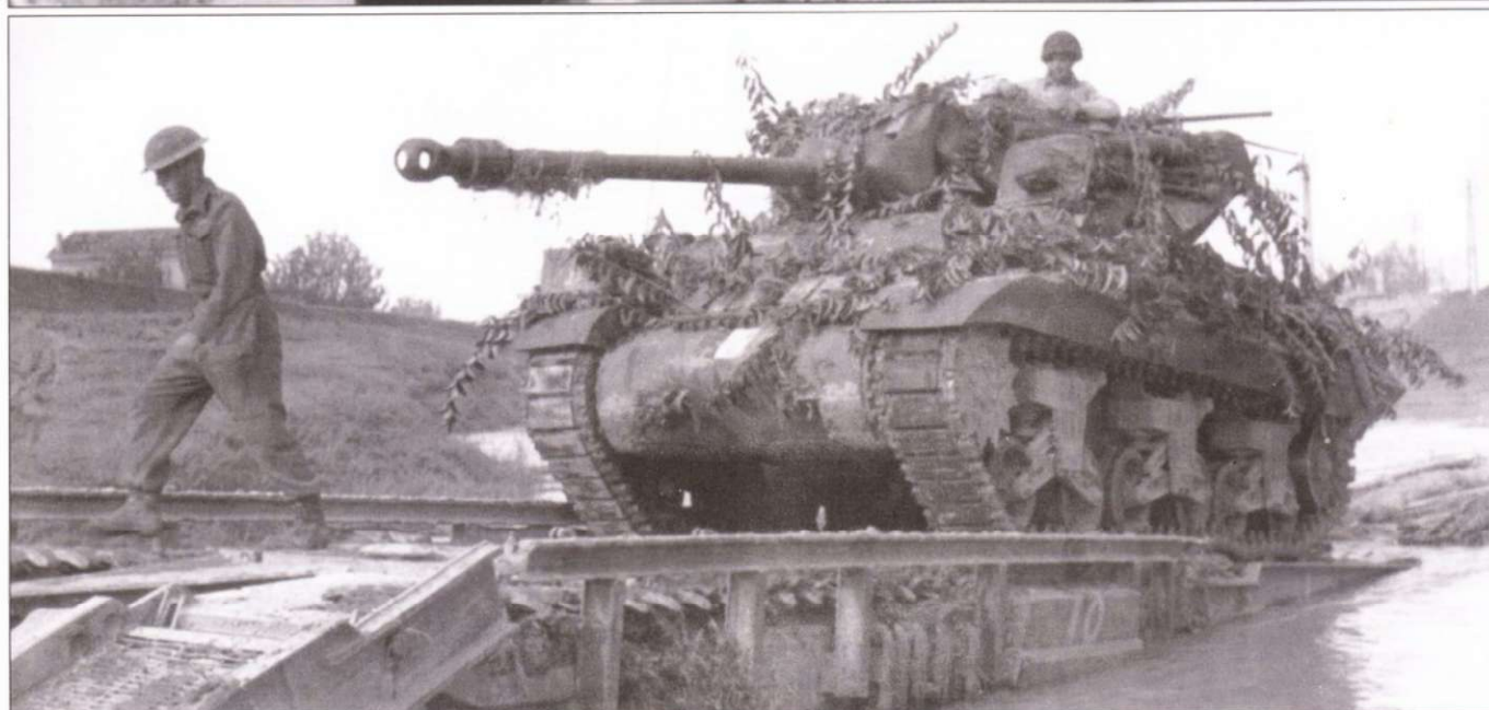
Основательно замаскированная ветками 17-фунтовая самоходная гаубица над рекой Савио, 24 октября 1944 г. Хорошо виден корпус танка-мостуукладчика «Черчилль».
