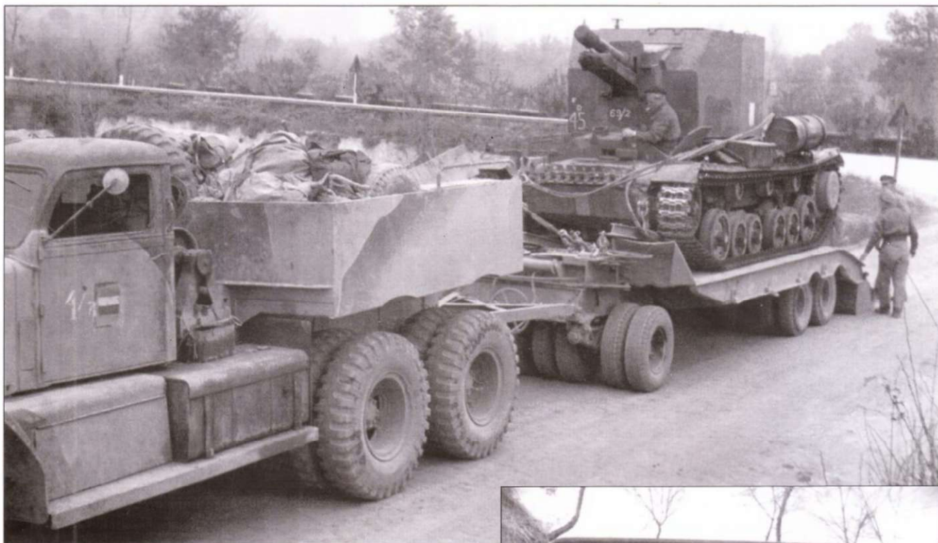
Самоходка «Бишоп» из 142-го полевого полка Королевской артиллерии на транспортёре «Даймонд Т» 610-й тяжелой эвакуационной секции. Камуфлированы и самоходка, и тягач. Снимок сделан 23 декабря 1943 г.
