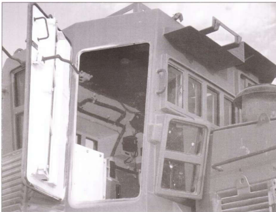
Бронестекла кабины бронебульдозера Катерпиллер D9 L. Камни и даже пули выдерживают такие стекла!
