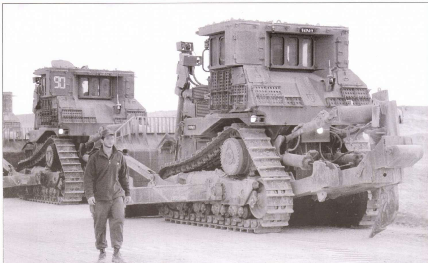
Массивная все же машина - монстр в два человеческих роста высотой. В левой части задней стенки кабины бульдозера D9 R сделан аварийный люк.
