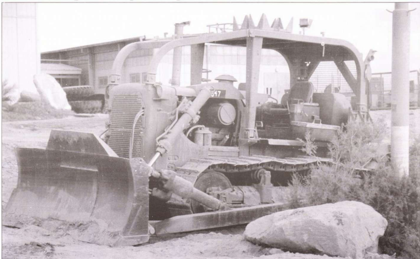
Устаревший, но все еще пригодный для использования вне зоны боевых действий бульдозер Катерпиллер D7.
