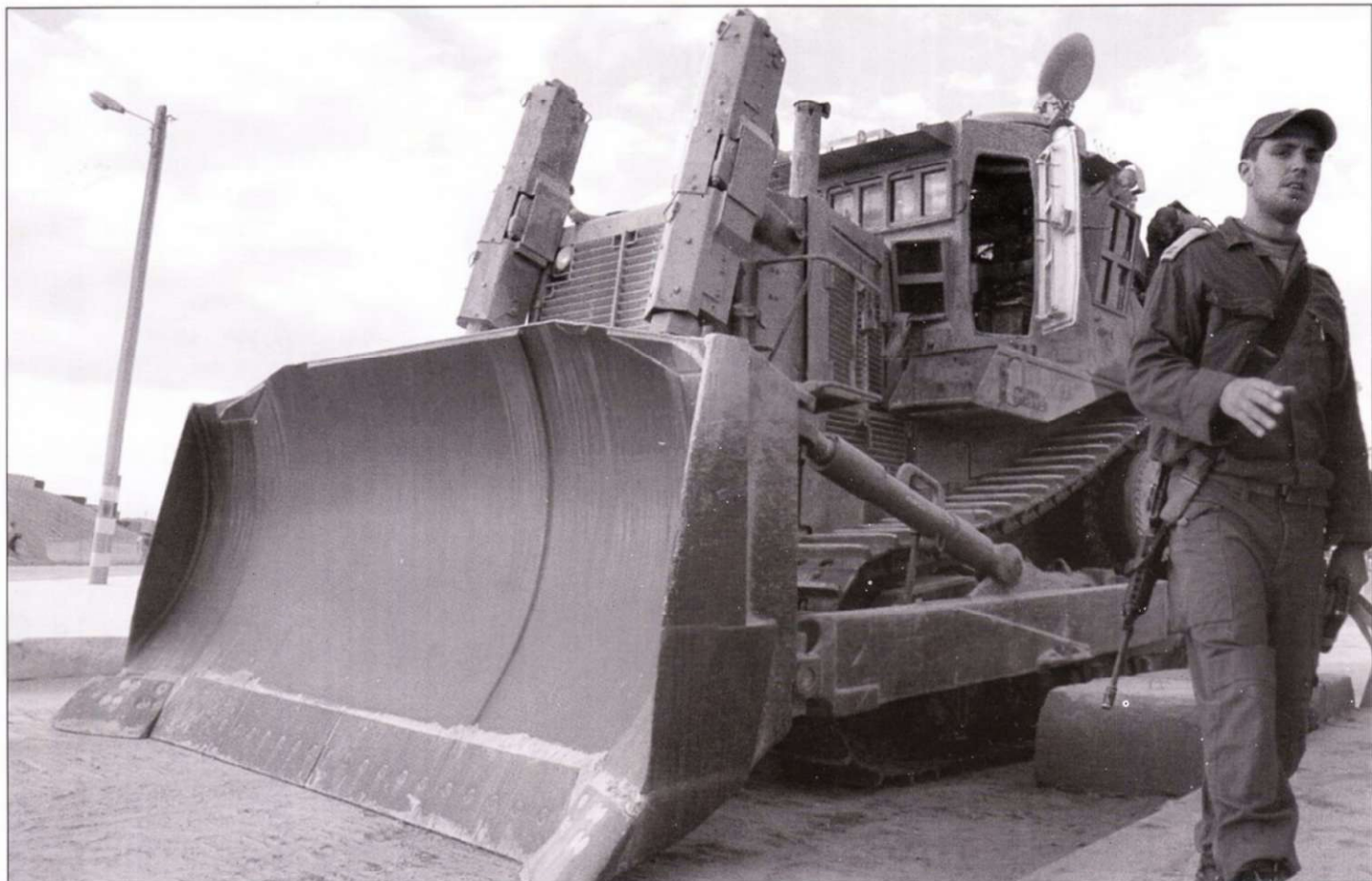
Помимо кабины и двигателя, броней у этого трактора D9 L «Дабл» закрыты гидродъемники.
