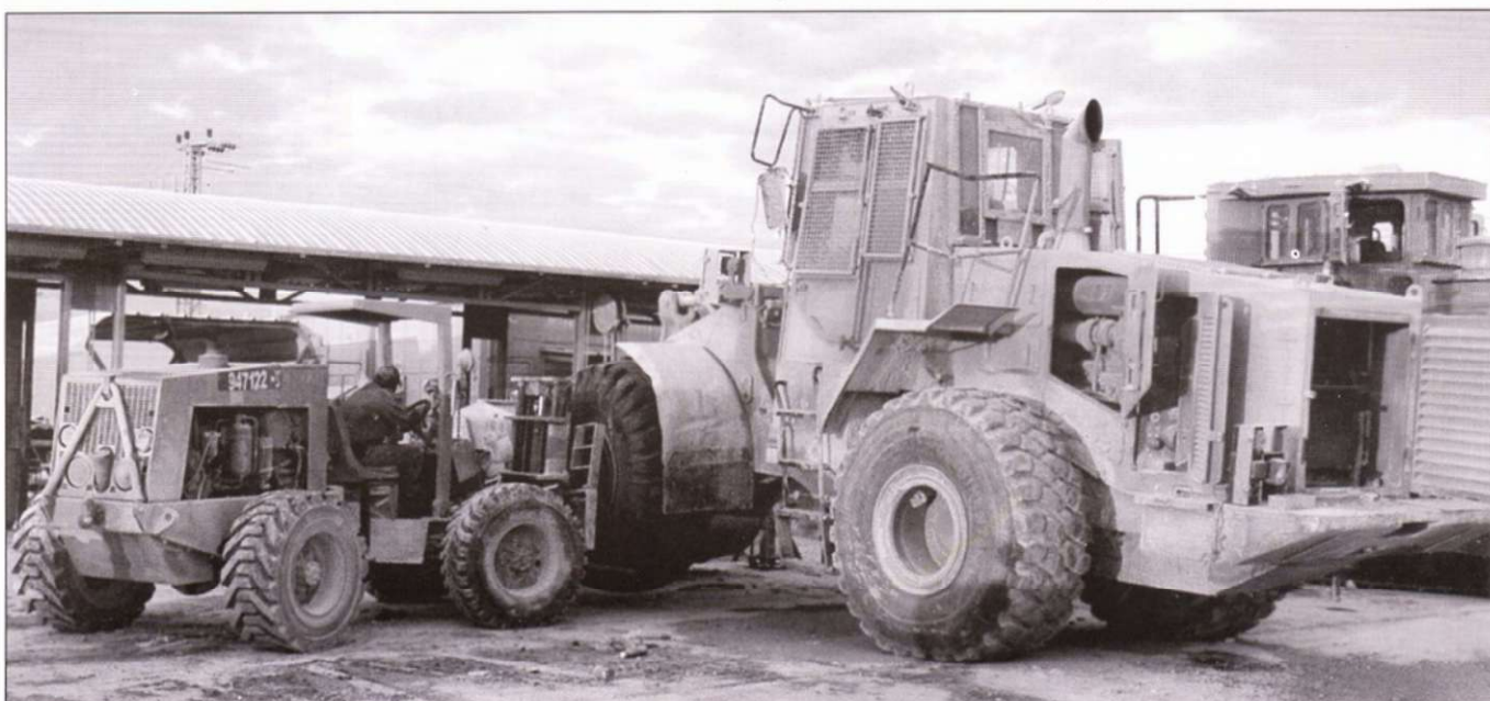
Колесный трактор Катерпиллер 966G также используется вдали от полей сражений. Трактор, гидродъемник которого поднимает колесо Катерпиллера, дает представление о размерах Трактора! Окна бронированной кабины тракториста забраны металлических сетками для защиты от палестинских вандалов, которые стремятся запустить в стекла посторонними предметами, то есть булыжниками.
