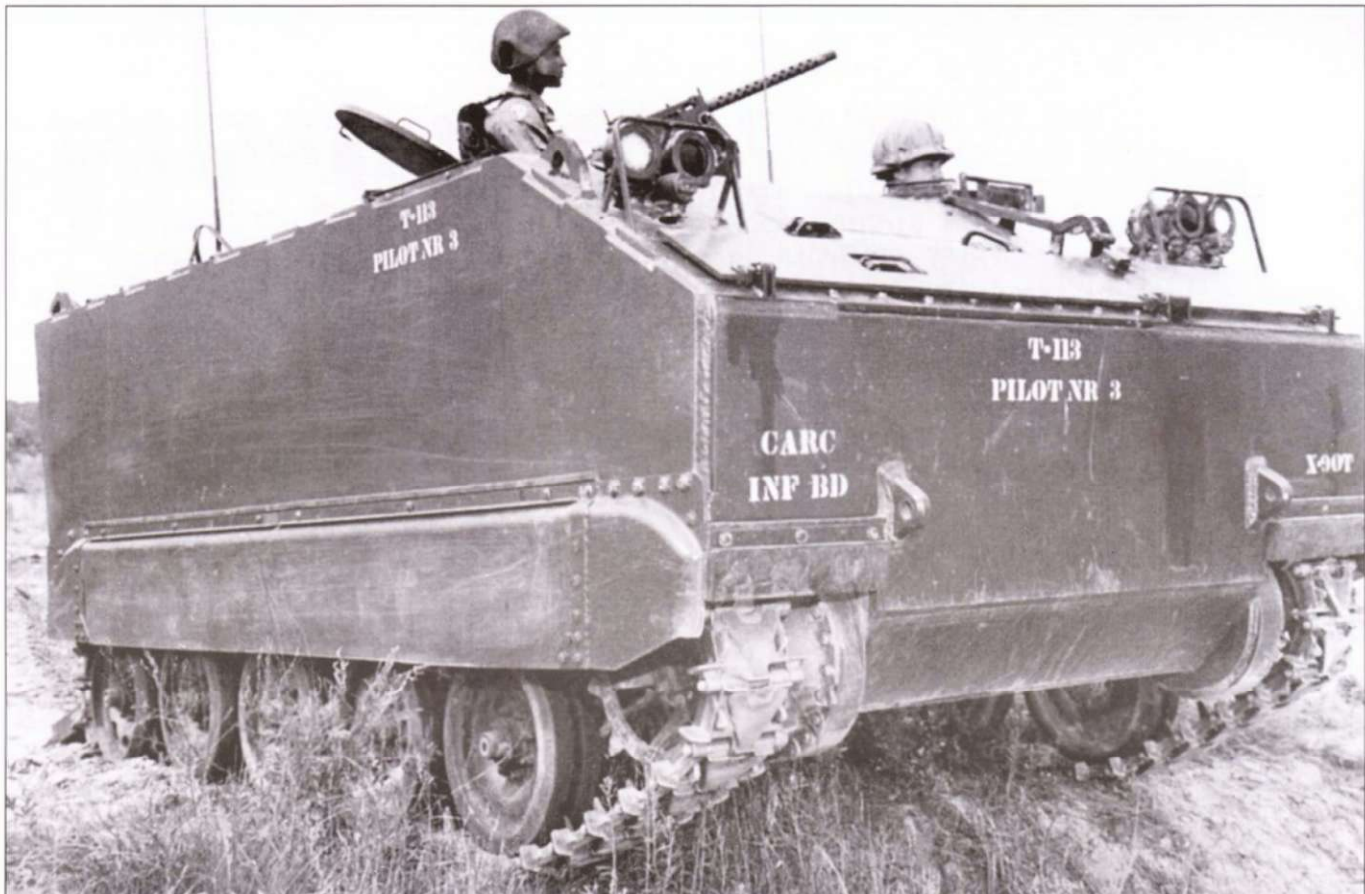
Третий прототип экспериментального бронетранспортера T113 на испытаниях в Форт-Беннинге. Бронетранспортеры T113 и T117 были изготовлены согласно техническому заданию, выданному армией США. Для полномасштабного проектирования с последующим запуском в серийное производство военные выбрали T113, в серию машина T113E1 пошла под обозначением M113.
