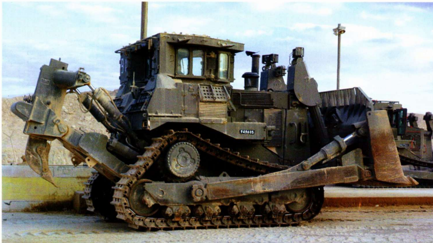
Бронированный бульдозер Катерпиллер D9 R «Даби». Обратите внимание на треугольную конфигурацию гусеницы трактора. Такая конфигурация объясняется необычной ходовой частью - ведущее колесо вверху, ленивцы - внизу спереди и сзади. Бульдозеры Катерпиллер D9 R Армии Обороны перекрашены из желтого гражданского в серо-оливковый военный цвет.
