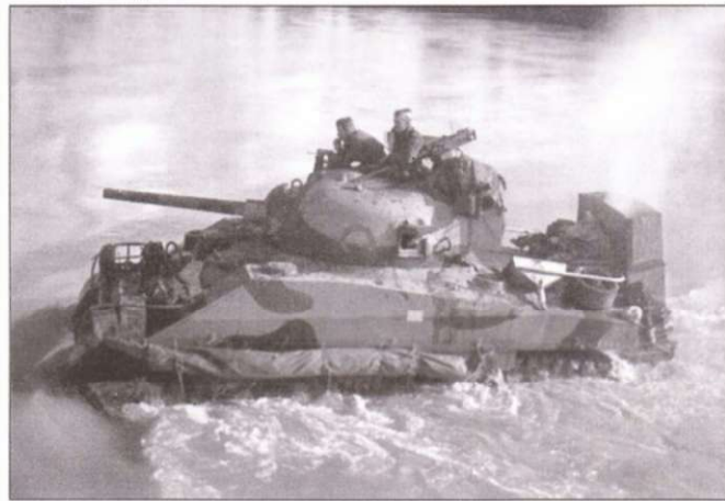
Еще один «Шерман» из 4-го Лондонского полка в водах реки Вольтюрно. Танк оснащен оборудованием для форсирования водных преград по дну. Обратите внимание на рисунок камуфляжа. 17 октября 1943 г.
