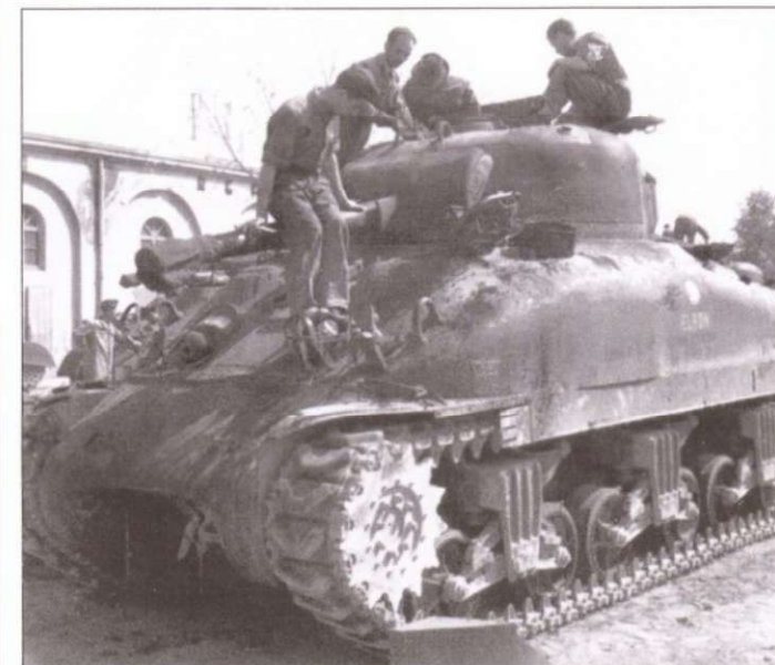
Ремонтные работы на танке «Шерман II» с собственным именем «ELBOW». Типичны отличия позднего «Шермана» - литой корпус, угловатый колпак трансмиссии. Фотография датирована апрелем 1944 г., но, судя по остаткам транспортировочной маркировки, машину не могли доставить в Италию ранее 1 мая 1944 г.
