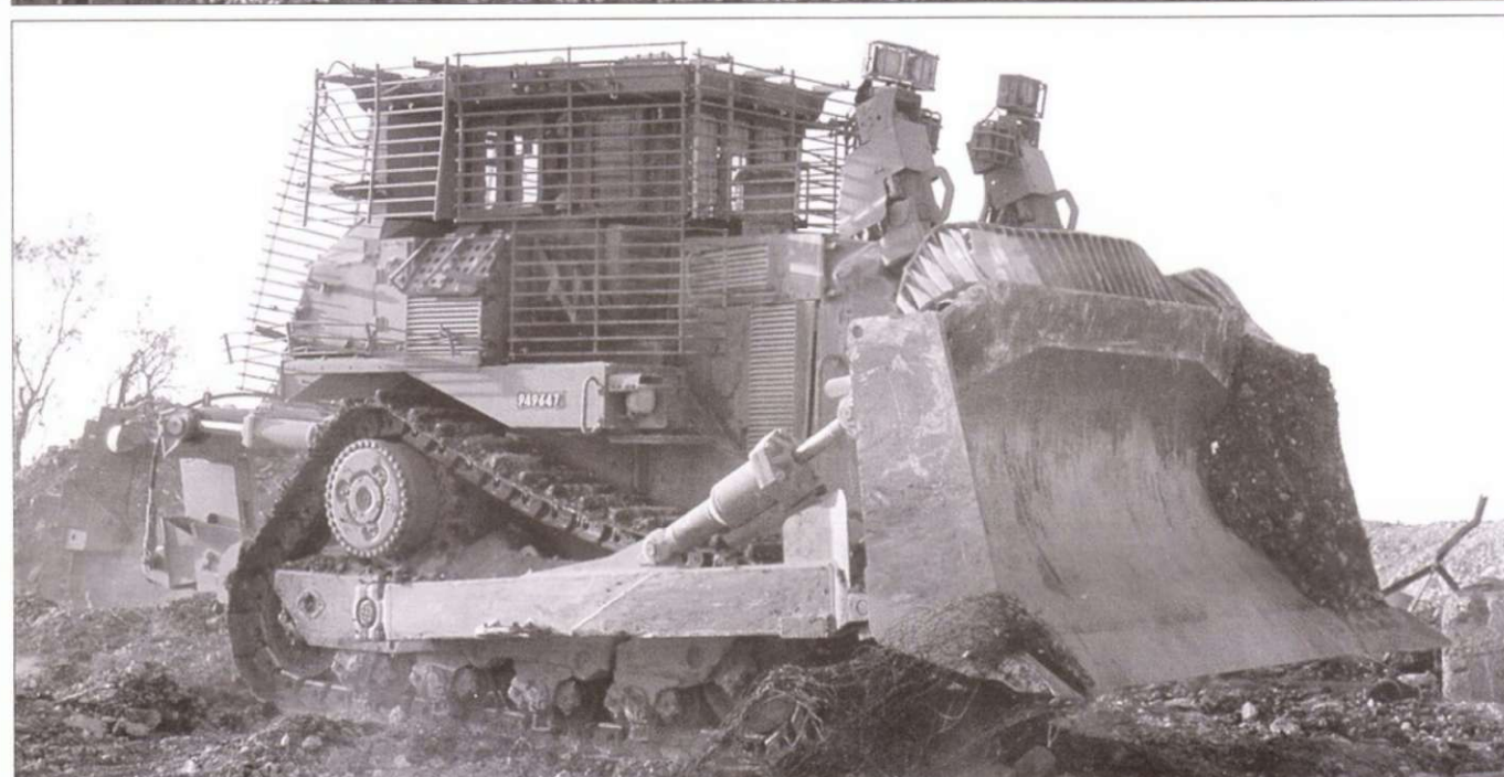
В последние годы бульдозеры Армии Обороны все чаще и чаще оснащаются решетчатой броней, предохраняющей от кумулятивных боеприпасов гранатометов РПГ-7. Снимки тракторов с «решетчатой» броней сделаны в Ливане в 2006 г.
