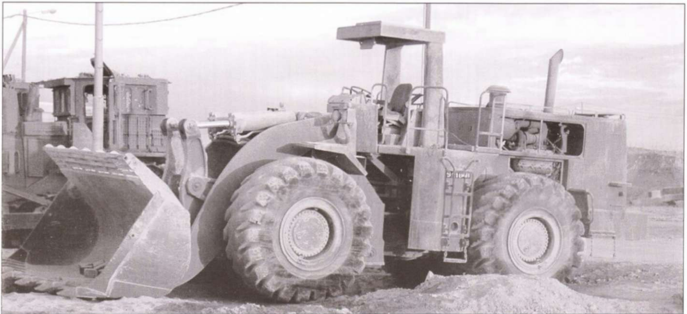
Профиль колесного трактора Катерпиллер 988В, двигатель исключительной мощности установлен на сравнительно небольшой мотораме. Кабина трактора абсолютно открыта.
