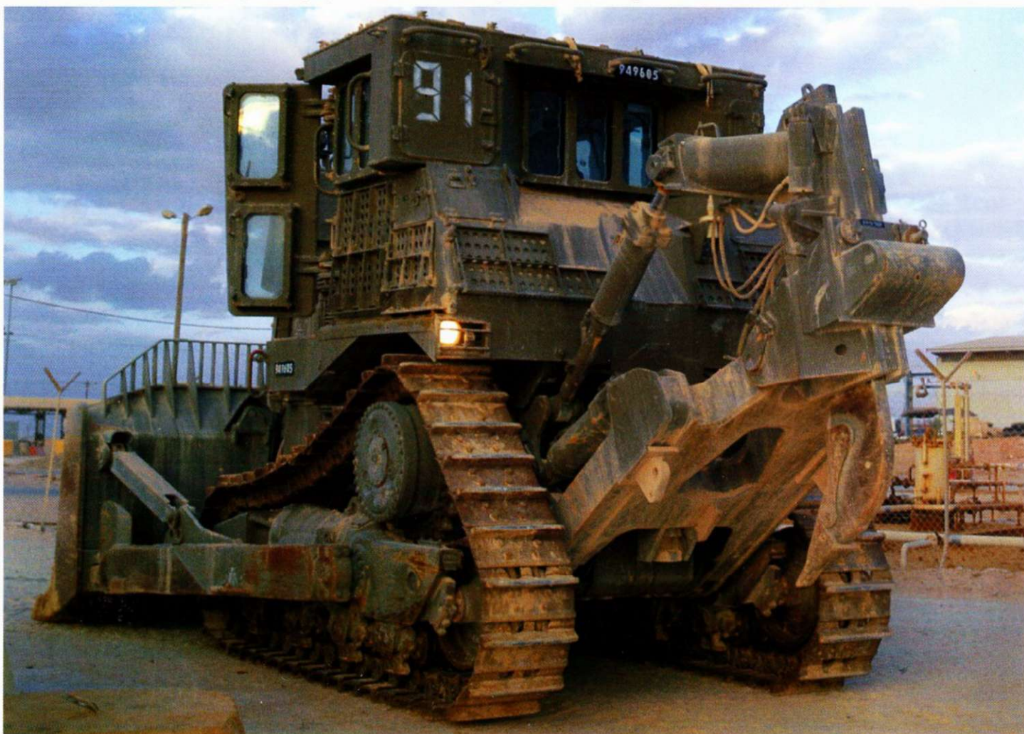
Вид сзади сбоку бульдозера D9 R, хорошо видны магистрали гидросистемы на плуге трактора, очень уязвимые к боевым повреждениям. Тонкие магистрали контрастируют с массивной бронекabinой.
