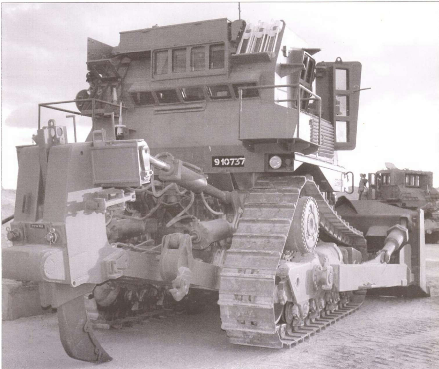
Масса бульдозера составляет примерно 49 тонн, несколько сотен килограммов приходится на броню.
