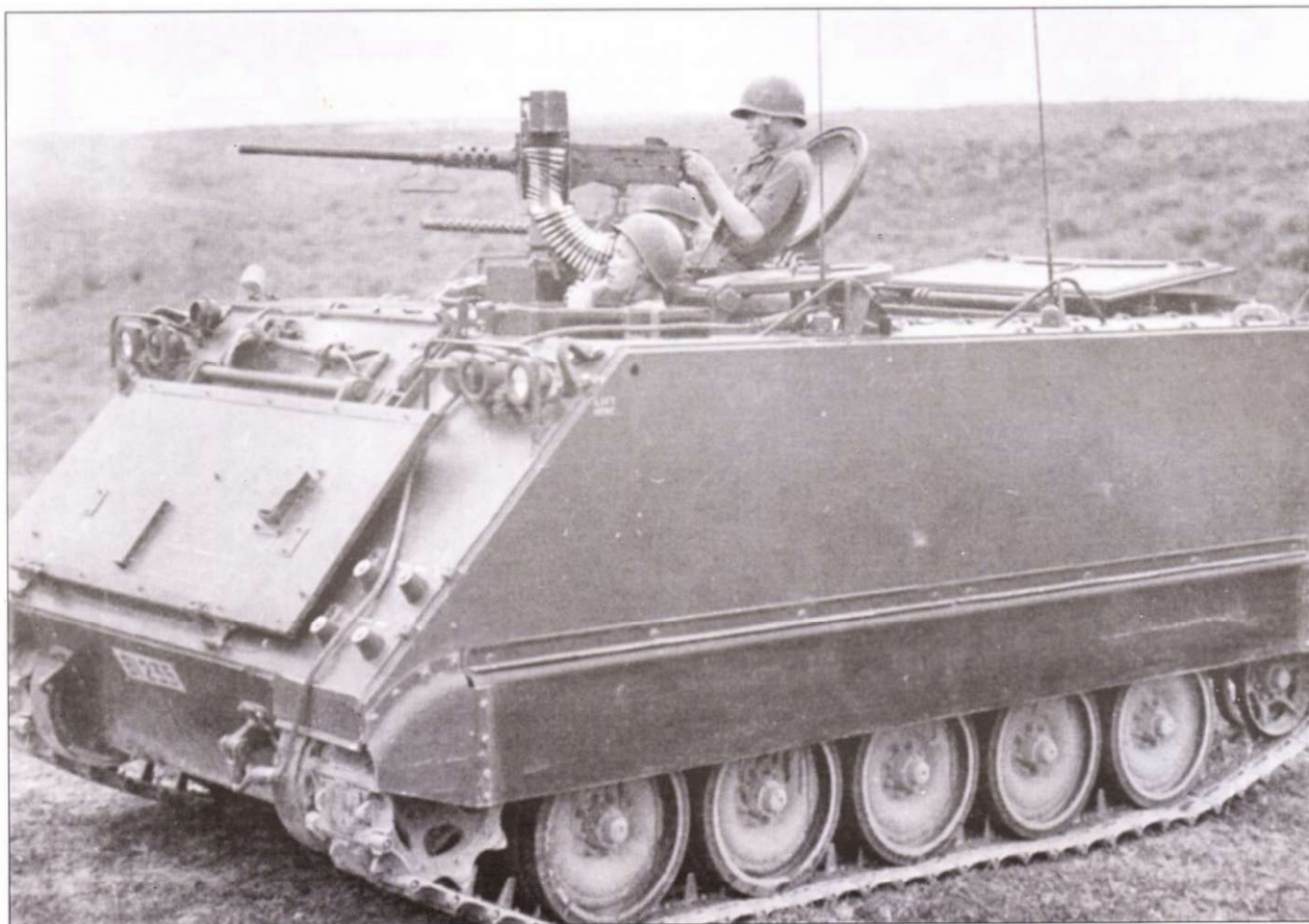
Бронетранспортер М113 армии Республики Вьетнам, ранняя стадия войны во Вьетнаме. Крышка люка командира блокируется в положении, близком к вертикальному, защищая спину командира/пулеметчика от обстрела сзади. На крыше корпуса установлен дополнительный пулемет калибра 7,62 м, стрельбу из него ведет боец, распластавшись на крыше. На лобовой бронеплите корпуса отсутствуют запасные гусеничные траки.
