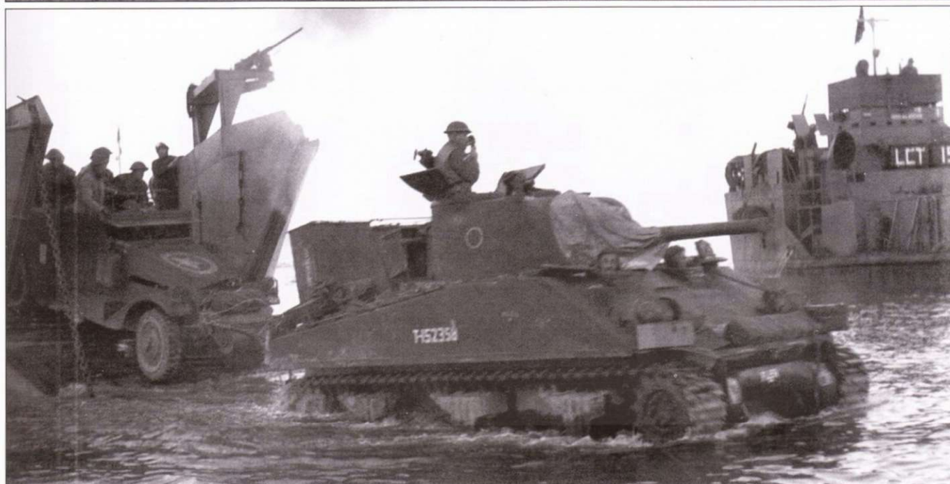
Ранний «Шерман III», оснащенный оборудованием для форсирования водных преград по дну. Техника выгружается на плацдарм в районе Анцио. По эмблеме 23-й бронетанковой бригады и вписанному в круг номеру «86» белого цвета можно определить принадлежность танка - 46-й Королевский танковый полк. На заднем плане - полугусеничный бронетранспортер М3, 22 января 1944 г.
