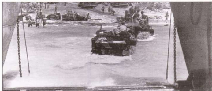
Бронетранспортеры «Юниверсал Карриер» выходят на берег из чрева танкодесантного корабля. Транспортеры окрашены в стандартный светло-зеленый цвет, по которому нарисованы камуфляжные полосы черного цвета. Снимок июля 1943 г., высадка на Сицилию.
