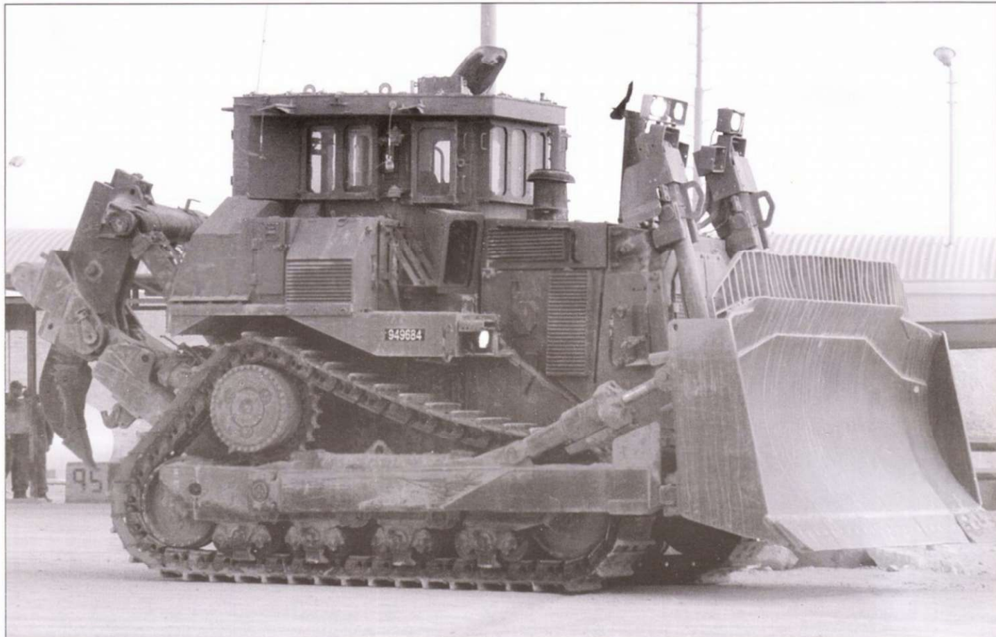
Катерпиллер D9 R также получил наименование «Даби», внешне он очень похож на D9 L. Небольшие различия касаются бульдозерных позей и облицовки двигателя. Бронирование кабины D9 R зато совершенно иное по сравнению с бронированием кабины бульдозера D9 L. На гидроподъемниках установлены фары.
