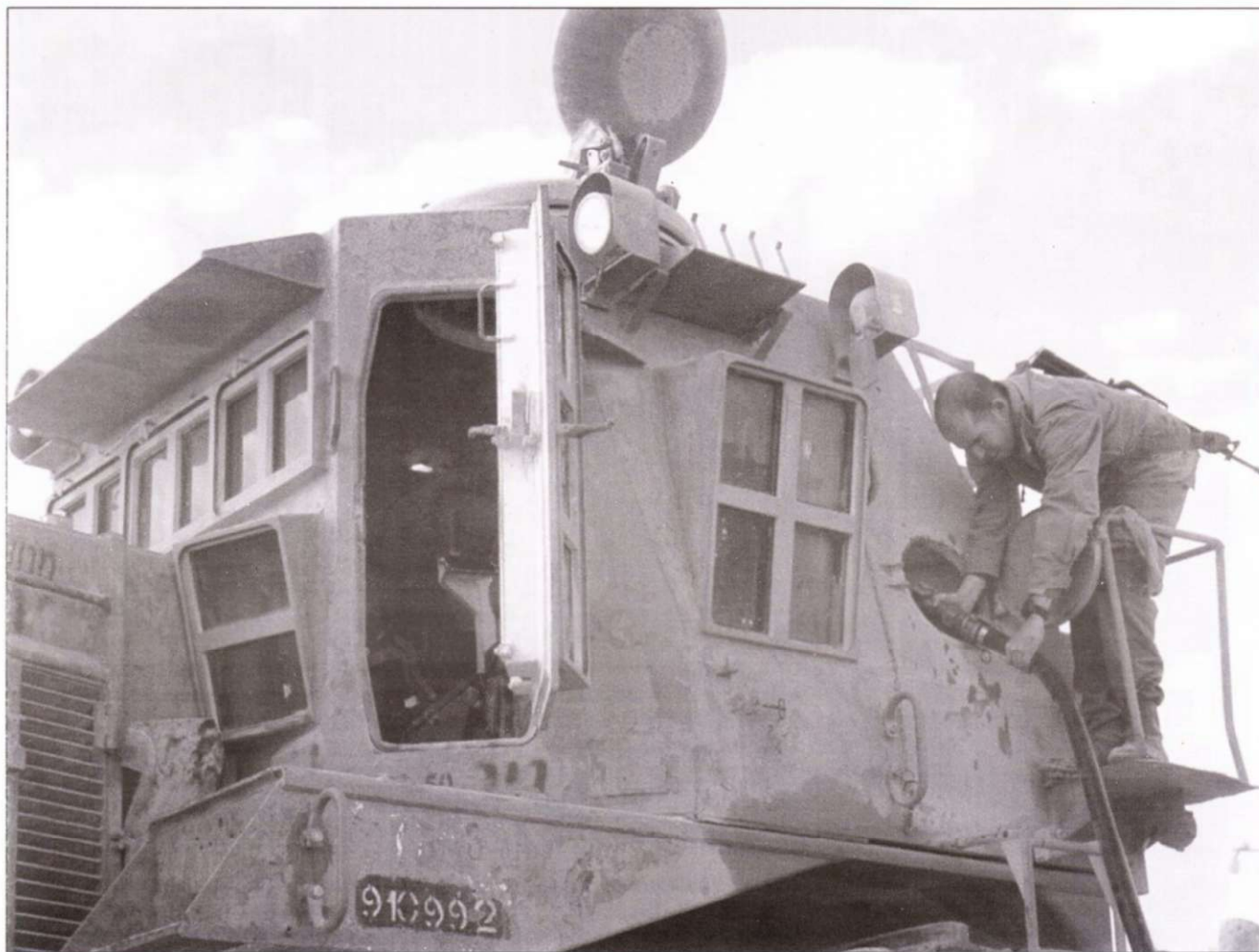
Крупный план бронедомика тракториста бульдозера D9 L. В крыше устроен обзорный люк круглой формы. Рядом с люком у некоторых бульдозеров установлен пулемет. Полным ходом идет заправка бульдозера топливом. Обратите внимание на толщину дверцы кабины!
