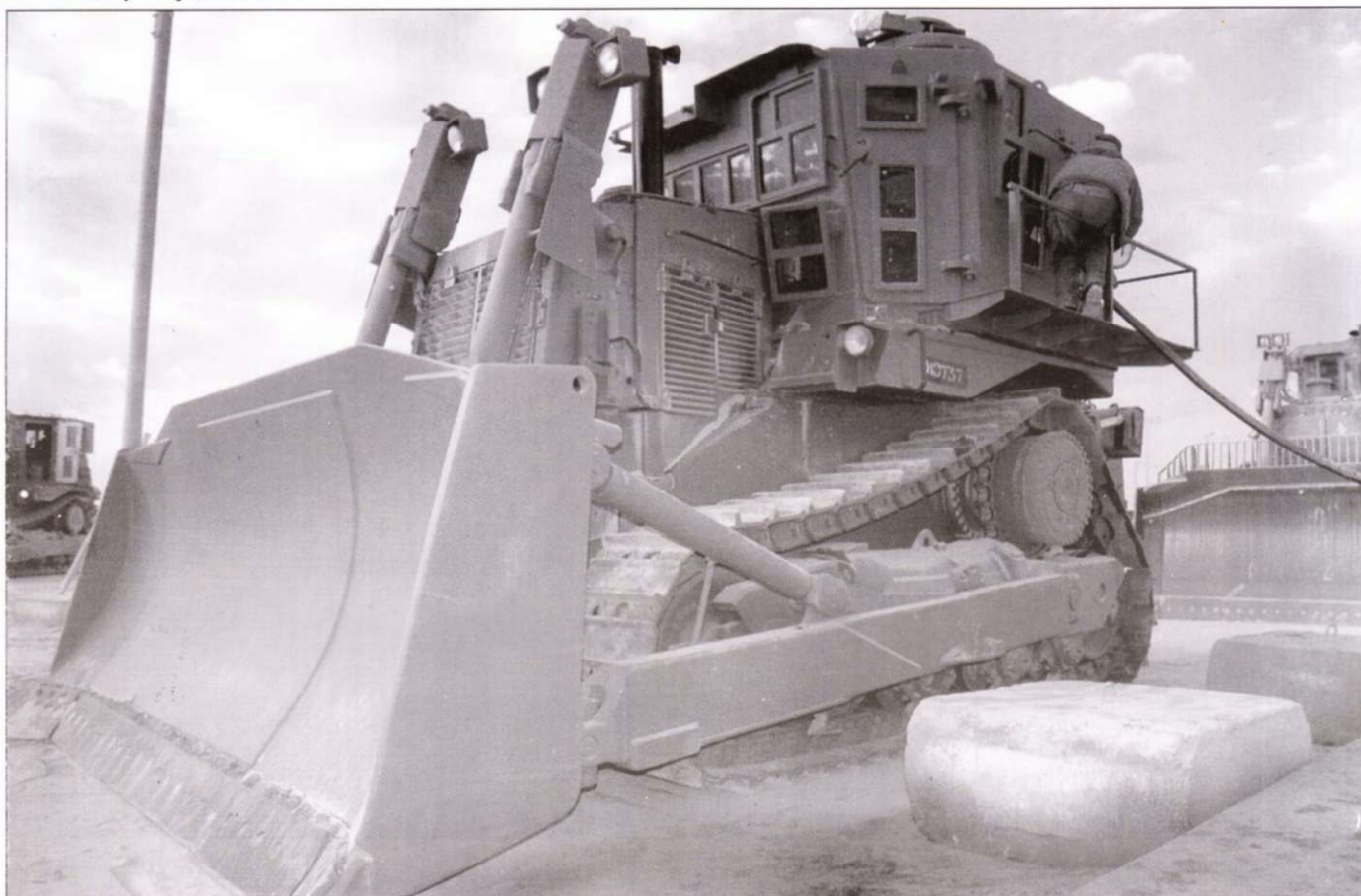
Крупный план бронедомика тракториста бульдозера D9 L. В крыше устроен обзорный люк круглой формы. Рядом с люком у некоторых бульдозеров установлен пулемет. Полным ходом идет заправка бульдозера топливом. Обратите внимание на толщину дверцы кабины!
