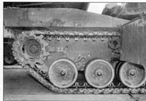
Корма корпуса, камуфляж различим, но окраска также поизносилась. Обратите внимание - цвет ведущего колеса отличается от цвета установленного на нем зубчатого венца.
