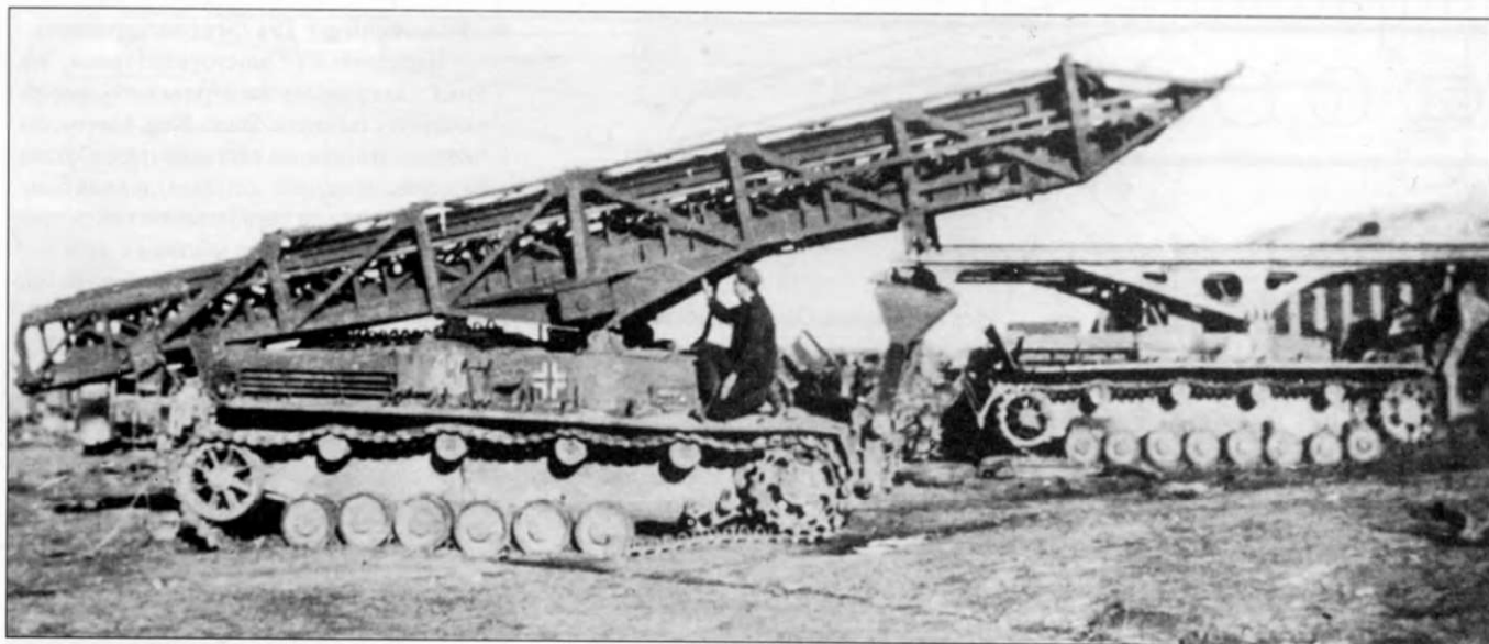
Четыре Brueckenleger IVs (Sturmstegpanzer) были направлены в 1941 г. на Восточный фронт в составе Panzer-Pionier-Bataillon 39 3-й танковой дивизии.
