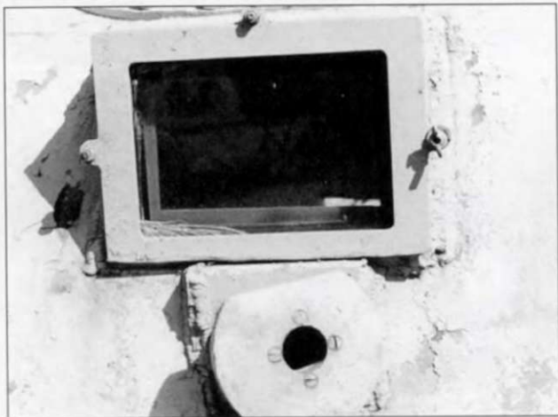
Крупный план пулеметной установки и смотрового окошка, забранного бронестеклом.
