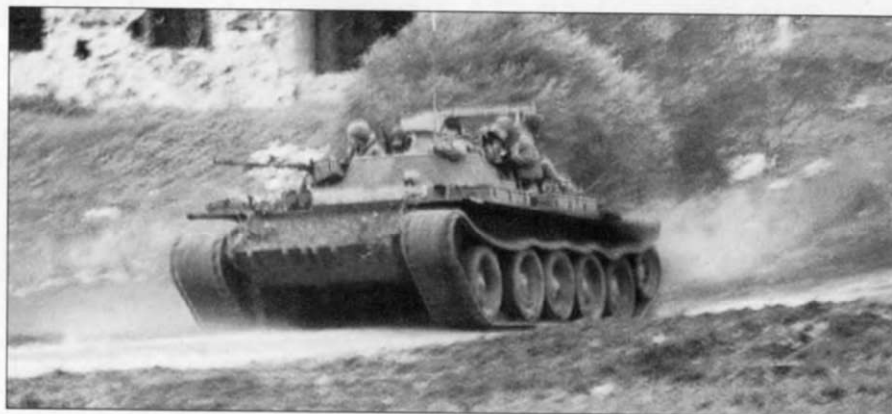
Сенсационный снимок южноливанского бронетранспортера на шасси танка Т-55. Башня демонтирована, взамен установлен фиксированный бронещиток. Бронетранспортер может быть вооружен четырьмя пулеметами, но здесь установлен только один, калибра 12,7 мм. Известно минимум три варианта модернизации танков Т-55 в бронетранспортеры, осуществленных в Южном Ливане.
