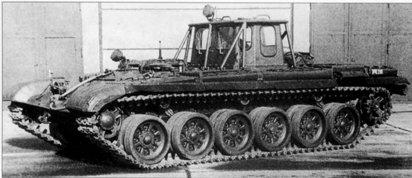
Как минимум один мостовкладчик был переоборудован в машину для подготовки механиков-водителей FAP-172UK.
