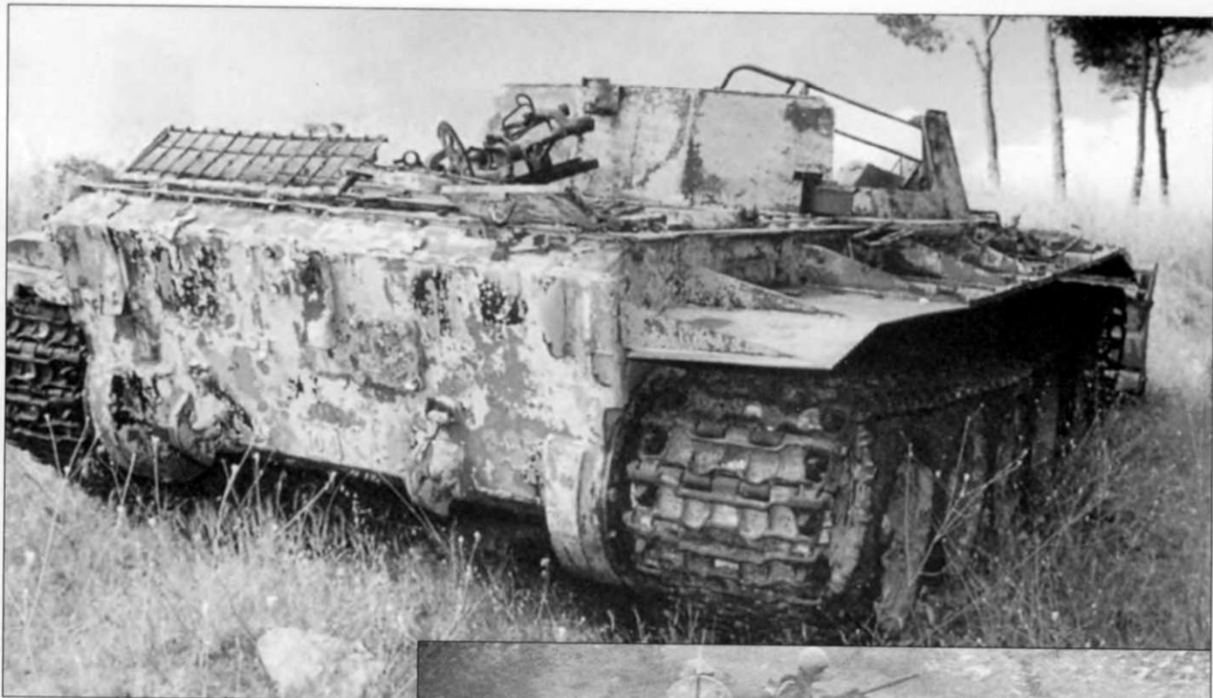
Три снимка бронешенного БТР. На машине смонтирован будьдозерный отвал.
