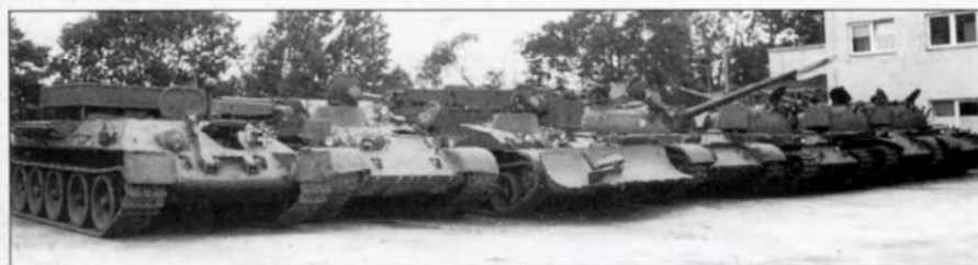
Подготовленная к утилизации бронетехника, август 1990 г. Слева направо: трактор-танк Т-34, БРЭМ Т-55Т, танк-кран Т-55ТК, четыре танка Т-54АМЗ.
