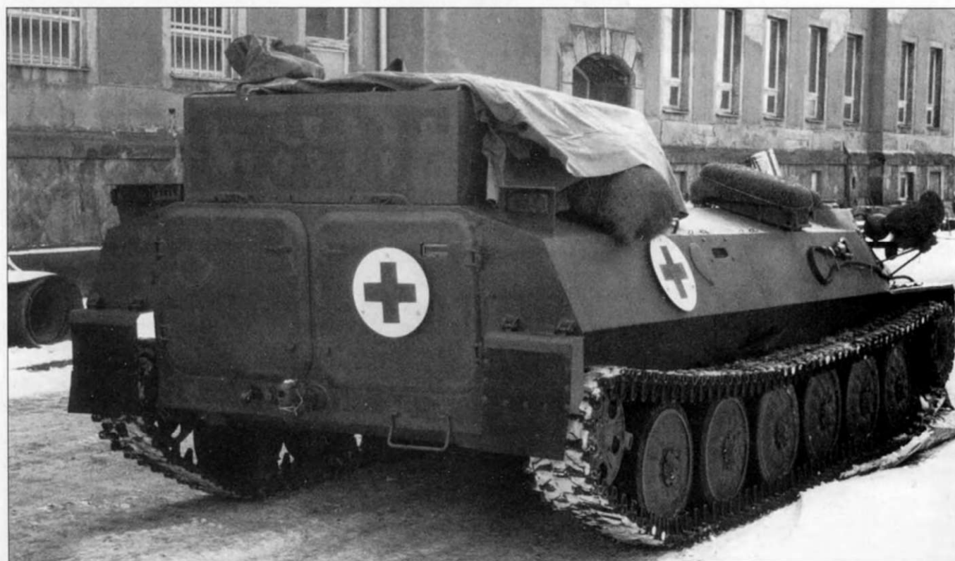
Одна из 16 санитарно-эвакуационных машин на базе тягача МТ-ЛБ 7-го медицинского батальона, который дислоцировался в Дрездене.
