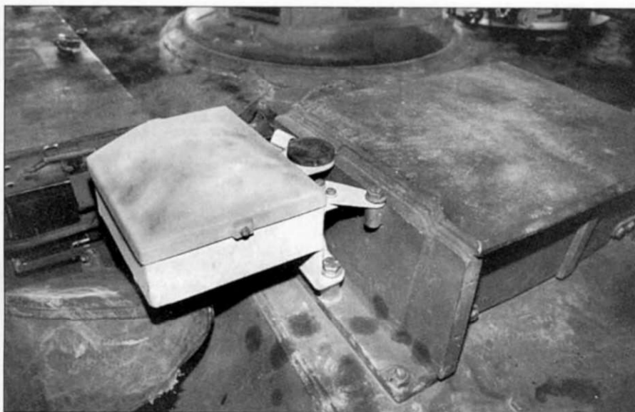
Дивайс, прикрученный болтами к кожуху основного прицела наводчика, представляет собой антенну FBS82, известную также как «блю фор трэйсер».
