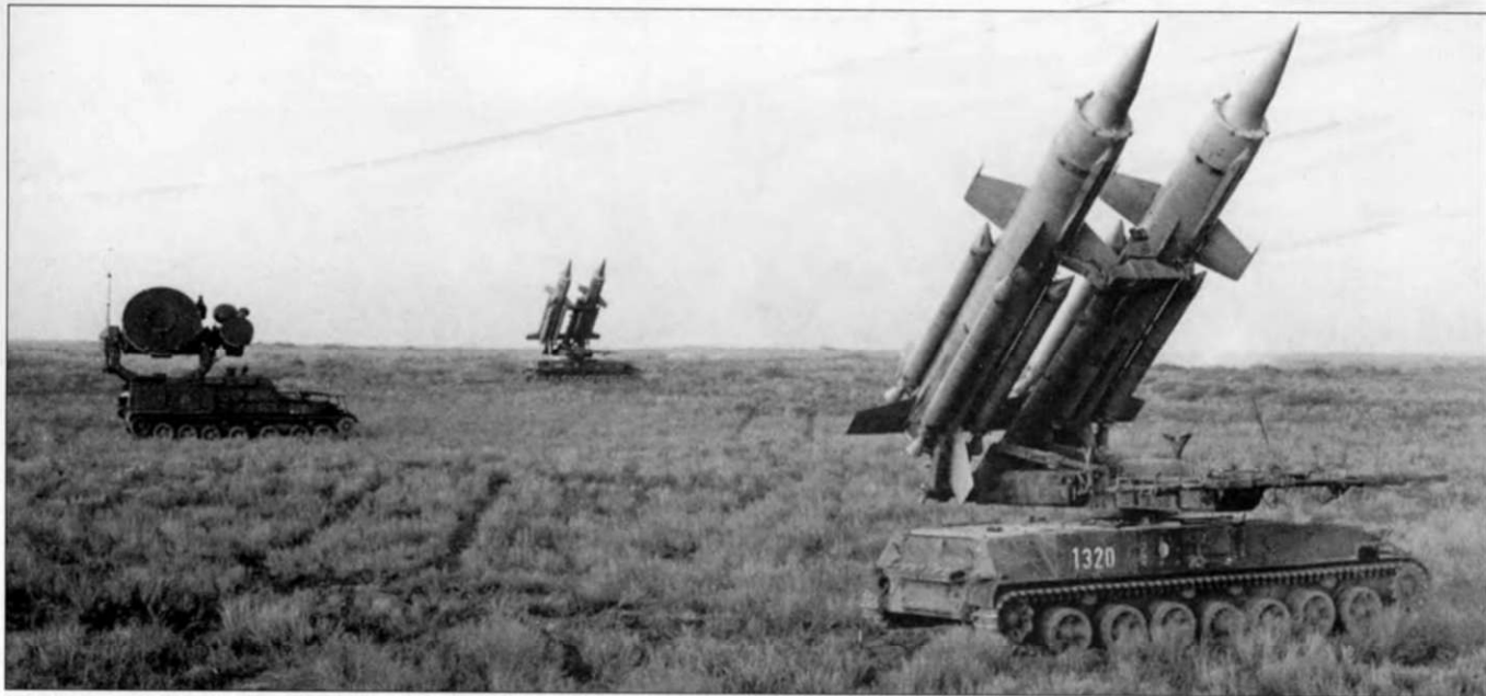
Две пусковые установки 2П25М или 2П25М1 с двумя ракетами 3М8 каждая. В кадр также попала машина управления 1С91, учения сентября 1987 г.
