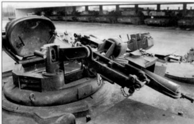
Командирская башенка с турелью 12,7-мм пулемета. На танке M1A2 12,7-мм пулемет установлен иначе.
