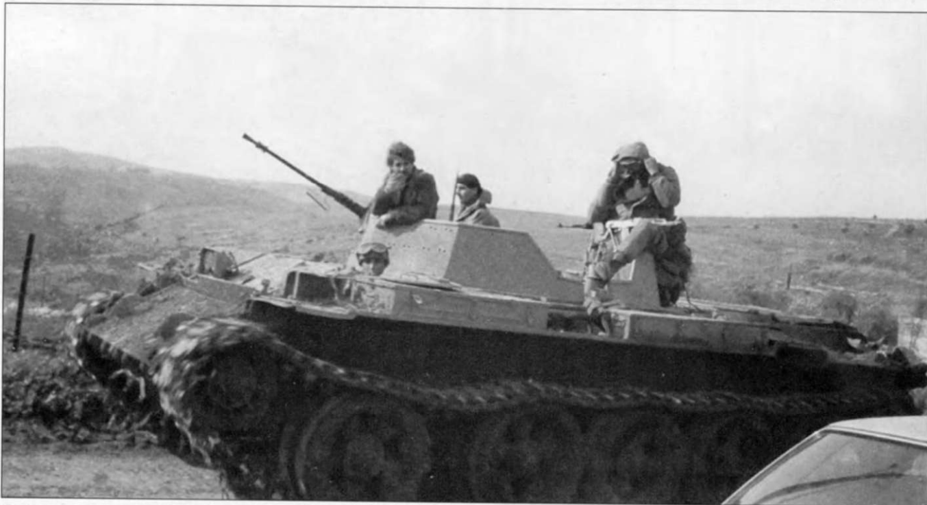
Сенсационный снимок южноливанского бронетранспортера на шасси танка Т-55. Башня демонтирована, взамен установлен фиксированный бронещиток. Бронетранспортер может быть вооружен четырьмя пулеметами, но здесь установлен только один, калибра 12,7 мм. Известно минимум три варианта модернизации танков Т-55 в бронетранспортеры, осуществленных в Южном Ливане.
