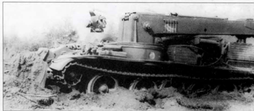
Кран Т-55К на испытаниях с установленным бульдозерным отвалом БТУ-55.
