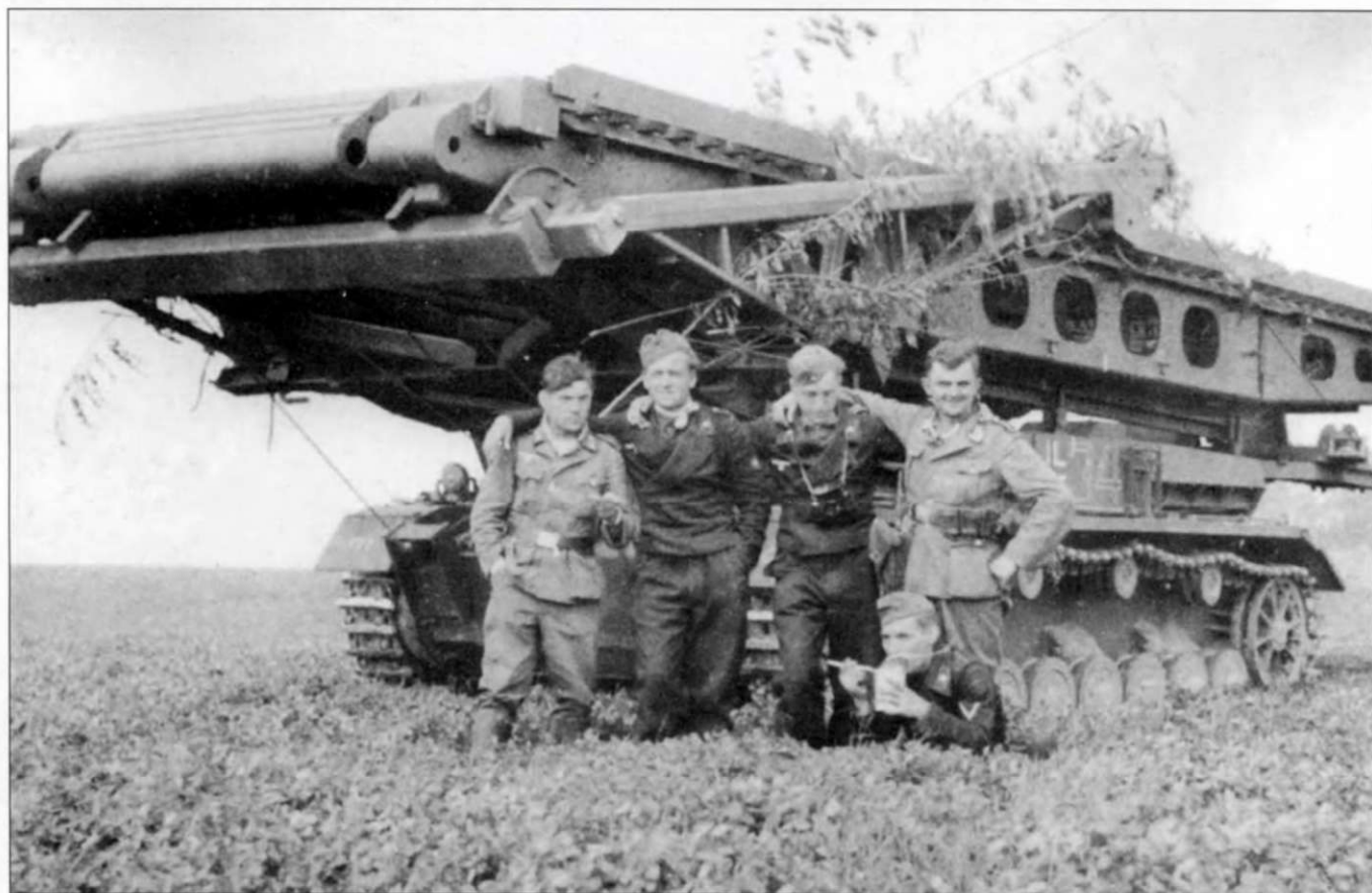
Фирма Крупп изготовила так же мостовкладчик на шасси танка PzKpfw IV Ausf. D. Фотографии сделаны во Франции, 1940 г.
