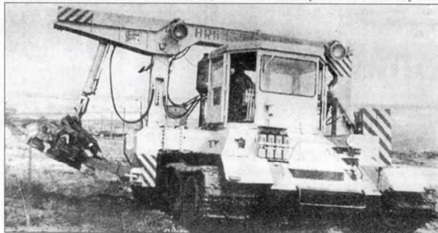
Танк Т-34, конвертированный кабелеукладчик.
