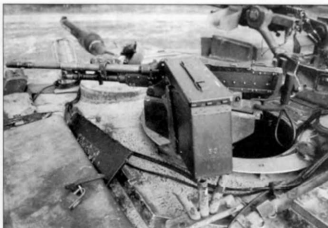
Отличный снимок установленного возле люка заряжающего 7,62-мм пулемета M240. Небольшие трубки (на снимке ниже патронного ящика) предназначены для крепления шестов под маскировку.
