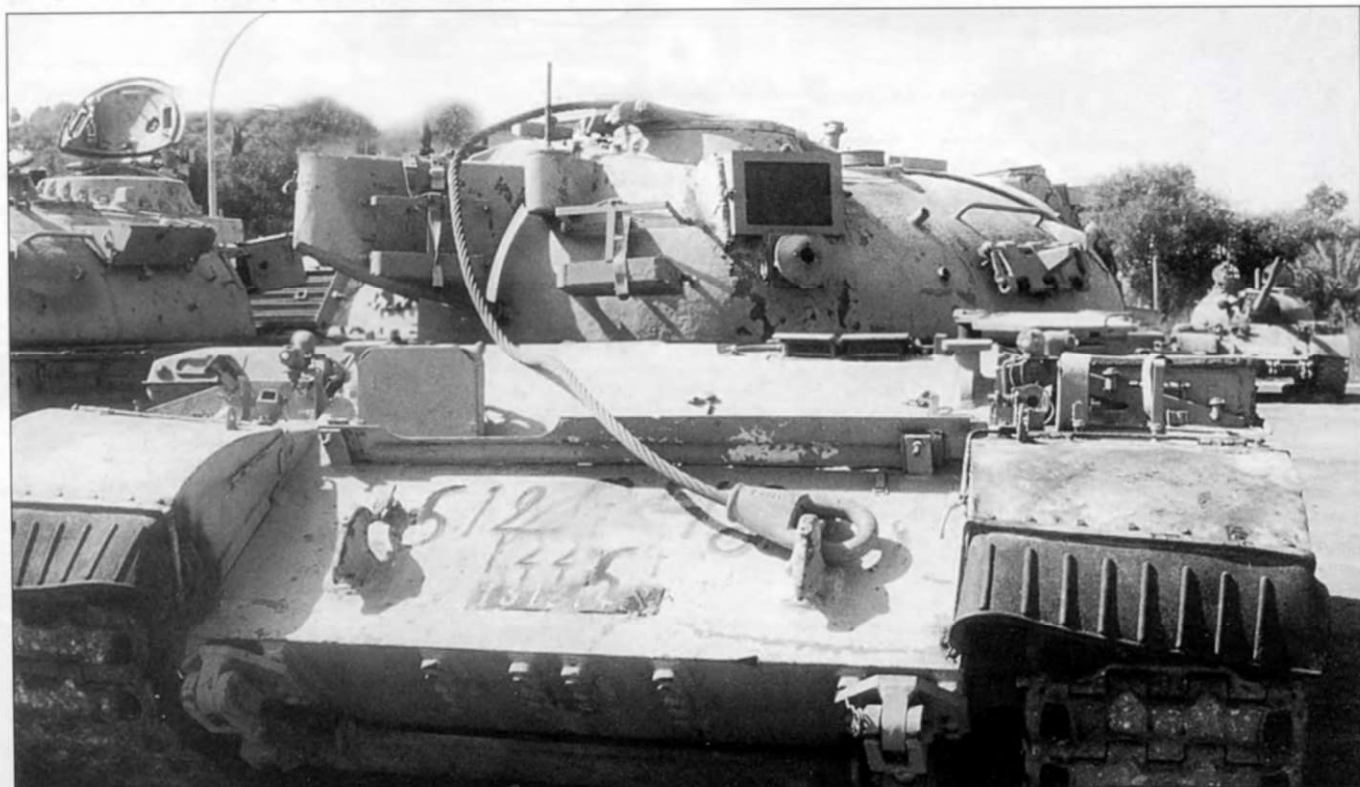
Впечатляющий ракурс бронетранспортера. Видна накладная броня на днище корпуса. Броня установлена на некотором расстоянии от днища. Накладная броня крепится к специальным узлам, два из которых видны в левой и правой частях лобовой детали корпуса.
