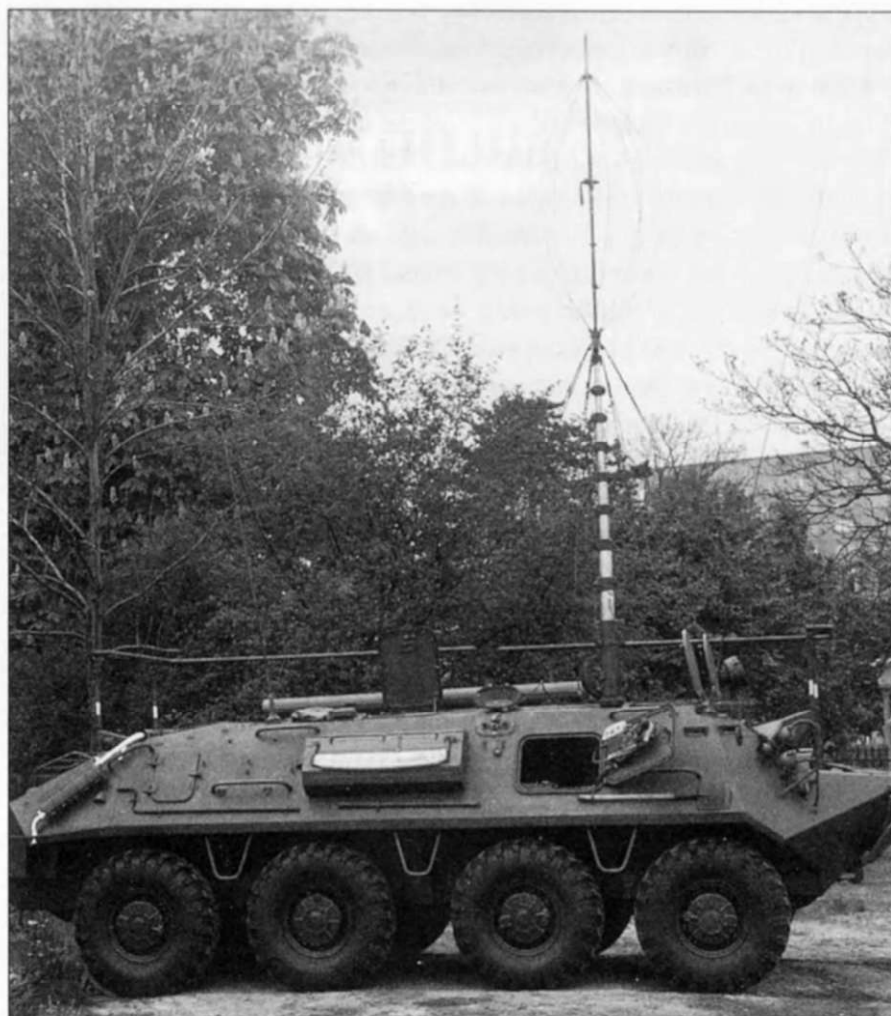
Радиомашинка Р-145БМ на базе бронетранспортера БТР-60, 16-метровая телескопическая антенна выдвинута.
