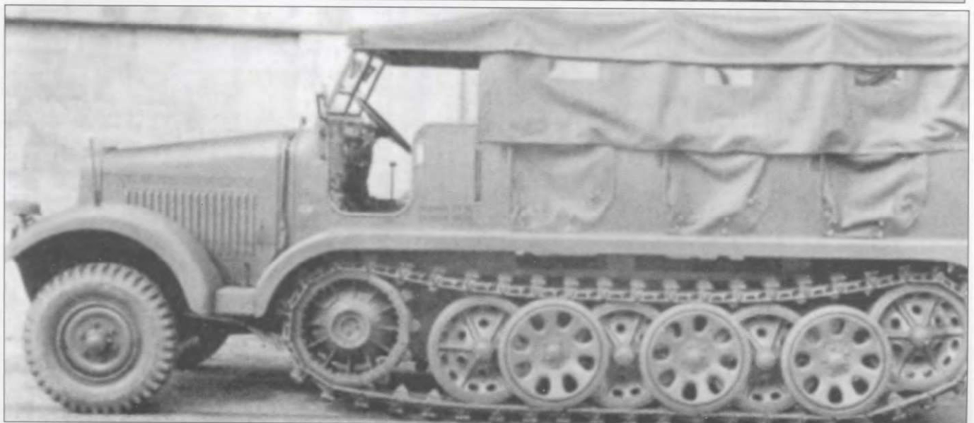
Новенький полугусеничный тягач Бюссинг-NAG BN-9 Pionieraufbau Sd.Kfz. 6.
