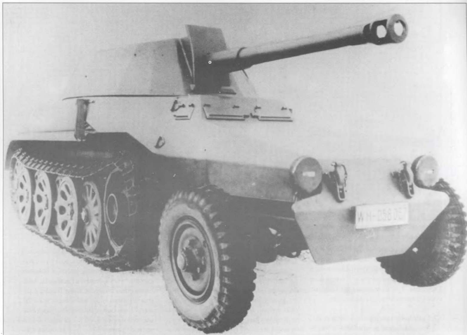
Прототип противотанковой самоходно-артиллерийской установки 7.5 cm Selbstfahrlafette L/40 auf mZgkw St Modell 2.
