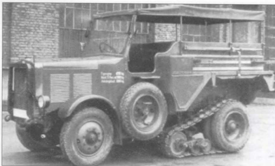
Полугусеничный тягач Маффк MSZ-201 с двигателем Бенц - Браур.
