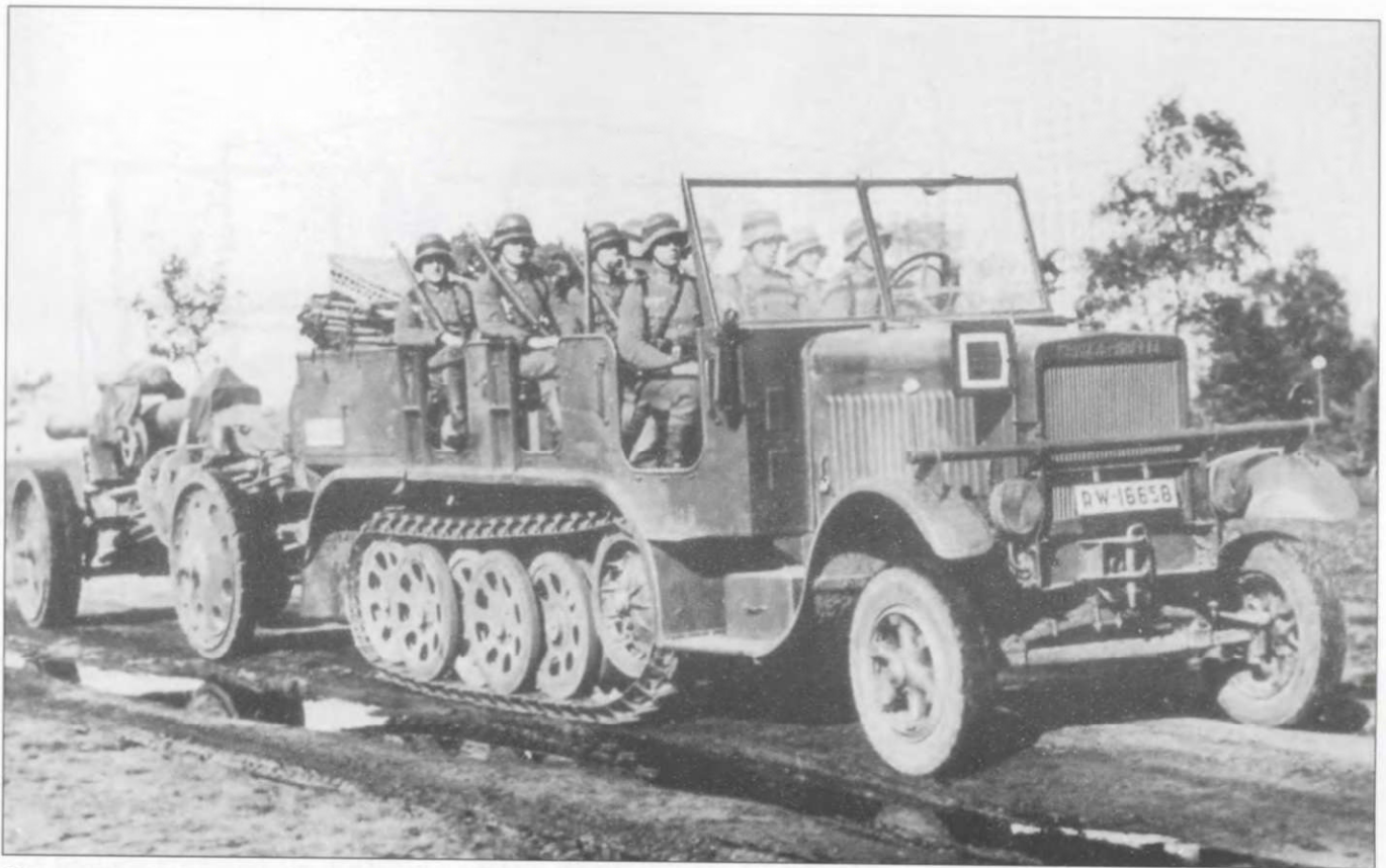
Полугусеничный тягач Краусс-Маффей КМ-8 с гаубицей 15 см sFH-18/40 на прицепе, 1933 - 1934 г.г.
