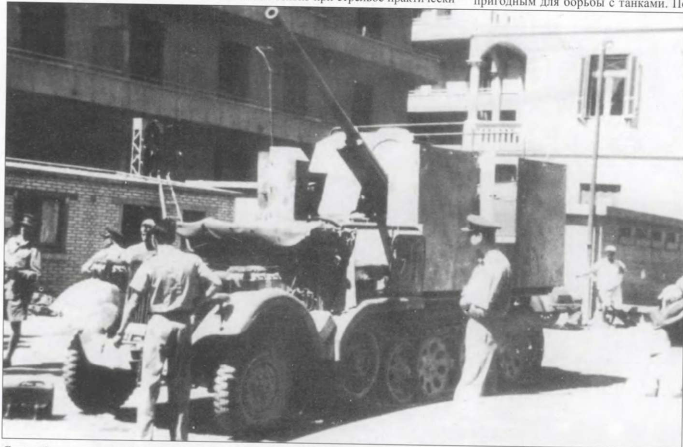
Самоходно-артиллерийская установка 7.62 cm PaK-36( r ) auf mZgkw 5t «Diana» No. 7 из 605-го батальона истребителей танков, Александрия, сентябрь 1942 г.
