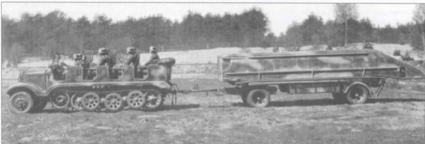
Полугусеничный тягач Бюссинг-NAG BN-9 Sd.Kfz. 6 Pionieraufbau с прицепом Sd.Anh. 108, загруженным элементами pontонного моста.
