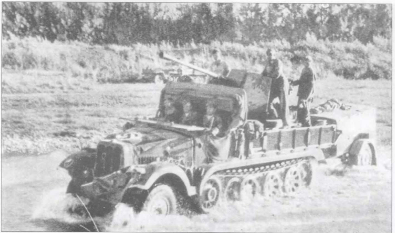
Зенитная самоходно-артиллерийская установка 3,7 см Flak-36 auf mZgkw 5t Sd.Kfz. 6/2 с трейлером Sd.Anh. 102 на прицепе из неуставленного подразделения люфтваффе, Восточный фронт, 1942 г. На капоте двигателя тягача в качестве средства быстрого опознавания с воздуха закреплен нацистский флаг.
