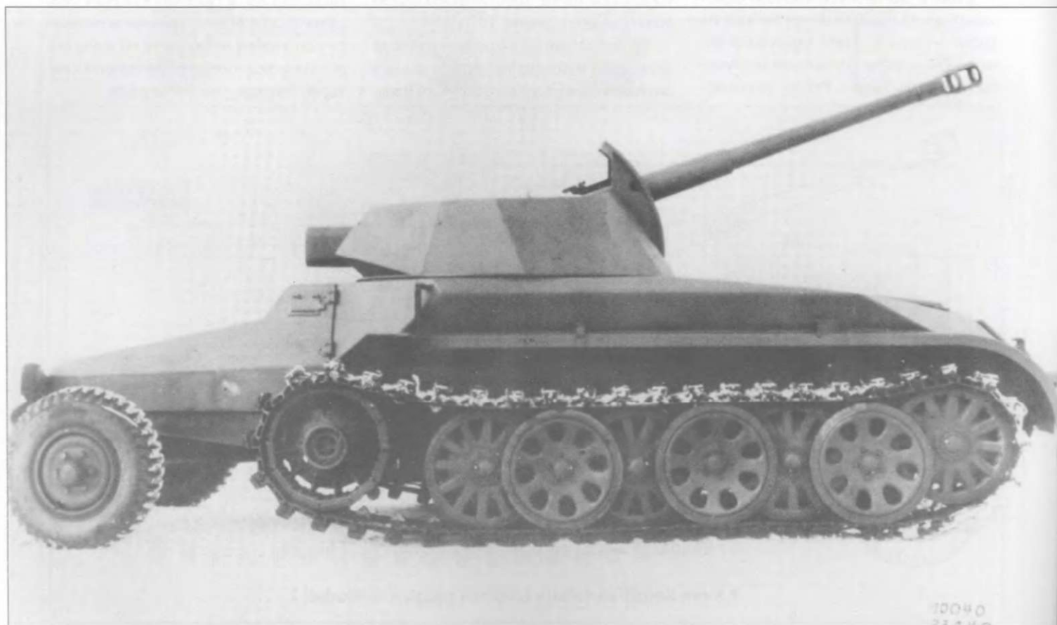
Прототип противотанковой самоходно-артиллерийской установки 7.5 cm Selbstfahrlafette L/40 auf mZgkw St Modell 2.
