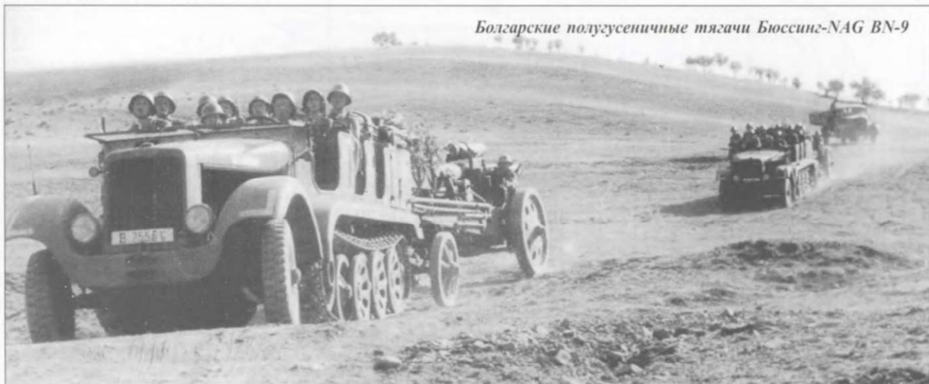
Полугусеничный тягач Sd.Kfz. 6 производства фирмы ВММ. Колеса машины чешской постройки отличны от колес тягача германского производства.
