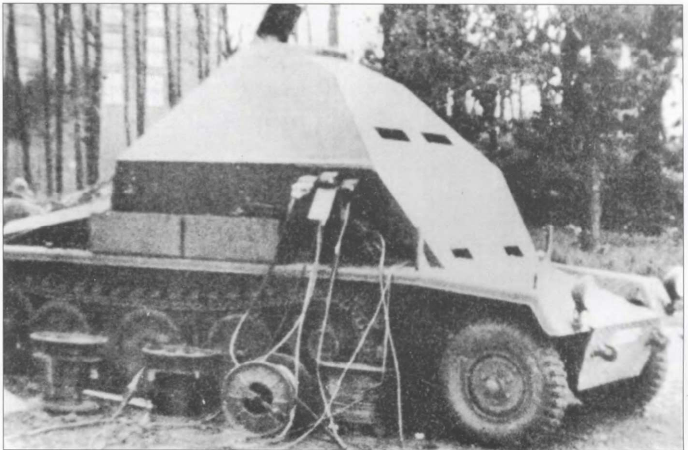
Бронированная машина на шасси НКр-902 использовалась как командный пункт при испытаниях баллистических ракет V-2. Обратите внимание на электрокабели телеметрических систем ракет, подключенные к машине.
