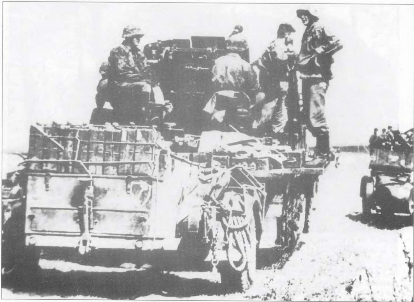
Две фотографии зенитных самоходно-артиллерийских установок 3.7 см Flak-36 auf Fahrgestell mZgKw 5t Sd.Kfz. 6/2. На верхнем снимке - машина из панцергренадерской дивизии СС «Лейбштандарт Адольф Гитлер», Восточный фронт, 1943 г. Внизу - самоходка неуставленного подразделения люфтваффе, Франция, 1943 г.
