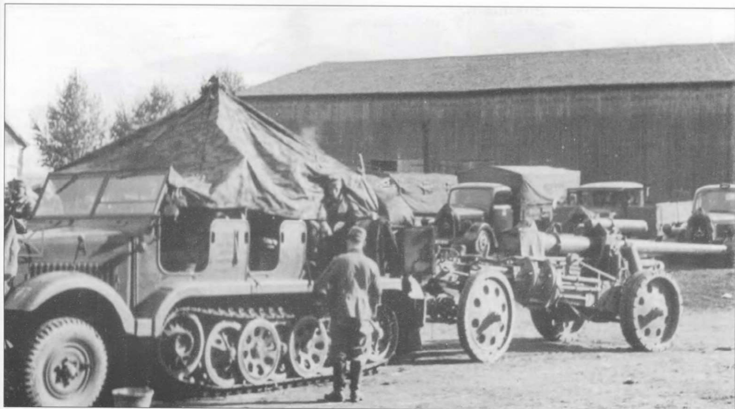
Полугусеничный тягач Sd.Kfz. 6/1 с гаубицей 15 см sFH-18/40 на прицепе, Польша, сентябрь 1939 г.
