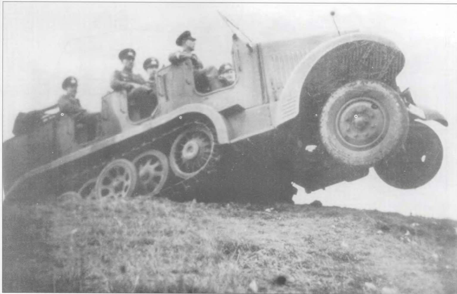
Полугусеничный тягач Бюссинг-NAG BN-17 Artillerieaufbau Sd.Kfz. 6/1 на испытаниях.
