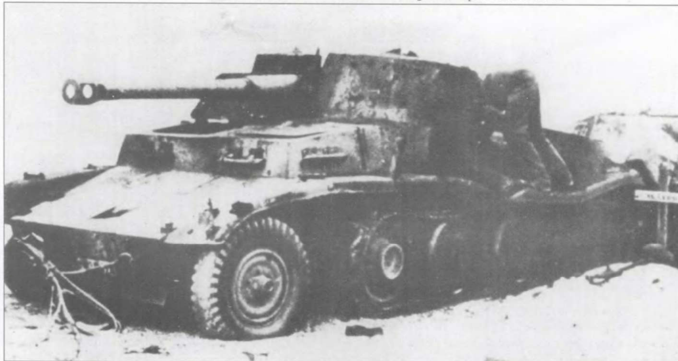
Подбитая самоходно-артиллерийская установка Panzer Selbstfahrlafette II auf Fahrgestell mZgkw 5t (Pz.Sfl. II) 7.5 cm L/40,8 с номерным знаком «WH-539424», Готт-эль-Улеб, Ливия, май 1942 г.
