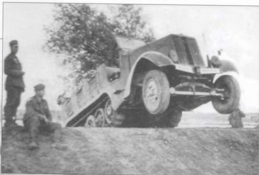
Полугусеничный тягач Бюссинг-NAG BN-18 Sd.Kfz. 6.
