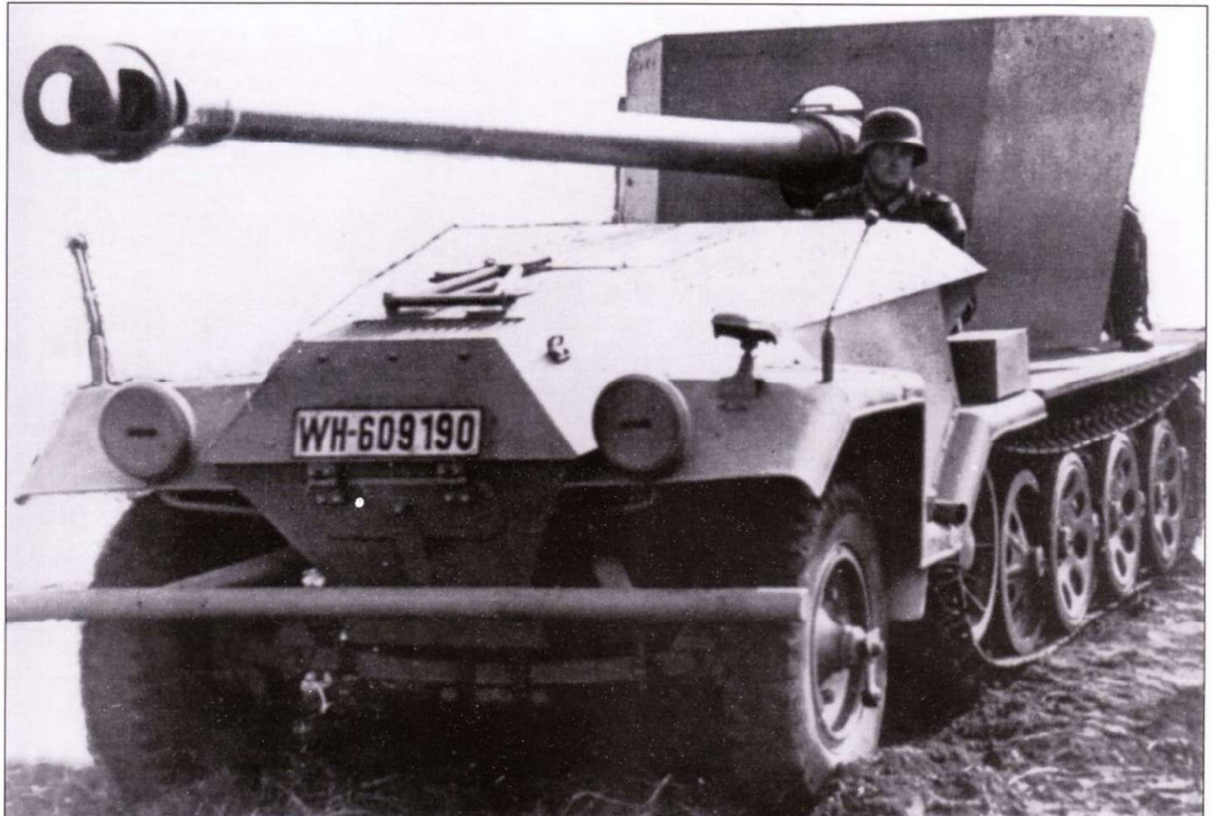
Прототип самоходной противотанковой артиллерийской установки на шасси Sd.Kfz. 251 Ausf. A, машина вооружена противотанковой пушкой 7,5 см KwK-42 L/70.
