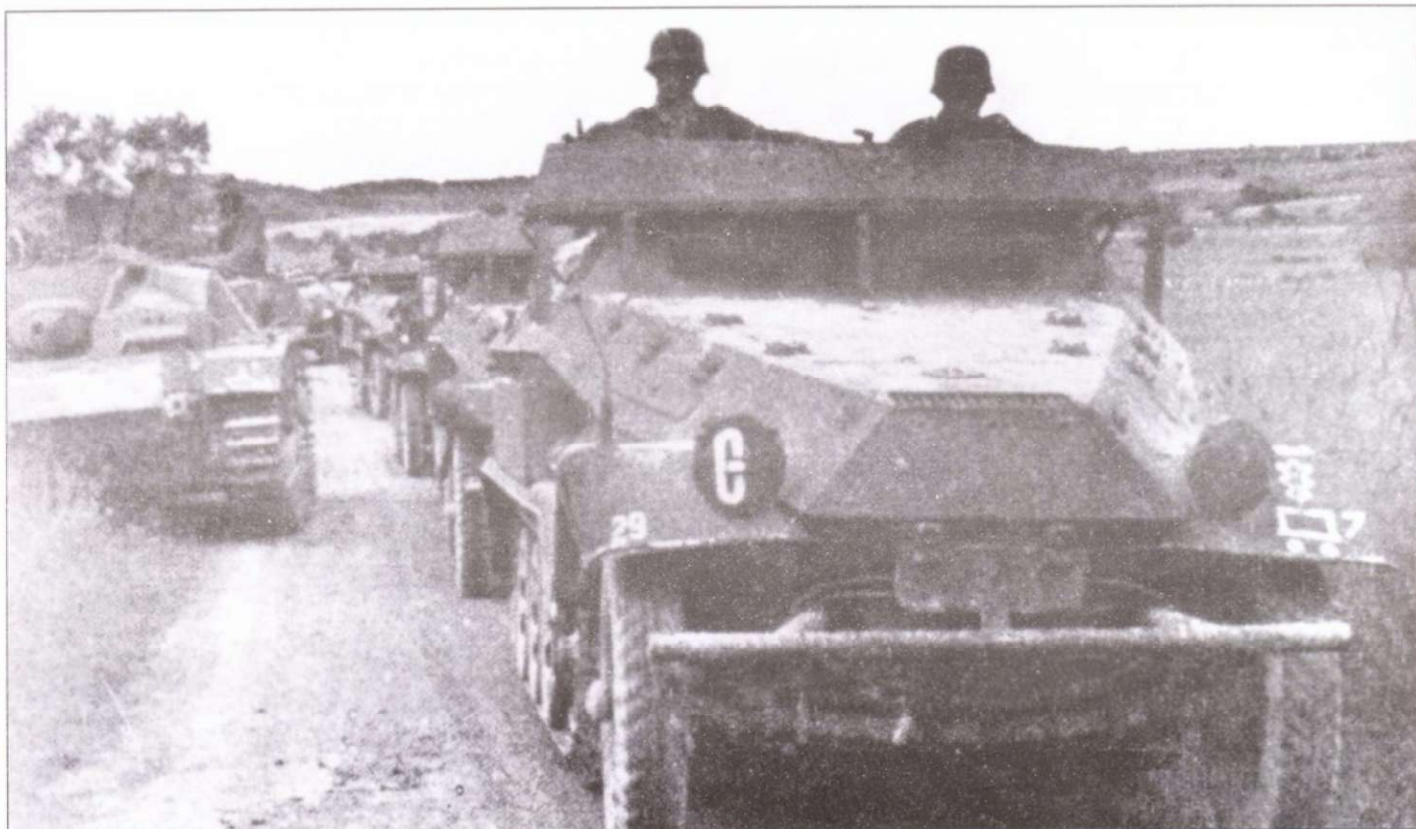
Командирская машина Sd.Kfz. 251/18 Ausf. C из 1-й танковой дивизии, Франция, май 1940 г. Над отделением управления поставлен массивный стол для топографических карт.
