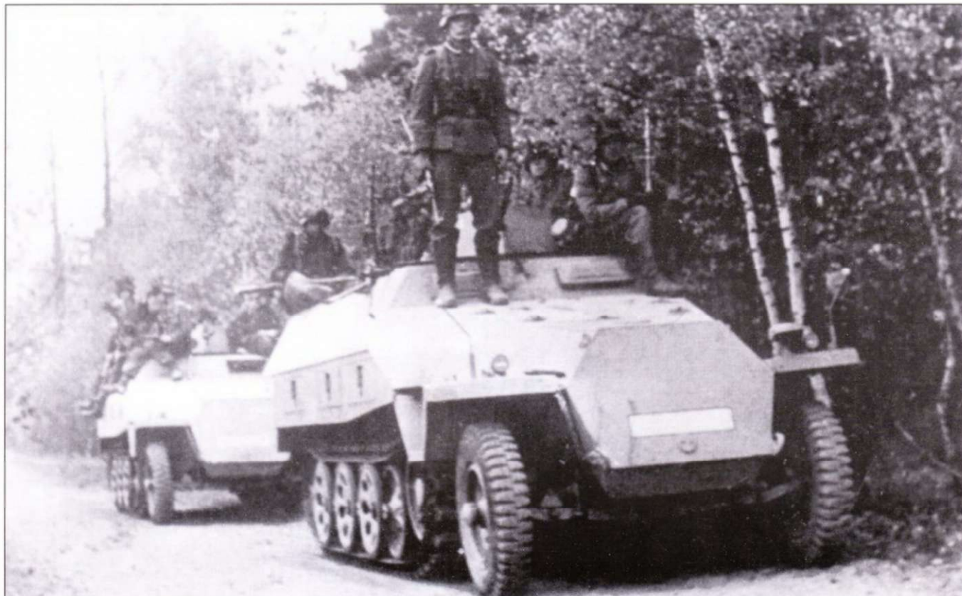
Два бронетранспортера Sd.Kfz. 251/1 Ausf. D из неустановленного панцергренадерского подразделения (вероятно 19-й панцердивизии), Польша, лето 1944 г.
