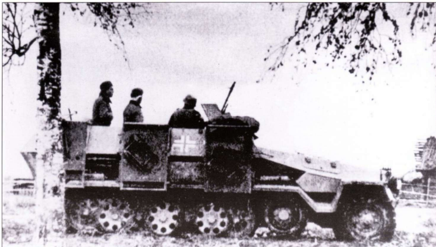
Бронетранспортер Sd.Kfz. 251/1 Ausf. B без пусковых установок неуправляемых реактивных снарядов, но с креплениями для их монтажа.
