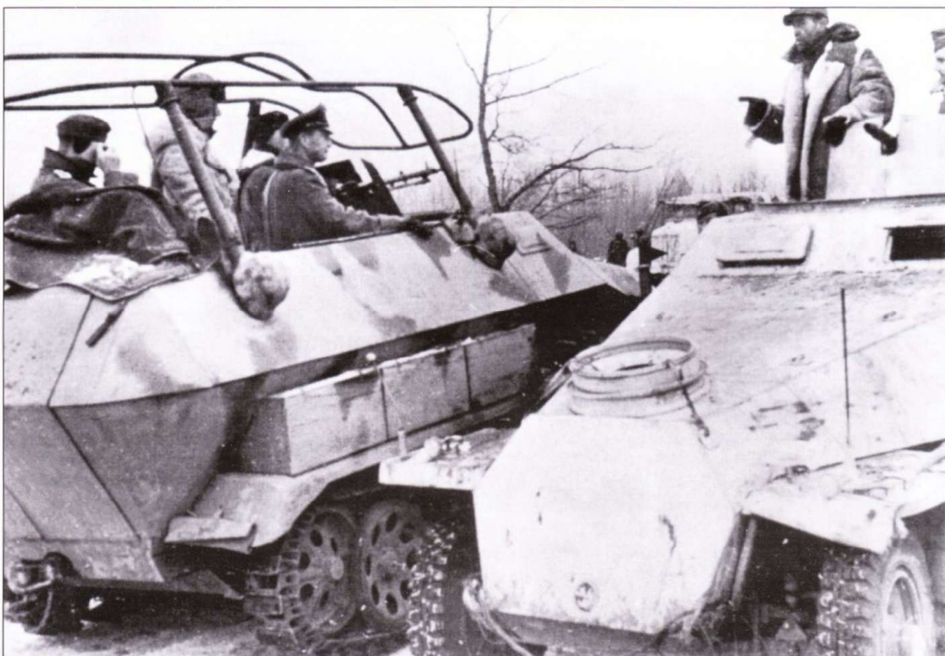
Радиомашина Sd.Kfz. 251/3, оборудованная рамой антенной, и бронетранспортер Sd.Kfz. 251/1 Ausf. D, Восточный фронт, зима 1944 г.
