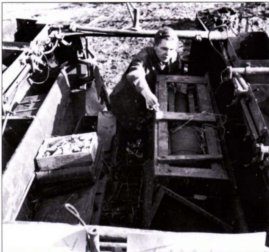
Бронетранспортер Sd.Kfz. 251/1 Ausf. D с пусковыми установками неуправляемых реактивных снарядов. Боец вытягивает ракету в транспортниковой упаковке из боевого отделения машины.
