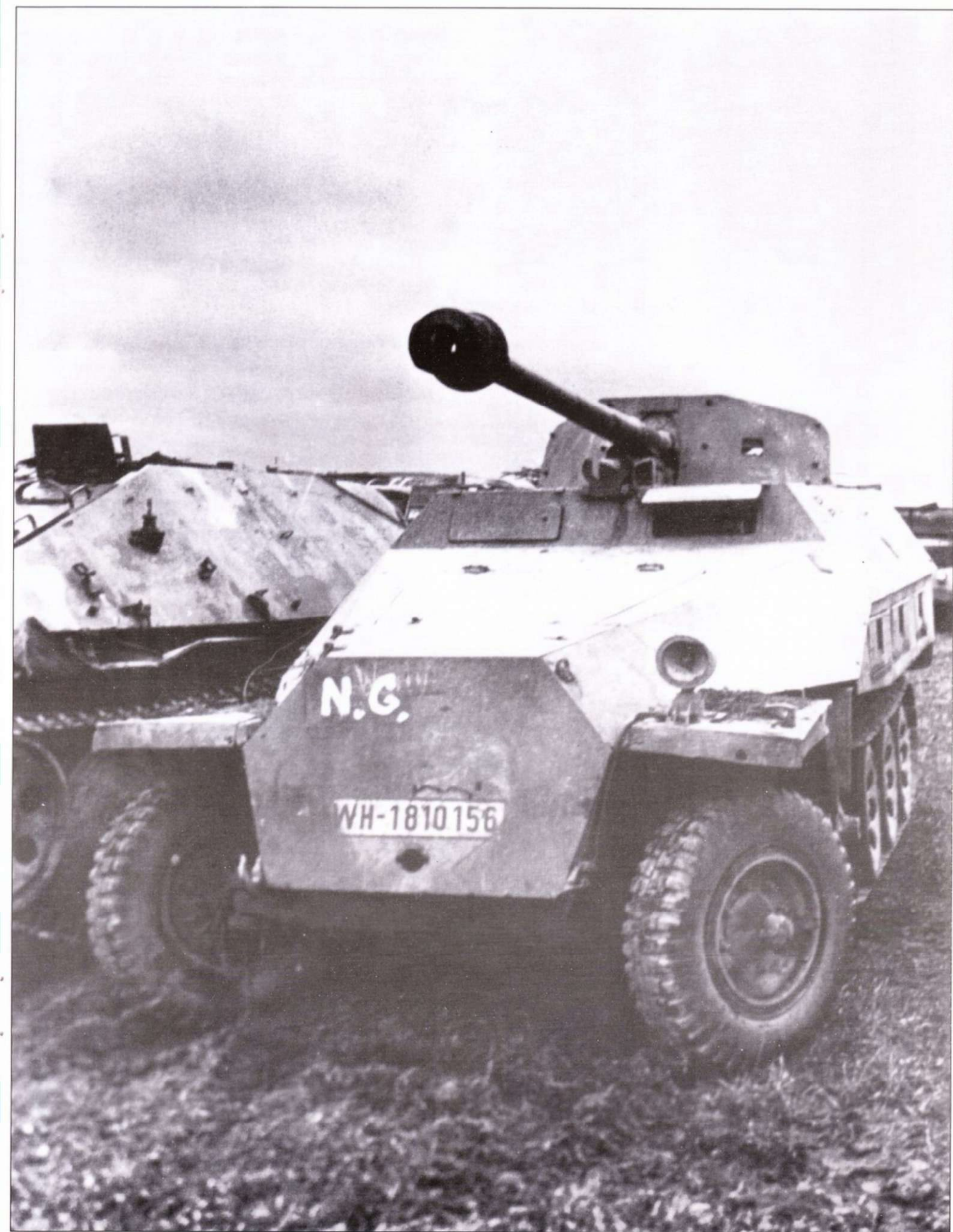
Трофейная самоходная противотанковая артиллерийская установка Sd.Kfz. 251/22 Ausf. D, вид спереди.
