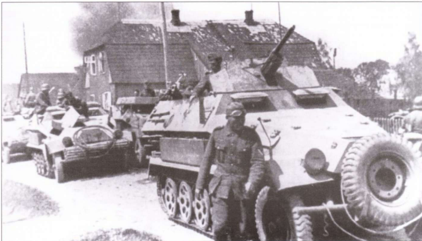
Группа бронетранспортеров из 6-й танковой дивизии, Восточный фронт, лето 1941 г. На переднем плане - машина огневой поддержки Sd.Kfz. 251/10 Ausf. B, за ней - саперный бронетранспортер Sd.Kfz. 251/5 Ausf. B, дальше - командирская машина Sd.Kfz. 251/18 Ausf. A.
