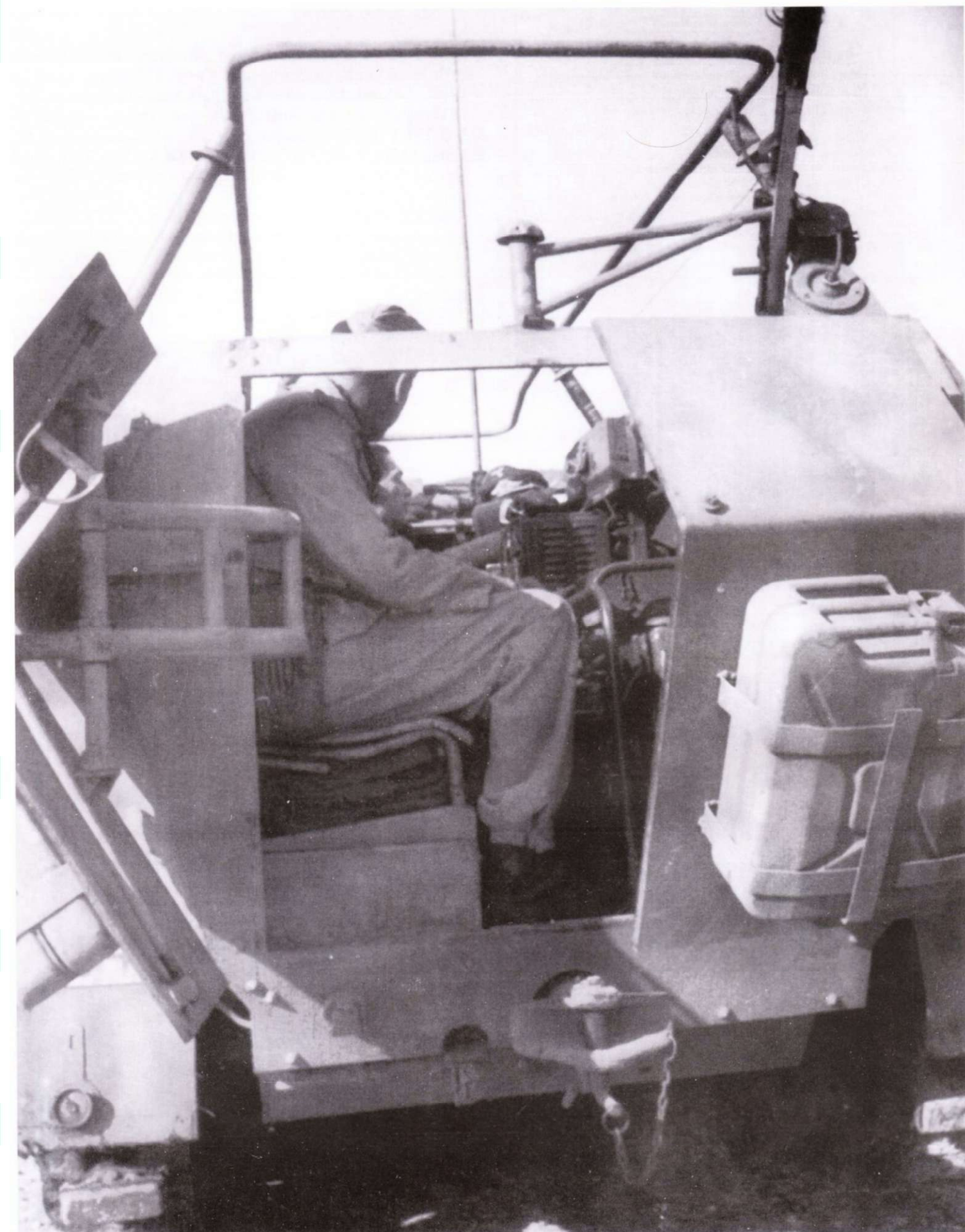
Радиомашинa Sd.Kfz. 251/3 II Ausf. C с открытой задней дверцей. На дверцах снаружи закреплены канистры для воды.
