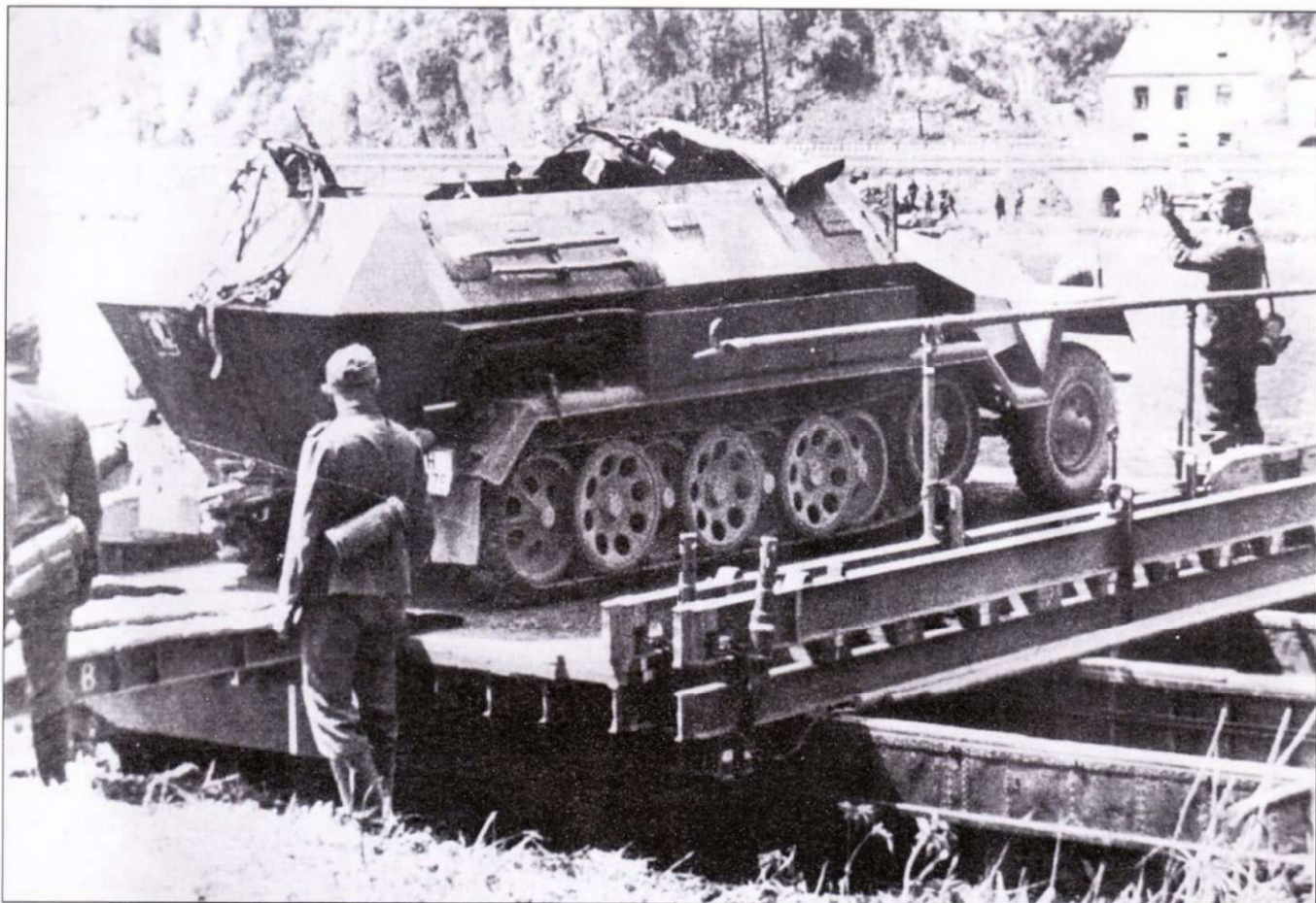
Легкий артиллерийский тягач Sd.Kfz. 251/4, машина использовалась для буксировки артсистем 3,7 см Rak-36, 7,7 см le IG, 10,5 см le FH-18. На снимке - Sd.Kfz. 251/4 Ausf. A. В левой части кормового бронелиста корпуса нанесена эмблема 1-й танковой дивизии.
