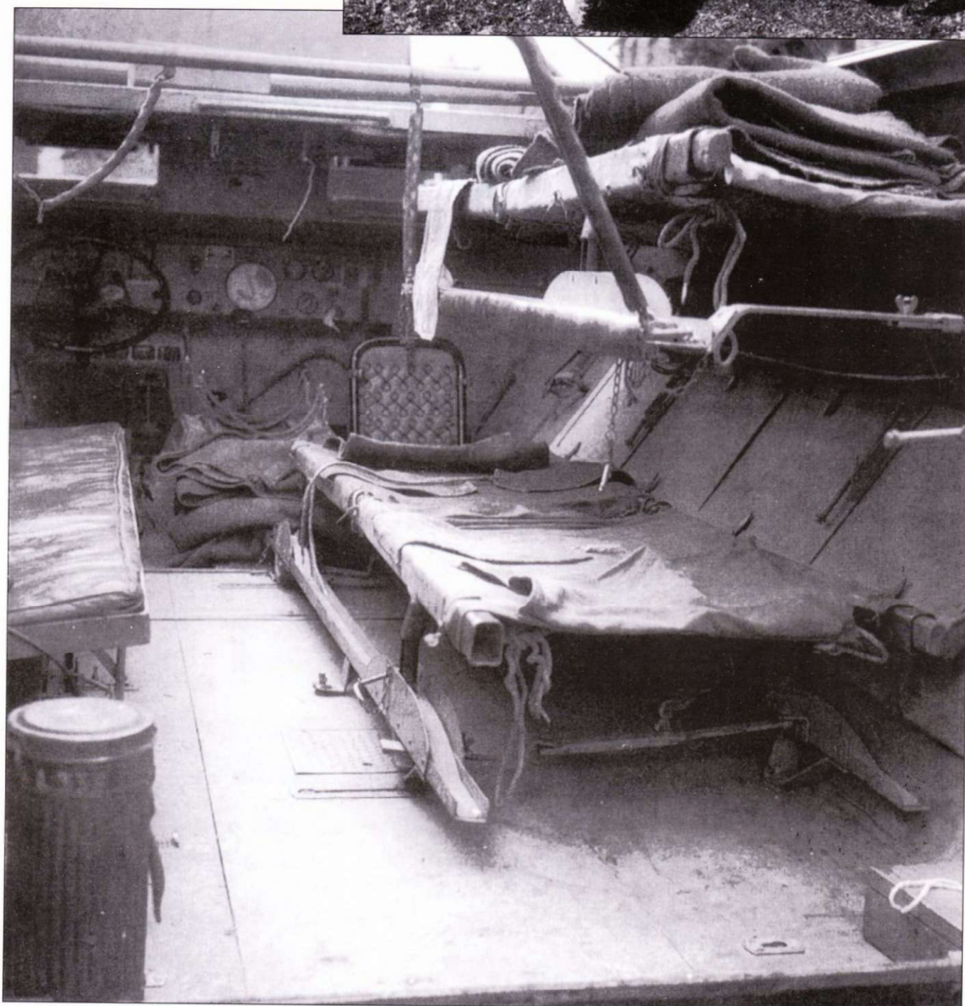
Интерьер трофейного санитарно-эвакуационного бронетранспортера Sd.Kfz. 251/8 Ausf. D.
