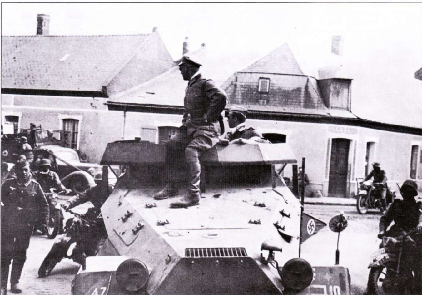
Командирский Ausf. A из 10-й роты Schützen-Regiment I 1-й танковой дивизии. На крыле нанесен тактический значок моторизованной пехоты. Над отделением управления смонтирована платформа - рабочий стол для раскладки топографических карт.
