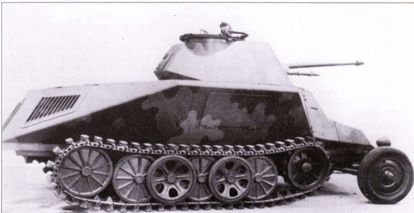
Прототип полугусеничного бронеевтомобиля 3.7 cm Selbstfahrlafette, построенный на шасси HL Kl 3(H), 1936 г. Обратите внимание на трехцветный камуфляж рейхсвера.
