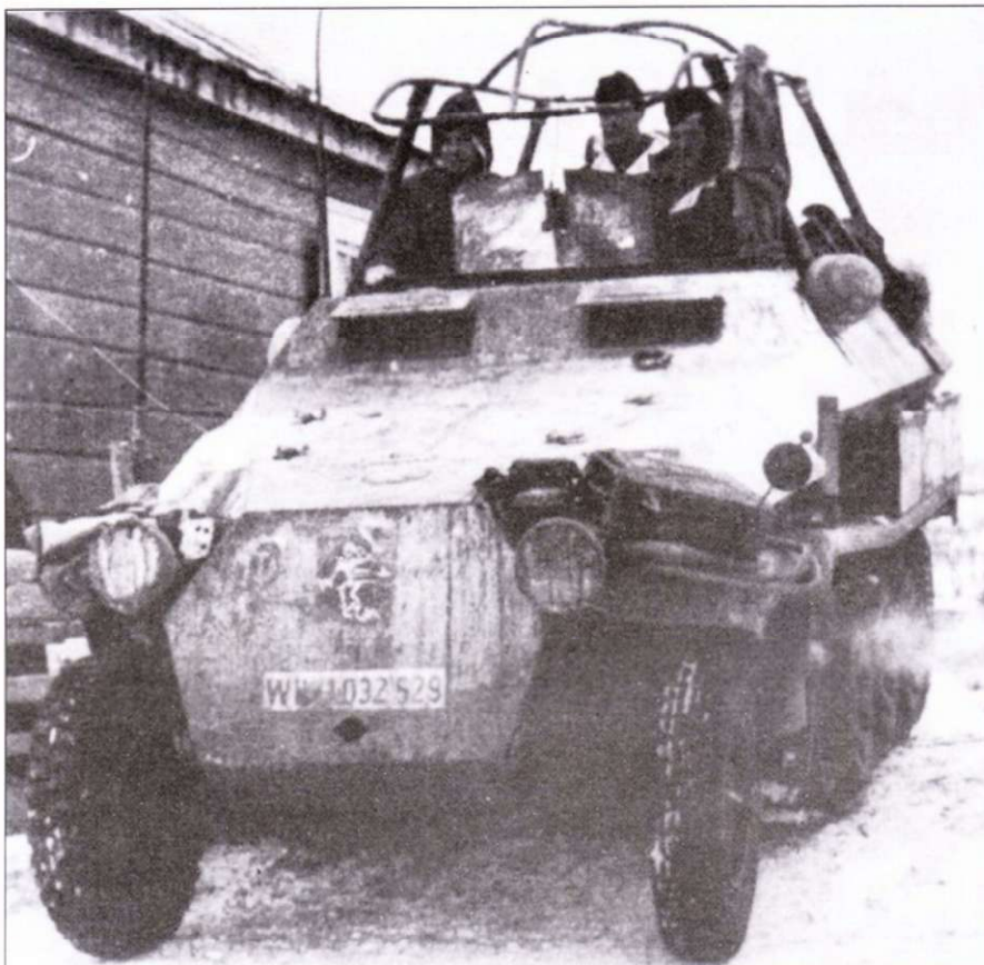
Командно-штабная машина Sd.Kfz. 251/6. Флажок черного, белого и красного цвета обозначает принадлежность машины штабу одной из дивизий корпуса Роммеля. Машина целиком окрашена в желто-коричневый цвет. Поверх рамной антенны натянут тент для защиты радиоаппаратуры и радистов от солнечных лучей. В задней части корпуса установлена дополнительная штыревая радиоантенна.
