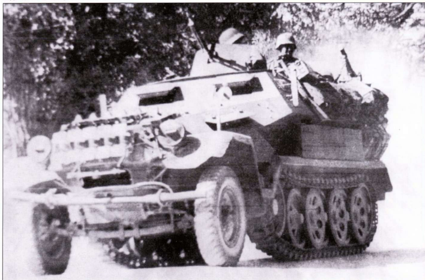
Бронетранспортер Sd.Kfz. 251/1 Ausf. B из 7-й танковой дивизии, Советский Союз, лето 1941 г. Машина увешана имуществом экипажа, на бортах для дополнительной защиты закреплены гусеничные траки.
