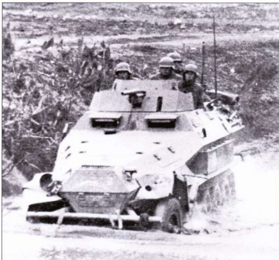
Бронетранспортер Sd.Kfz. 251/10 Ausf. A. Перед операцией «Барбаросса» дубовый лист 1-й танковой дивизии был заменен эмблемой в виде перевернутой литеры «У». Форма оружейного щита пушки Pak-36 - «промежуточная». Поначалу на машины монтировались орудия с полноценными орудийными щитами буксируемых пушек.
