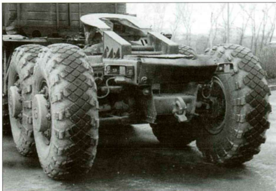
Задний мост и буксировочное устройство. Задний бампер имеет очень небольшие размеры.
