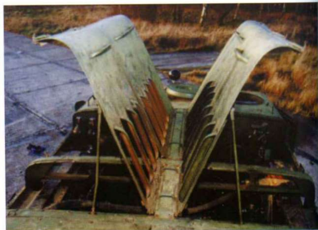
Заливочные горловины топливного бака расположены в задней части моторного отделения. В крыше кабины сделан круглый люк. Через открытый люк видна лебедка. На фото внизу открыты капоты двигателя.
