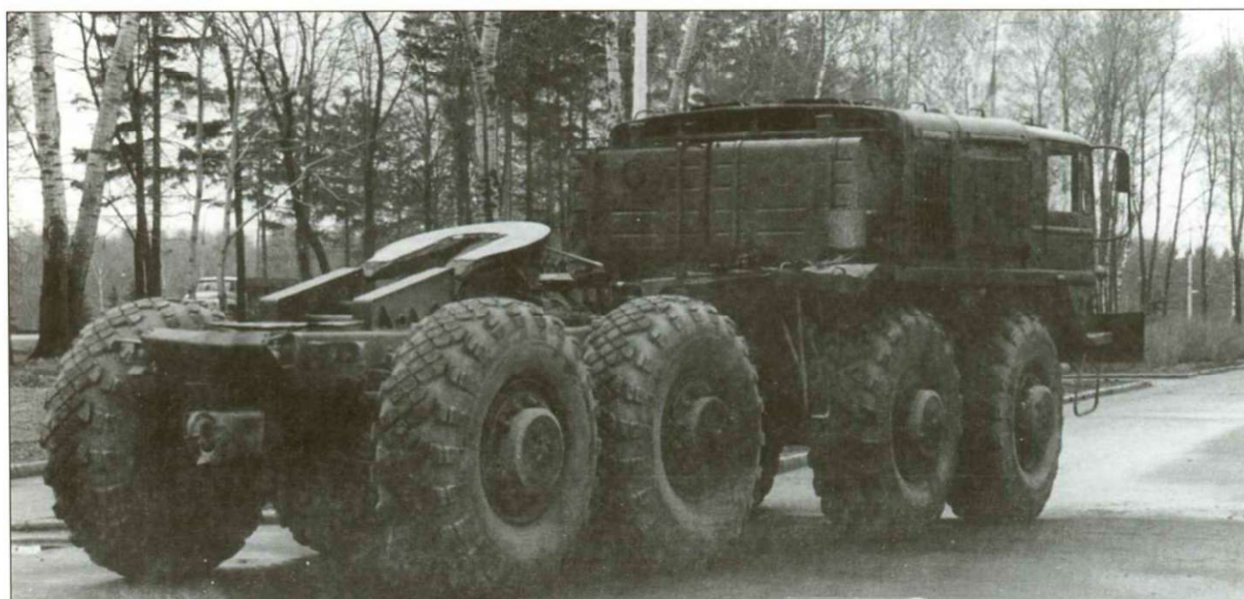
Задний мост и буксировочное устройство. Задний бампер имеет очень небольшие размеры.
