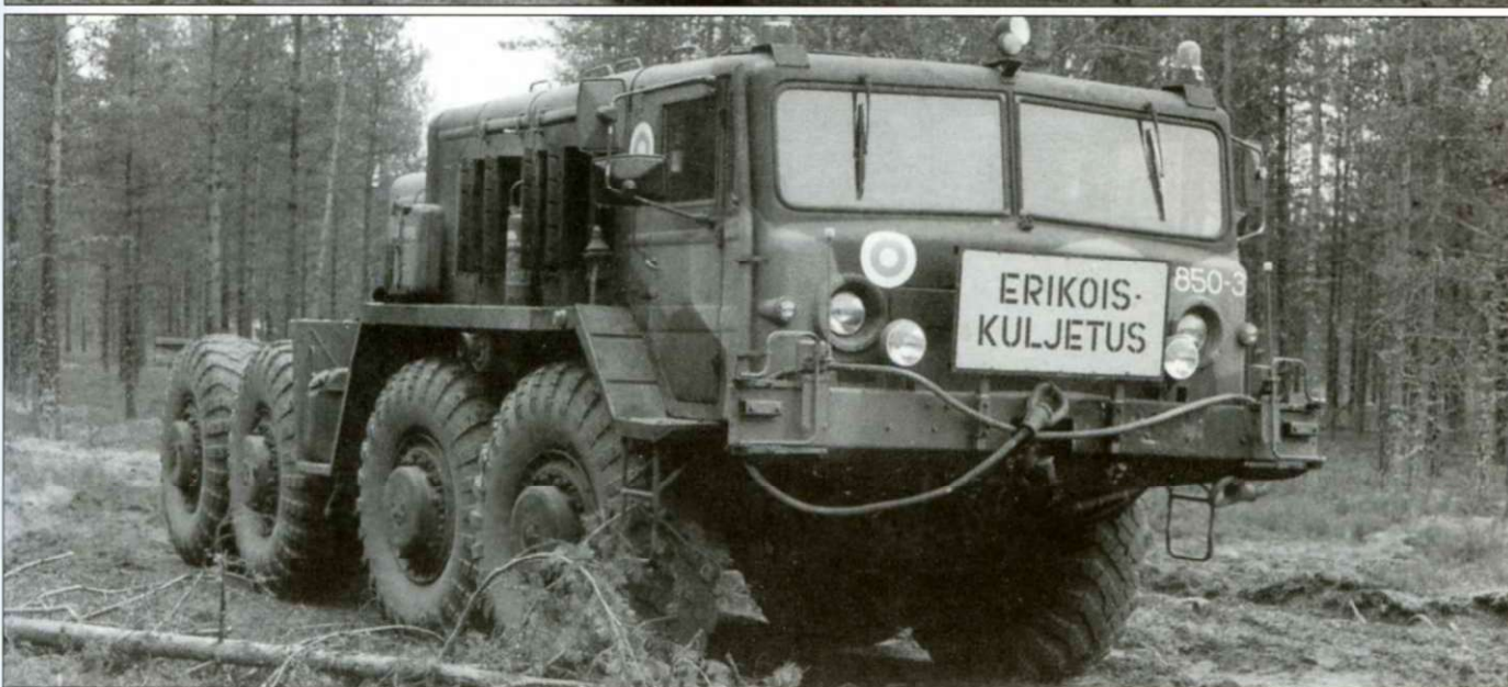
На фотографиях представлен тягач в типичном финском камуфляже с бело-голубыми опознавательными знаками армии Финляндии. Регистрационный номер написан краской белого цвета. На переднем бампере установлены дополнительные фары. На крыше кабины тягача финны смонтировали предупредительные световые маячки.
