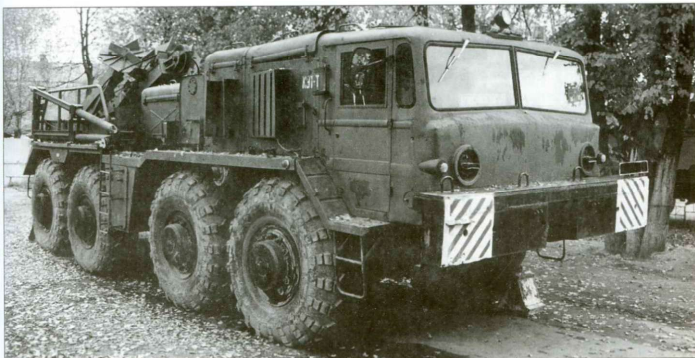
Тяжелая эвакуационная машина КЭТ-Т (Колесный Эвакуационный Тягач - Тяжелый). Такие тягачи поступали в подразделения, оснащенные обычными тягачами и полуприцепами, они предназначались для вытаскивания застрявших тягачей и буксировки поврежденной тяжелой техники.
