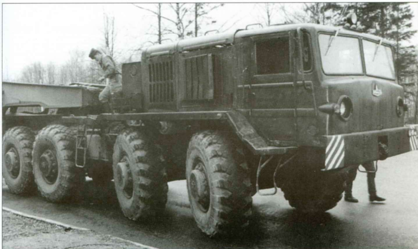
Фото позднего МАЗ-537, прекратили серийное производство танковых тягачей в начале 80-х годов. Внешне танковые тягачи полностью идентичны обычным машинам поздней постройки, единственное отличие - отсутствие кожуха двух топливных баков, баки установлены открыто, что хорошо видно на снимке. Снимки сделаны в Москве в середине 90-х годов. Тягачи с полуприцепами, в частности вывозили из Москвы бронетехнику после известных событий октября 1993 г. Обратите внимание на красно-белую маркировку оконечностей бампера.
