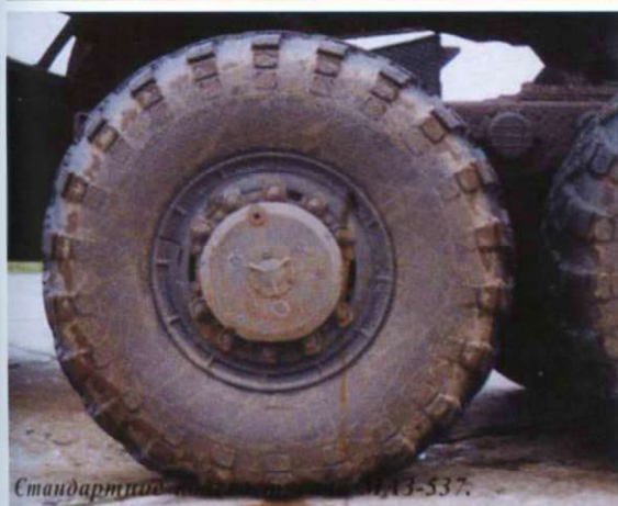
Задний мост, задние подфарники отсутствуют - их часто вообще не монтировали на многих тягачах постройки 50 - 80-х годов.
