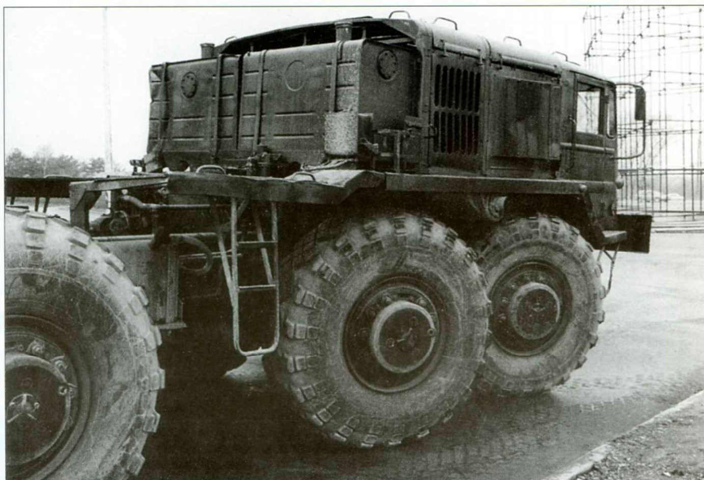
Фото позднего МАЗ-537, прекратили серийное производство танковых тягачей в начале 80-х годов. Внешне танковые тягачи полностью идентичны обычным машинам поздней постройки, единственное отличие - отсутствие кожуха двух топливных баков, баки установлены открыто, что хорошо видно на снимке. Снимки сделаны в Москве в середине 90-х годов. Тягачи с полуприцепами, в частности вывозили из Москвы бронетехнику после известных событий октября 1993 г. Обратите внимание на красно-белую маркировку оконечностей бампера.
