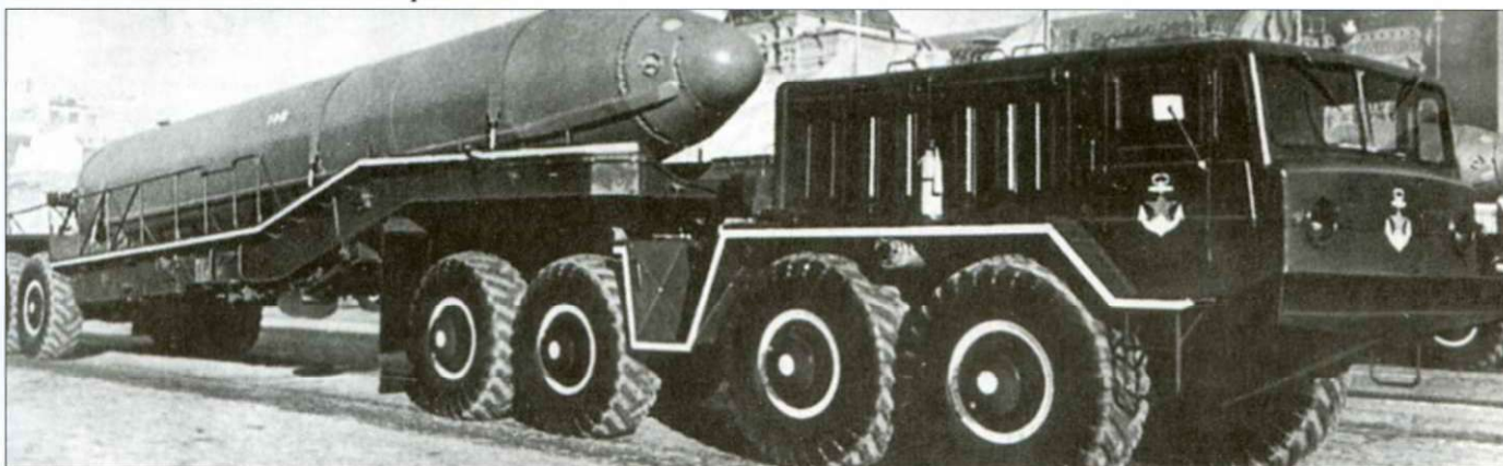
Тягач МАЗ-537 с полуприцепом, на который уложена морская баллистическая ракета РМС-40 «Высота» (SAWFLY, SS-N-8). Солветский ВМС обладал собственными тягачами, предназначенными для перевозки собственных баллистических ракет. На дверь кабины тягача нанесена типично морская эмблема в виде сочетания якоря с пятиконечной звездой красного цвета. «Парадные» машины часто получали белую обводку.
