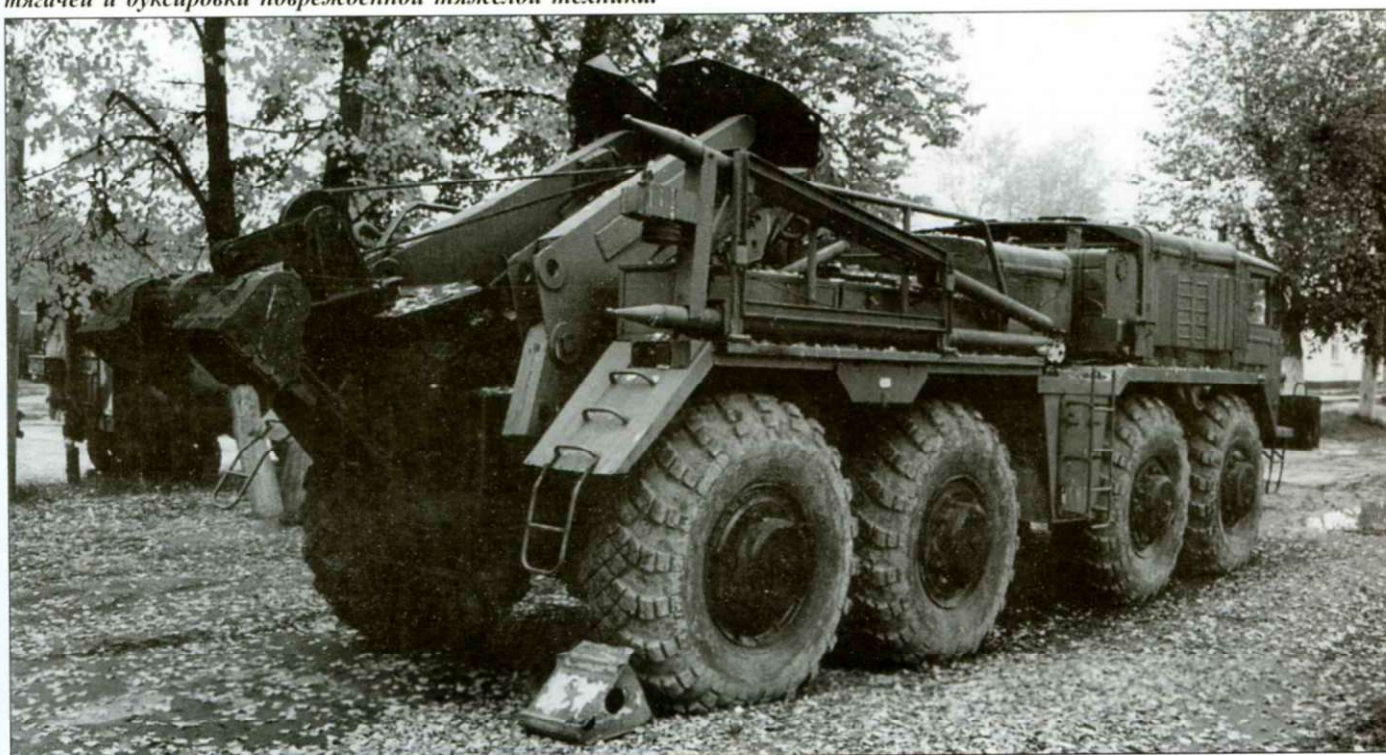
Тяжелая эвакуационная машина КЭТ-Т (Колесный Эвакуационный Тягач - Тяжелый). Такие тягачи поступали в подразделения, оснащенные обычными тягачами и полуприцепами, они предназначались для вытаскивания застрявших тягачей и буксировки поврежденной тяжелой техники.
