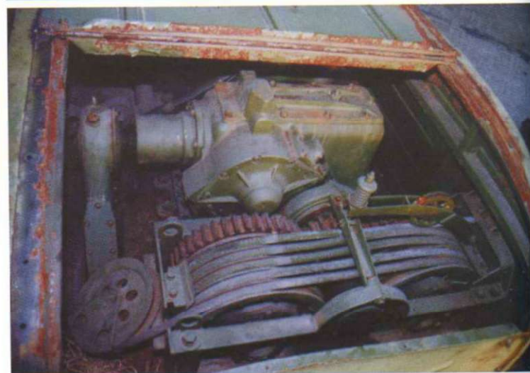
Заливочные горловины топливного бака расположены в задней части моторного отделения. В крыше кабины сделан круглый люк. Через открытый люк видна лебедка. На фото внизу открыты капоты двигателя.
