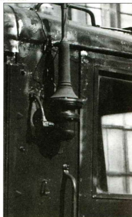
Тягач оснащен радиостанцией, антенный ввод смонтирован с левой стороны кабины.
