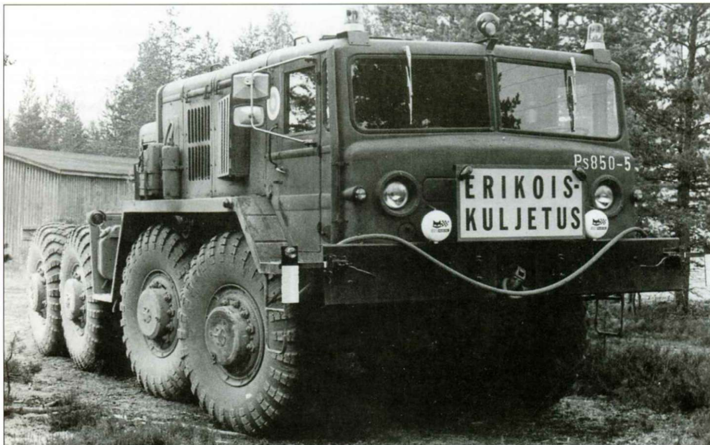
Финский тягач МА3-537. Машина сочетает внешние отличия тягачей средней и поздней постройки. Финны ставили на свои тягачи дополнительные фары и световые маячки. Обратите внимание на дизайн зеркал заднего вида.
