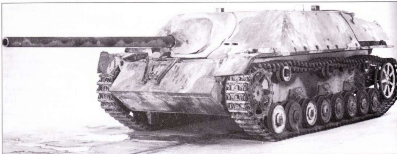
Jagdpanzer IV/70(V) поздней серии. Цельнометаллические опорные катки на передней колесной тележке, три цельнометаллических поддерживающих катка, выхлопная система аналогична системе танка PzKpfw IV Ausf. J.
