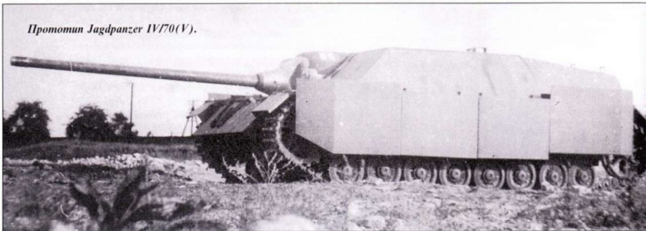
Прототип Jagdpanzer IV/70(V) с установленным на крыше дистанционно управляемым пулеметом.
