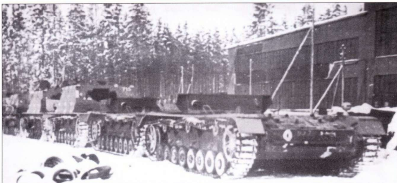
Jagdpanzer IV/70(A), подготовленные к установке вооружения, завод Nibelungen Werke, зима 1944/45 г.г. На переднем плане два шасси танка PzKpfw IV, подготовленные к переделке.
