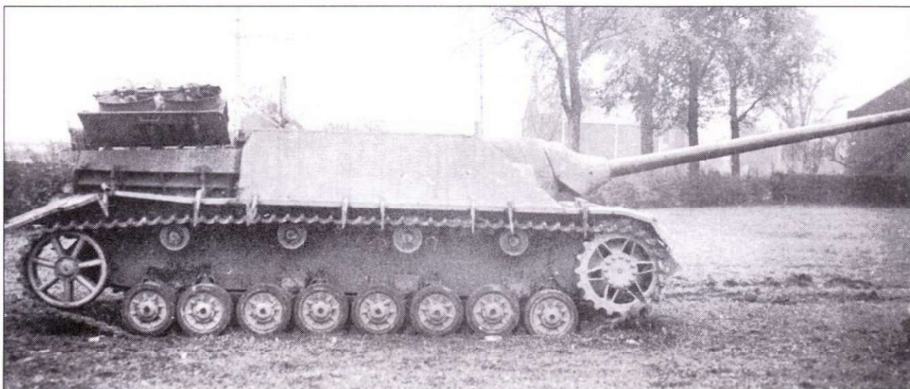
Jagdpanzer IV/70(V) ранней серии с обрезиненными опорными катками. Машина покрыта слоем циммерита.
