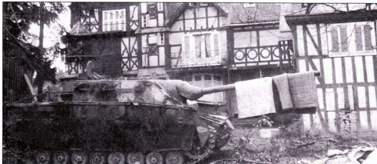
Брошенный Jagdpanzer IV/70(A) используется местными жителями в хозяйстве, Германия, март 1945 г. У машины четыре опорных катка с внутренней амортизацией.
