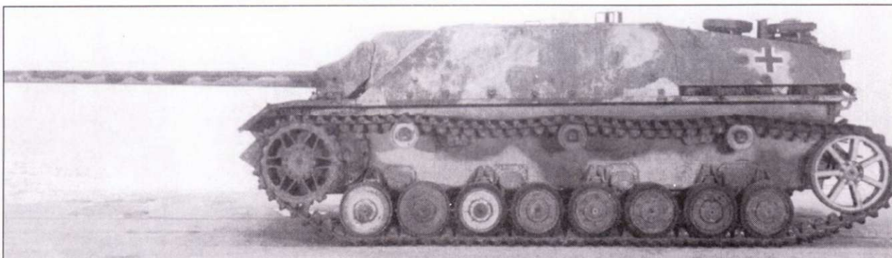
Jagdpanzer IV/70(V) ранней серии с обрезиненными опорными катками. Машина покрыта слоем циммерита.
