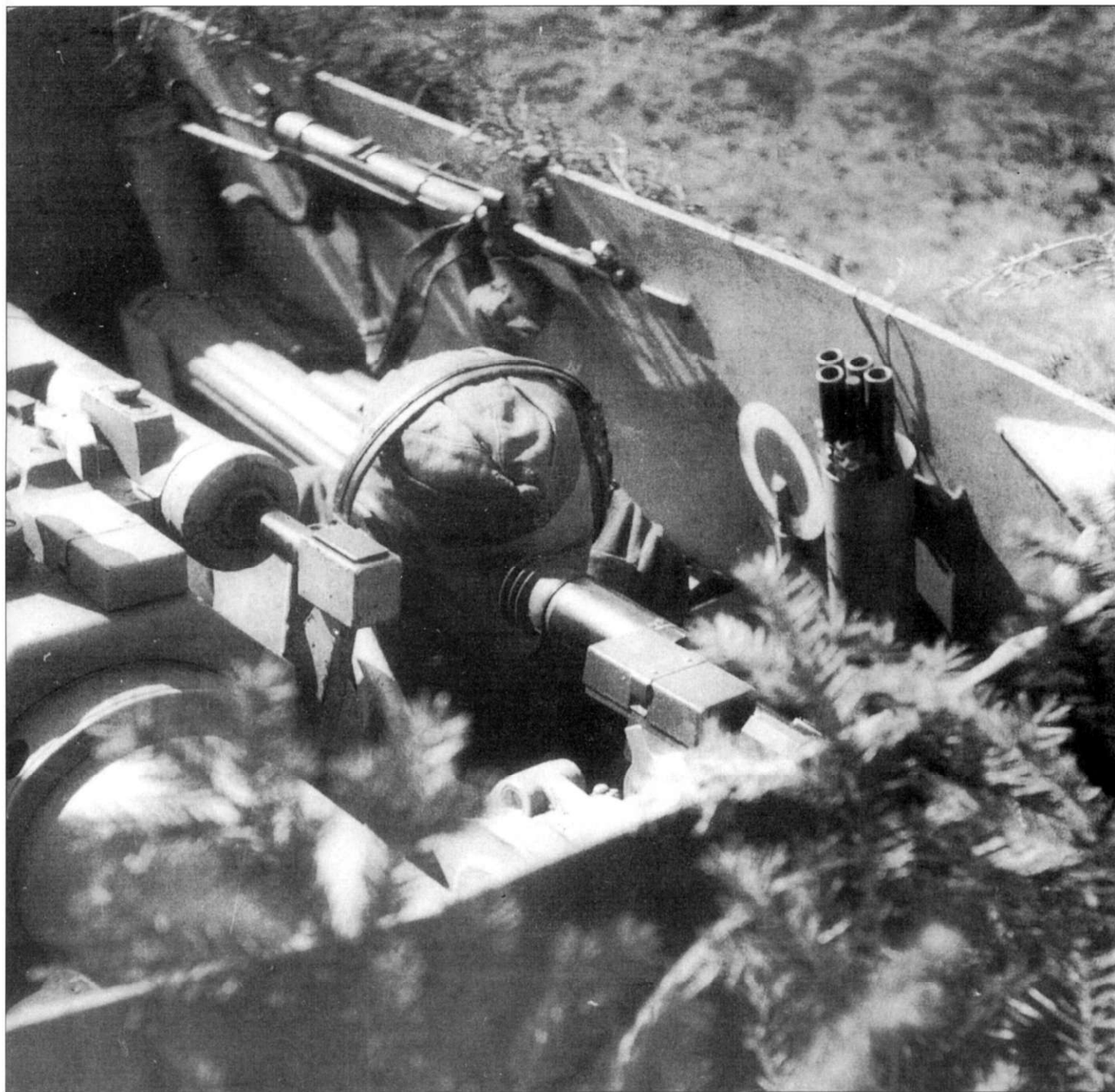
Противотанковая самоходно-артиллерийская установка 7,5 см PaK-40/1 L/46 auf Panzerjäger LrS (f) Sd.Kfz. 135 «Мардер I», 1943 г. Наводчик занимает пространство в левой части рубки.
