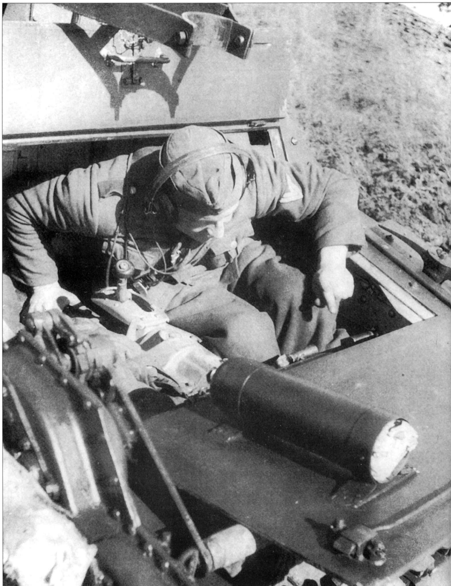
Механик-водитель противотанковой самоходно-артиллерийской установки 7,5 см PaK-40/1 L/46 auf Panzerjäger LrS (f) Sd.Kfz. 135 «Мардер I», 1943 г. Хорошо видна обратная сторона люка механика-водителя.
