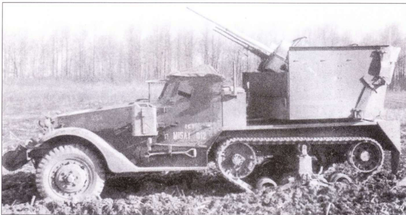
Большинство самоходок М15 прошло модернизацию до уровня М15А1 путем установки более совершенной системы управления огнем, усиления конструкции шасси и переносом пулеметов под пушку. Верхние части передних бронешитов рубки выполнили откидными для улучшения расчета обзора вперед. М15А1 стал самым массовым из трех вариантов зенитной пулеметно-пушечной самоходной установки: таких машин было построено с октября 1943 г. по февраль 1944 г. более 1600 штук.
