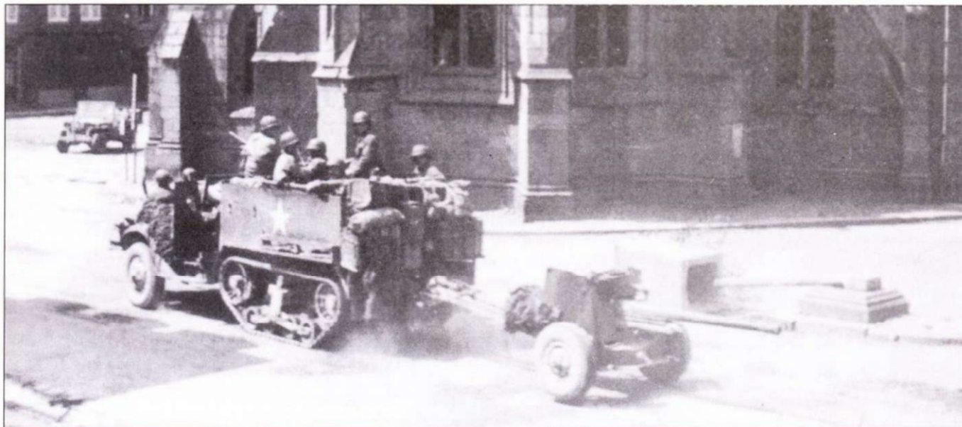
Бронетранспортер М2 с 57-мм противотанковой пушкой на прицепе на улице французского города, операция «Кобра», июль 1944 г. Ключом к успеху союзников во Франции стала высокая подвижность мото-механизированных частей. Пехота всегда поддерживала действия танков.
