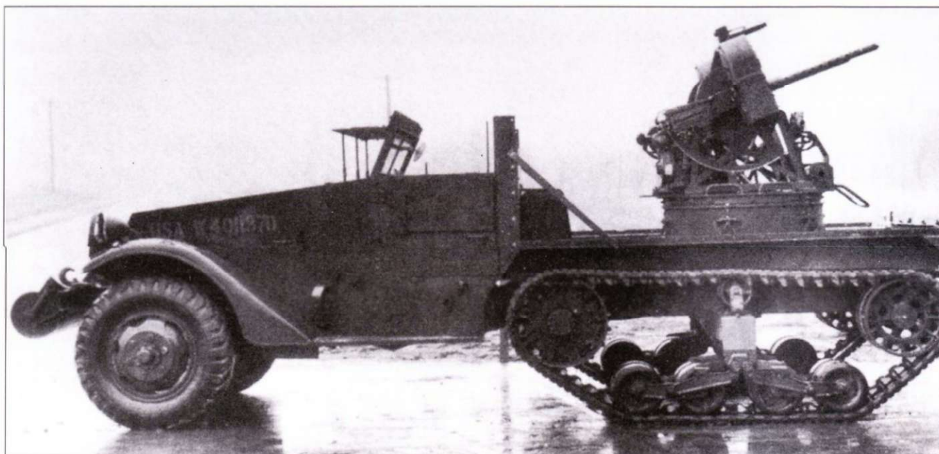
Самоходка T1E2 представляла собой комбинацию шасси бронетранспортера M2 с вооруженной парой 12,7-мм пулеметов турелью Максон и установленной в центре кузова. Турель имела собственный электрогенератор для питания электроприводов наведения пулеметов в вертикальной и горизонтальной плоскостях. Турель обозначалась M33.
