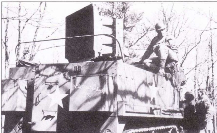
Интересная конверсия бронетранспортера М3 - в кузове установлен громкоговоритель, посредством которого германских солдат агитировали сдаваться в плен. На крышке кузова сидит диктор, вещающий о прелестях американского, самого свободного в мире, плена в микрофон.
