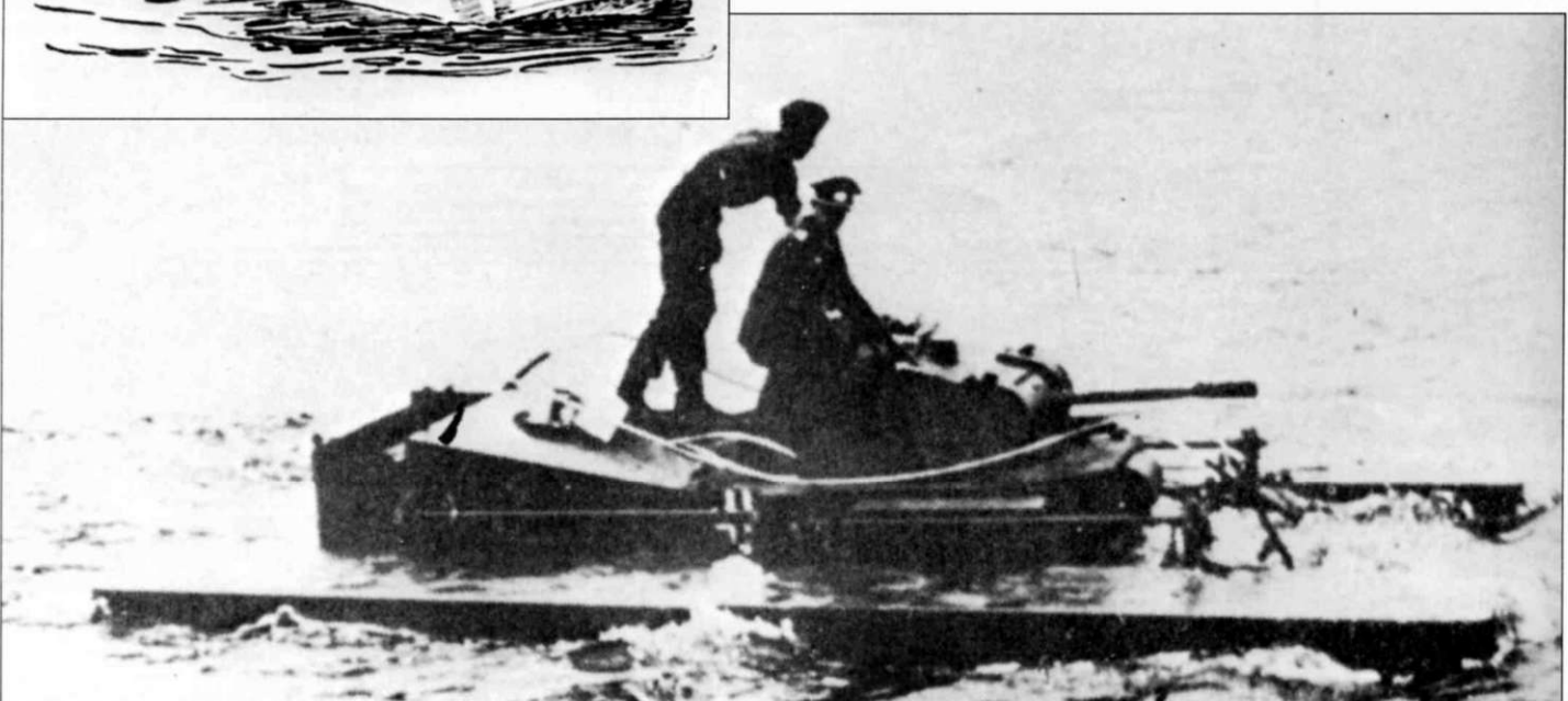
Испытания на плавучесть PzKpfw II Ausf. С с понтонами фирмы «Заксенберг»
