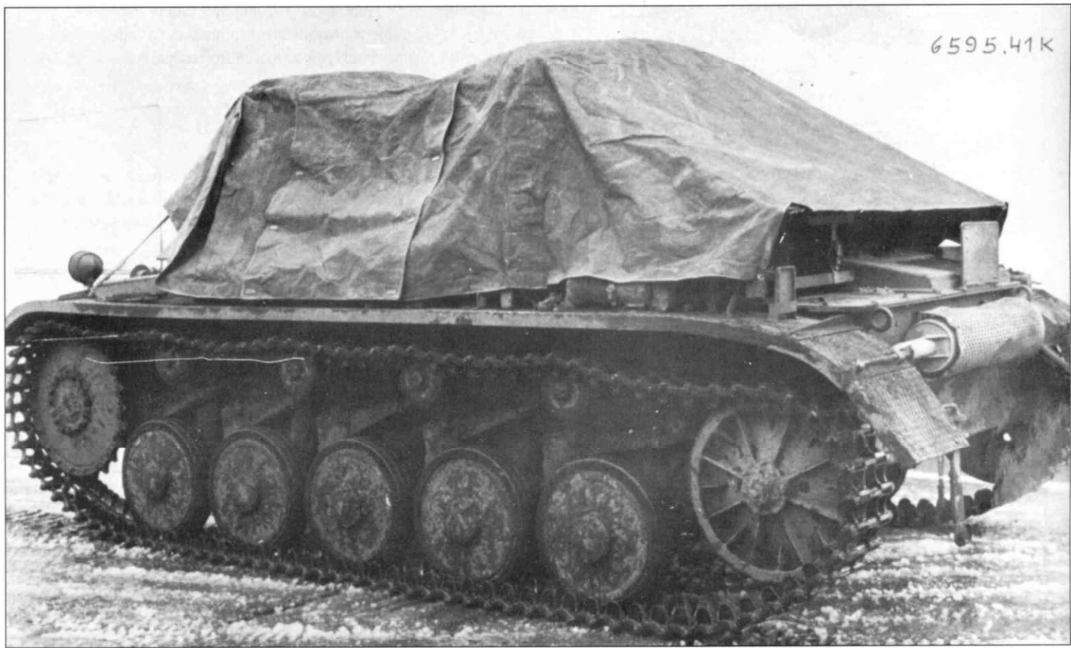
Импровизированная инженерная машина на базе PzKpfw II Ausf. C - Pionier Kampfswagen II. Башня демонтирована.
