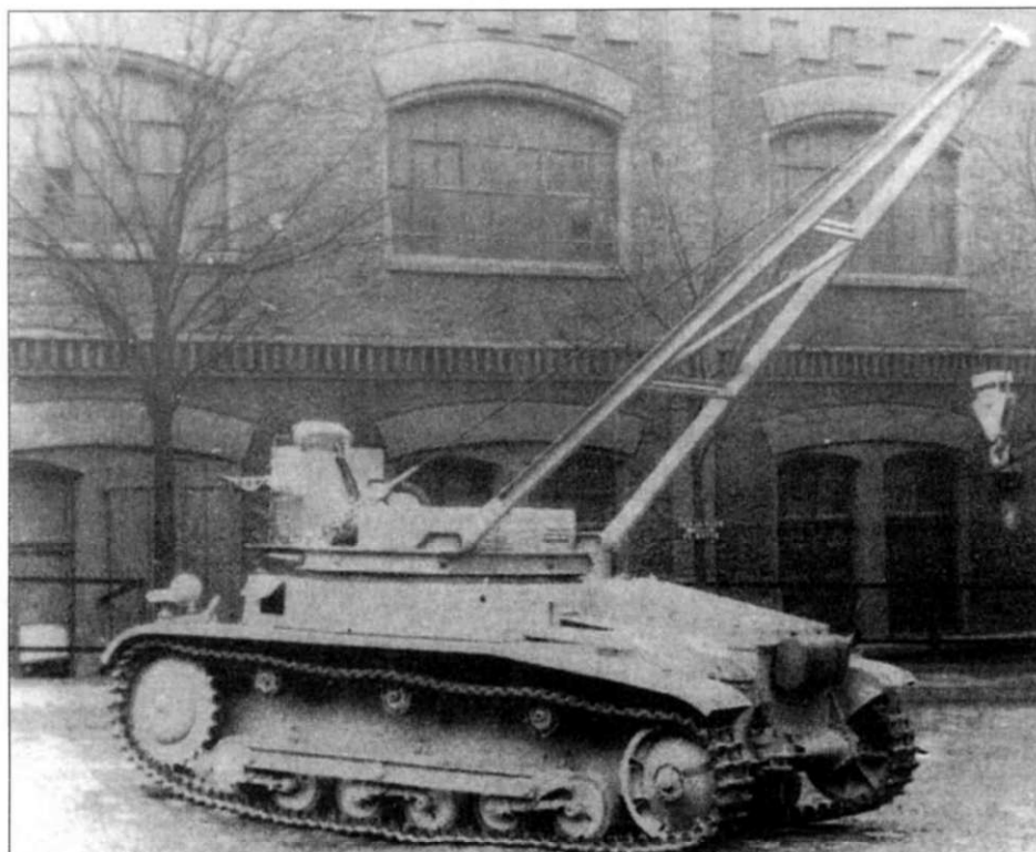
Импровизированная ремонтная машина на базе PzKpfw II Ausf. b.
