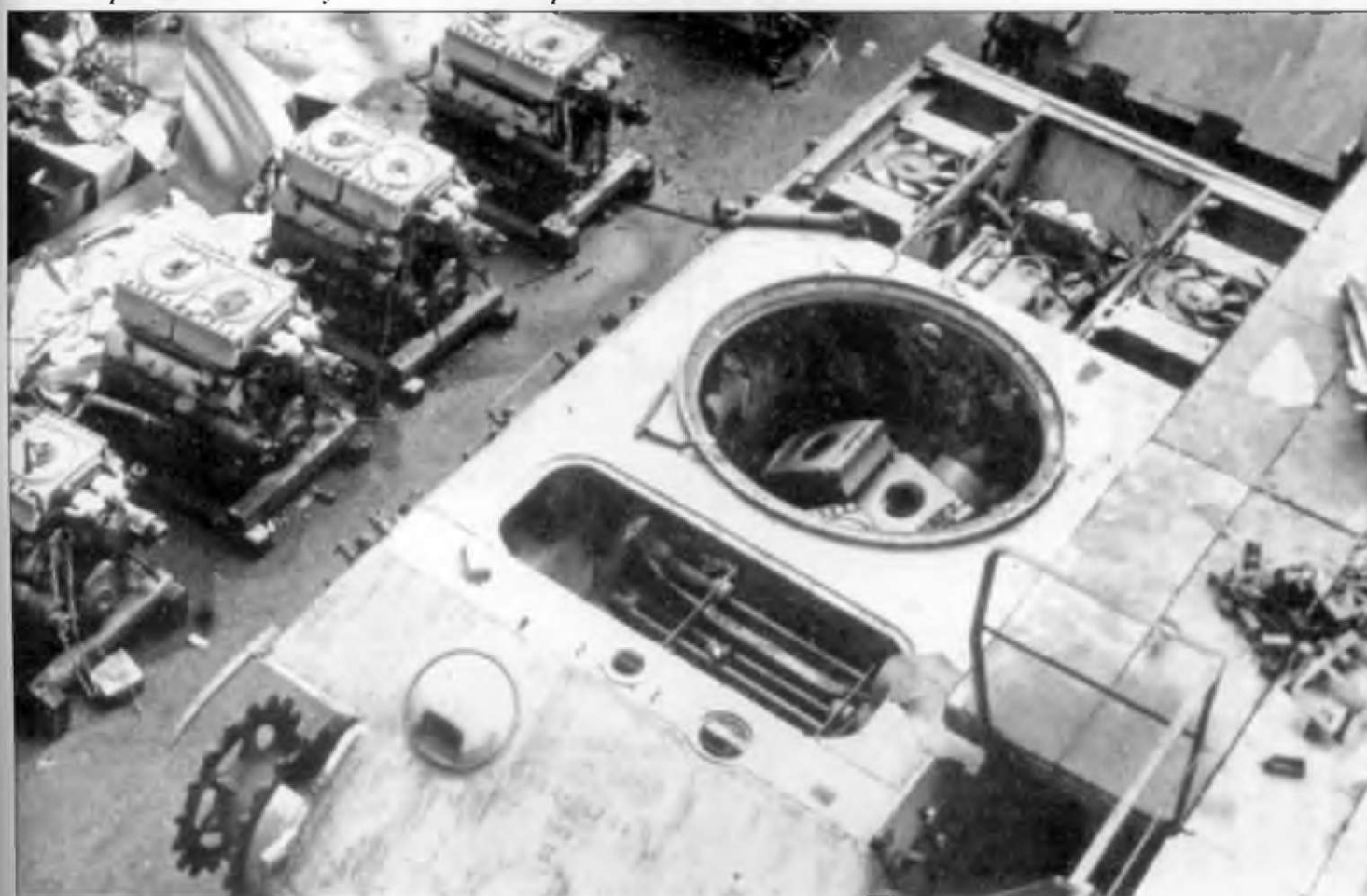
Шасси танка «Пантера» в сборочном цеху завода фирмы MNH, цилиндрические контейнеры по-прежнему ставятся на борт корпуса. Корпус № 217960 бвх изготовлен фирмой Рурсталь с цилиндрическим дождевым ограждением вокруг вентиляционного отверстия в надстройке.
