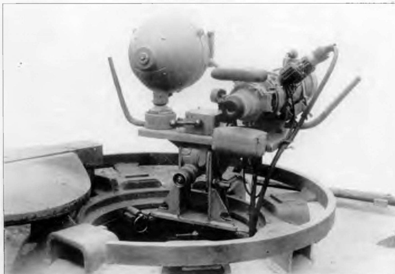
Инфракрасный прицел и командирский наблюдательный прибор для танка «Пантера» - Ziel- und Kommandanten-Optik fuer Panther. Устройства смонтированы на командирской башенке. ИК оборудование механически связано с индикатором, который позволяет наводчику устанавливать орудие согласованно с ИК системой ночного видения.
