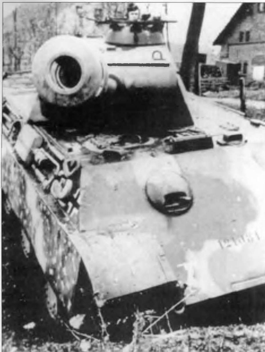
Танк «Пантера» Ausf. G (Fgst.Nr. 121081 сборки фирмы MAN примерно 28 сентября 1944 г.) с нормальными опорными катками и основанием для устройства Orterkompass , приваренным к крыше башни.
