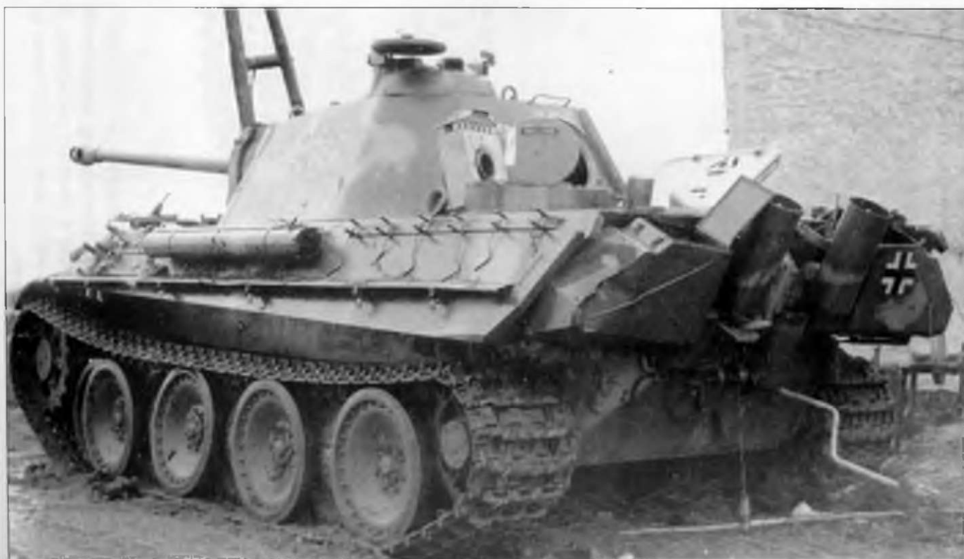
Танк «Пантера» Ausf. G (тактический номер «301») с «паодобородочной» маской пушки (021 St 50258), пламегасителями Flammvernichter на выхлопных патрубках и большими самоочищающимися ленивцами диаметром 660 мм.
