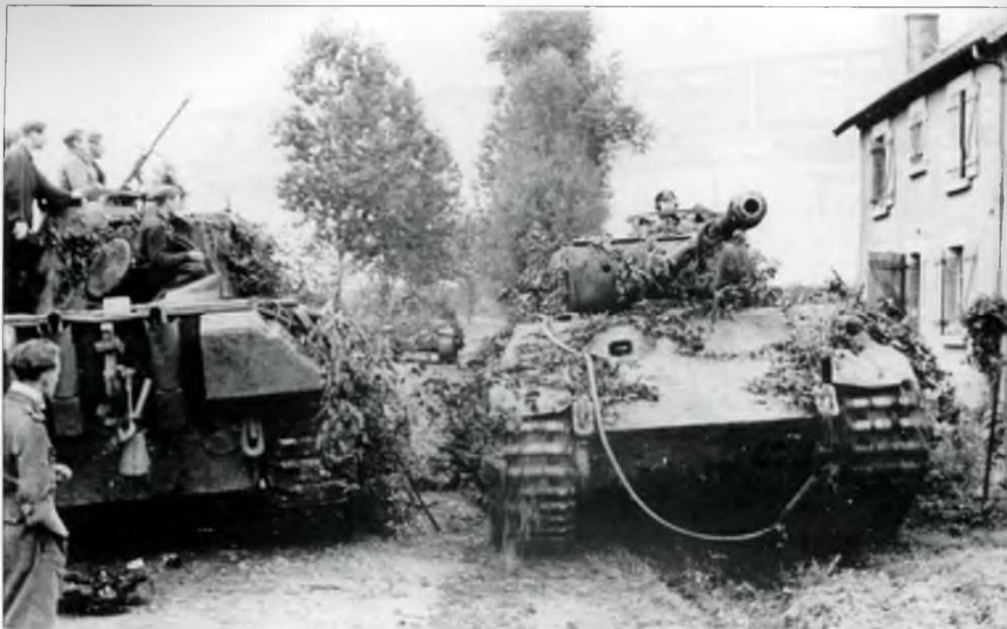
«Пантера» Ausf. G (справа) оснащена гусеницами, набранными из траков без шевронов Gleitschuetzpickeln.
