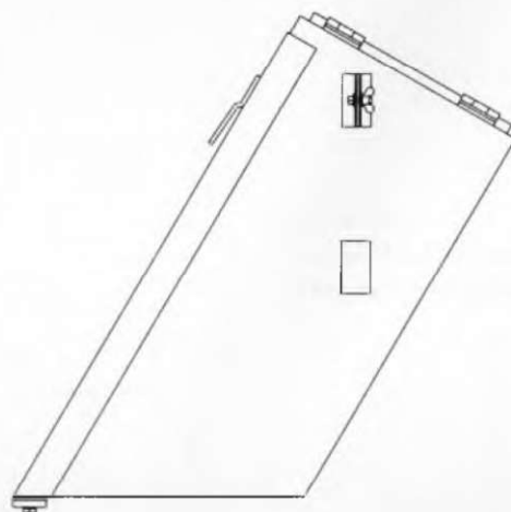
Цилиндрические крепления шестов для наращивания Sternantenna на левой стенке правого заднего багажника.
