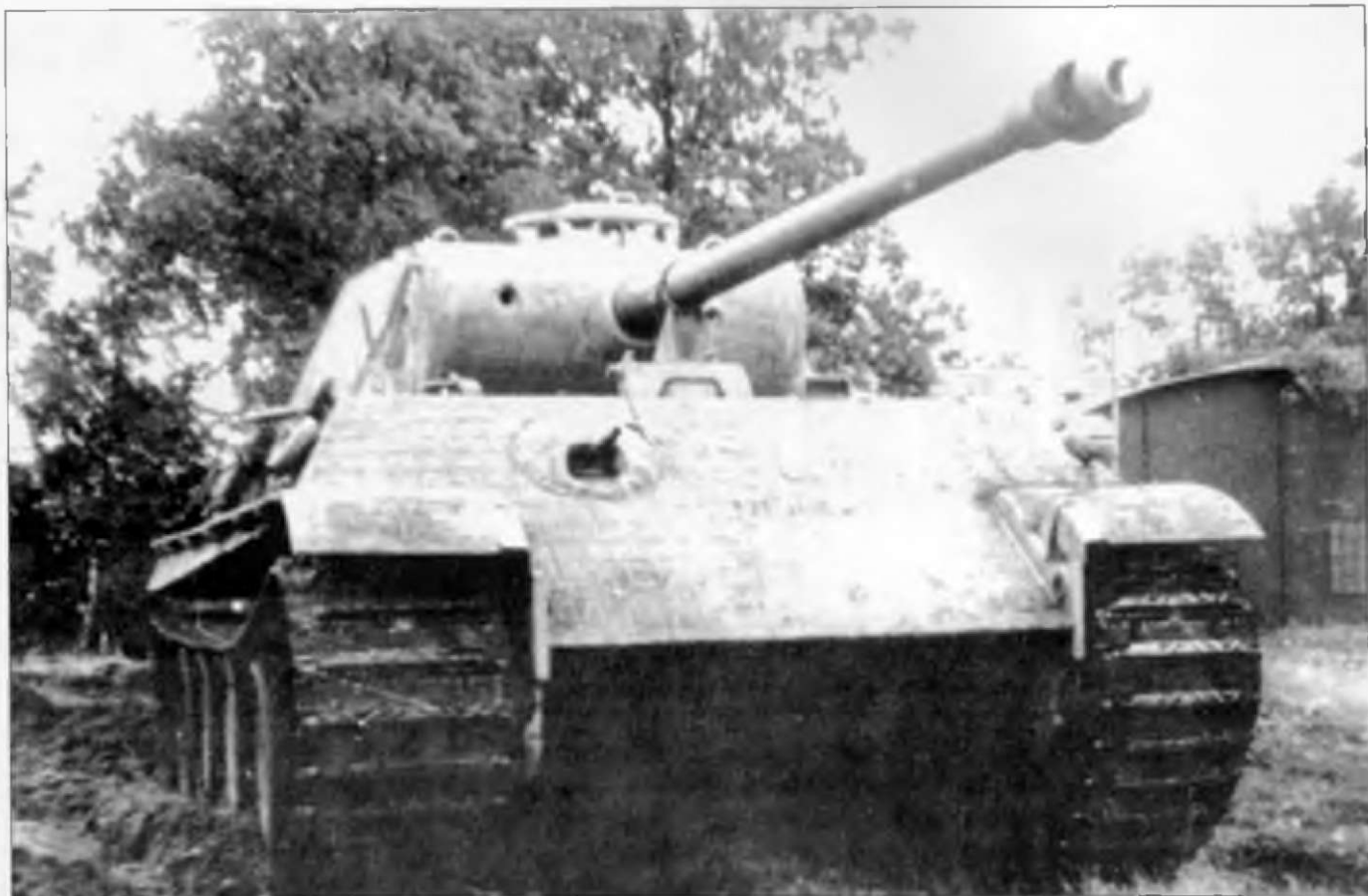
Вверху и справа: танк «Пантера» Ausf. G (Fgst.Nr. 120303) сборки фирмы MAN примерно первых чисел апреля 1944 г. и имеет ручек или ступоры откинутого положения крышек люков механика-водителя и стрелка-радиста. В верхней части лобового листа корпуса сделан вырез под сектор обзора поворотного перископа механика-водителя. В крышке вентиляционного отверстия на крыше корпуса отсутствует выемка под опущенный фиксатор ствола орудия.
