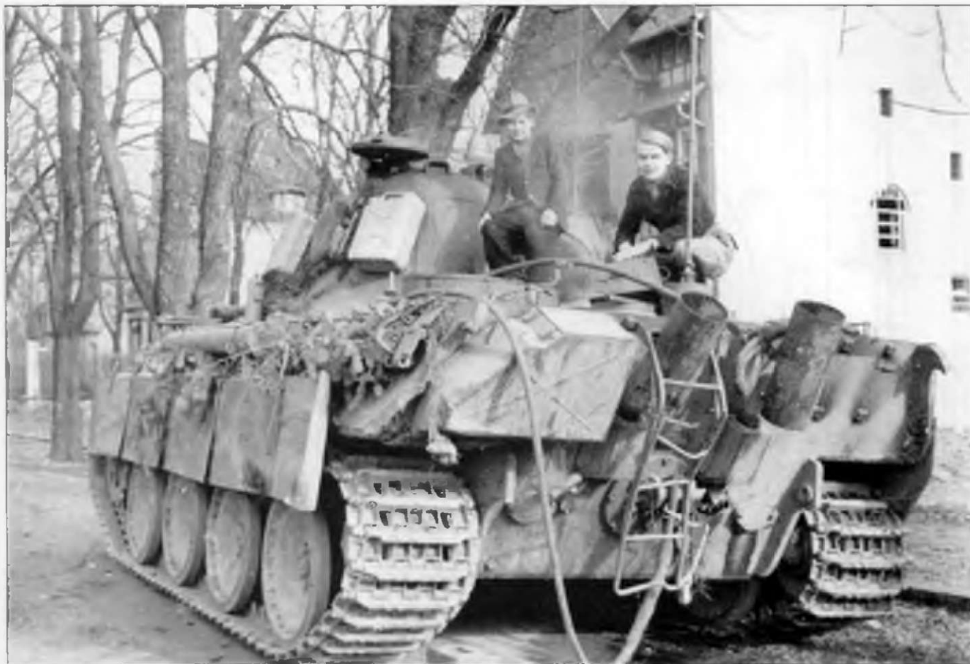
Командирский танк Pz.Bf.Wg. сборки фирмы MAN января 1945 г. В правой части кормы устроены крепления бронекоробки под ИК оборудование. К стенкам башни приварены петли.
