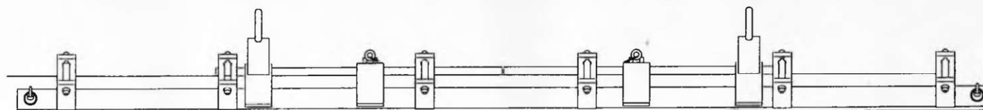
Крепления запасных траков на правом борту с U-образными креплениями для 2-метрового лома
