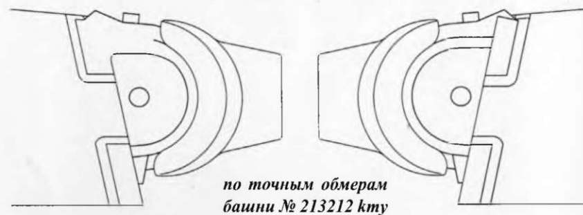
Сравнение лобовых литых деталей башен танков «пантера» Ausf. D (вверху) и Ausf. A (внизу)
