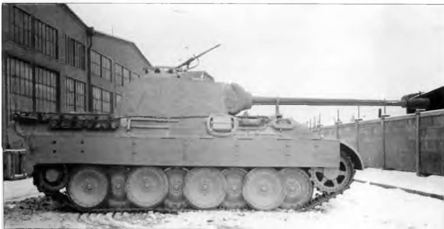
Танк Pz.Kpfw. Panther Ausf. A сборки MAN февраля 1944 г. с вертикально установленным домкратом и двумя патрубками для охлаждения левого выхлопного патрубка двигателя. Внешние опорные катки - с 16 болтами, усиленными 16 заклепками.
