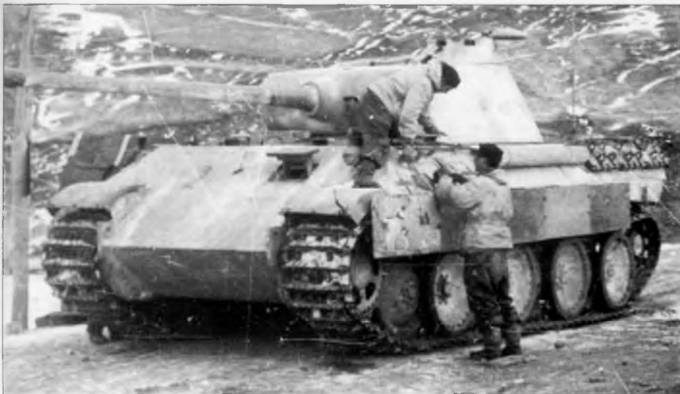
Танк «Пантера» Ausf. A сборки фирмы Даймлер-Бенц конца сентября - начала октября 1943 г., машина не имеет циммеритного покрытия. Установлен бинокулярный прицел TZF-12, в бортах и корме башни имеются pistolетные амбразуры, в лобовом листе корпуса сделана амбразура для стрельбы из пулемета. На ограждения перископов командирской башенки приварена кольцевая турель под зенитный пулемет. Все видимые на снимке опорные катки - усиленного типа, с 24 болтами.
