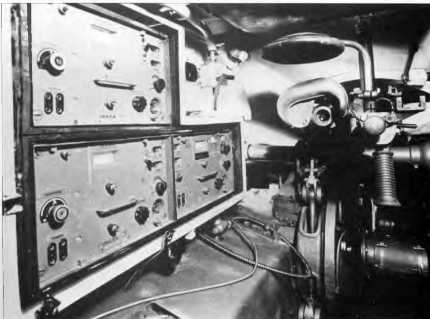
Интерьер танка Pz.Kpfw. Panther Ausf. A (Fgst.Nr. 21055(?)) сборки фирмы MAN декабря 1943 г.) с курсовым пулеметом MG34 в шаровой установке, установлены радиостанции Fu-5 и Fu-2.
