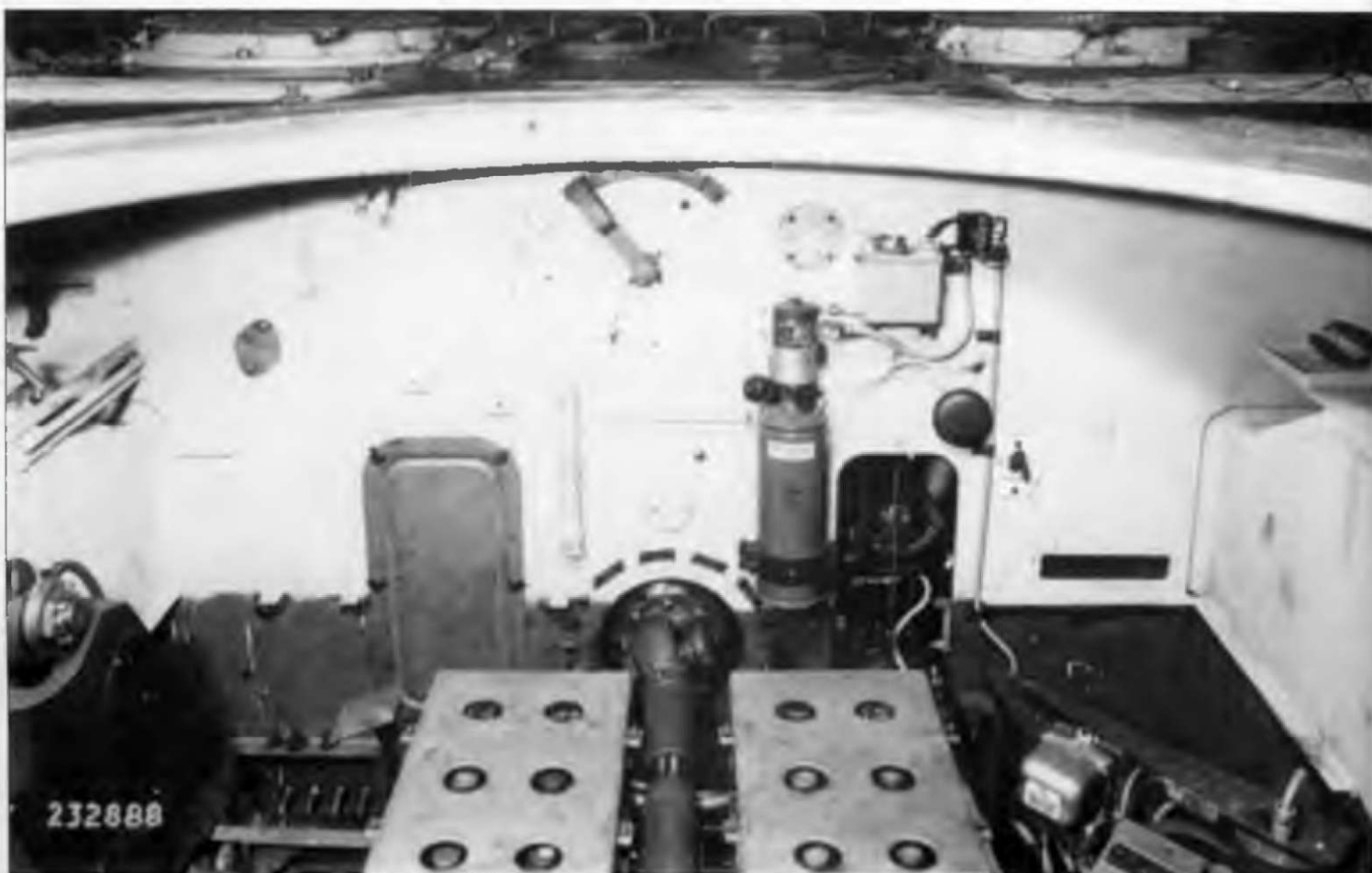
Противопожарная перегородка на частично собранном шасси командирского танка Pz.Bef.Wg. Panther Ausf. A.
