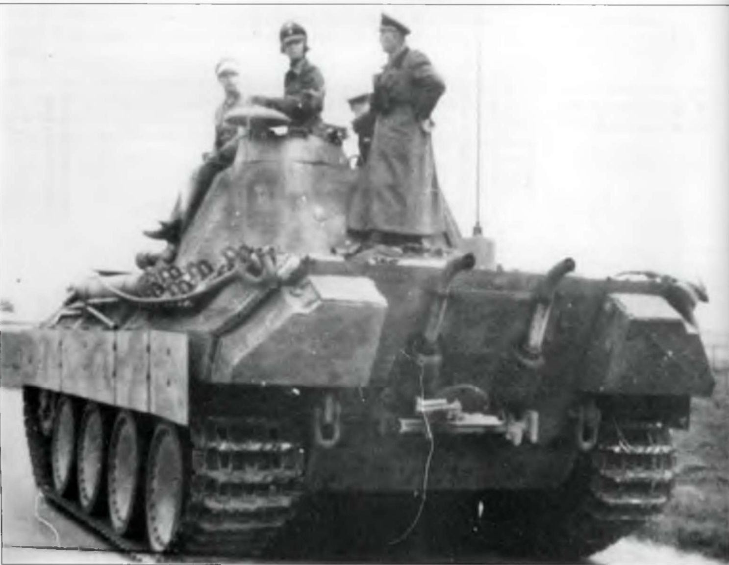
Командирский танк Pz.Bef.Wg. Panther Ausf. A сборки фирмы MAN, танк все еще оборудован пулеметными амбразурами в башне. На внутренней стенке правого кормового багажного ящика установлены цилиндрические крепления шестов для увеличения высоты радиомачты Sternantenna.
