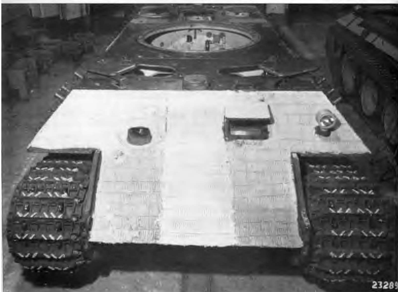
Крыша моторного отделения (вверху) и лоб корпуса (внизу) командирского танка Pz.Bef.Wg. Panther Ausf. A (Fgst.Nr. 210651) сборки фирмы MAN января 1944 г. В задней части крыши моторного отделения смонтирован броневод радиопередатчика Sternantenna.
