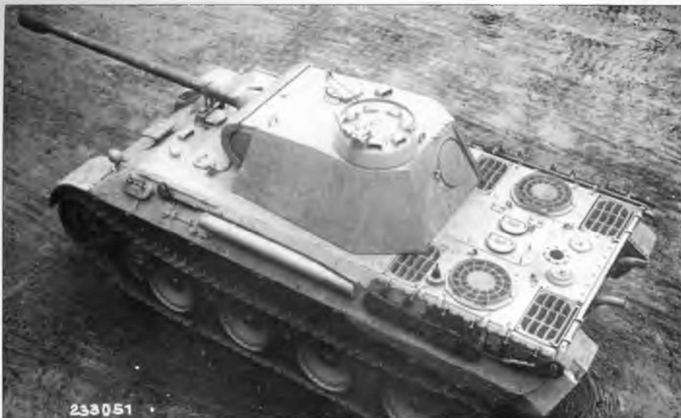
Танк Pz.Kpfw. Panther Ausf. A сборки MAN января 1944 г. Пушечные амбразуры в стенках башни отсутствуют. В крыше башни не видно отверстия под гранатомет Nahverteidigungswaffe. Бронекорчаки вентиляторов отлиты в варианте со «спиральными» ребрами.
